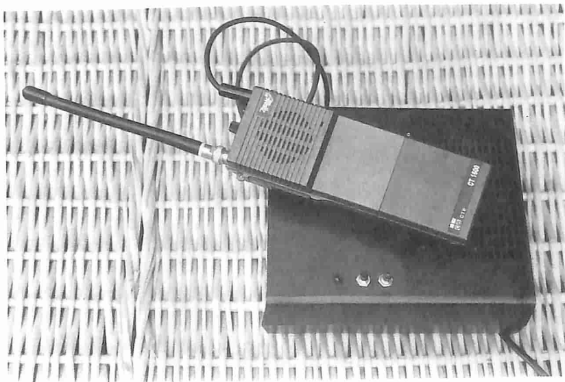
Un altro RTX riceve e demodula il segnale del trasmettitore, e lo invia all'unità ricevente (foto qui sopra) distinguendo quello di allarme da quello di integrità del collegamento radio.
