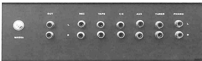
Il pannello posteriore: isolare le boccole d'uscita dalla carcassa del mobile. Utilizzare per quanto possibile fili schermati per evitare noise fastidiosi.
