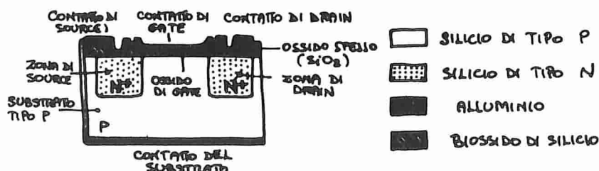
Tecnologia di un MOSFET. Il gate è isolato dagli altri terminali.
