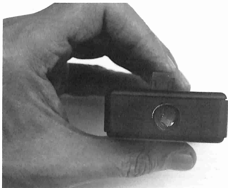
Le dimensioni del trasmettitore sono particolarmente ridotte. Nell'immagine si può osservare il foro praticato nel contenitore in corrispondenza della capsula trasmittente.
