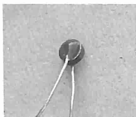
Il componente NTC utilizzato e traccia rame dello stampato.
