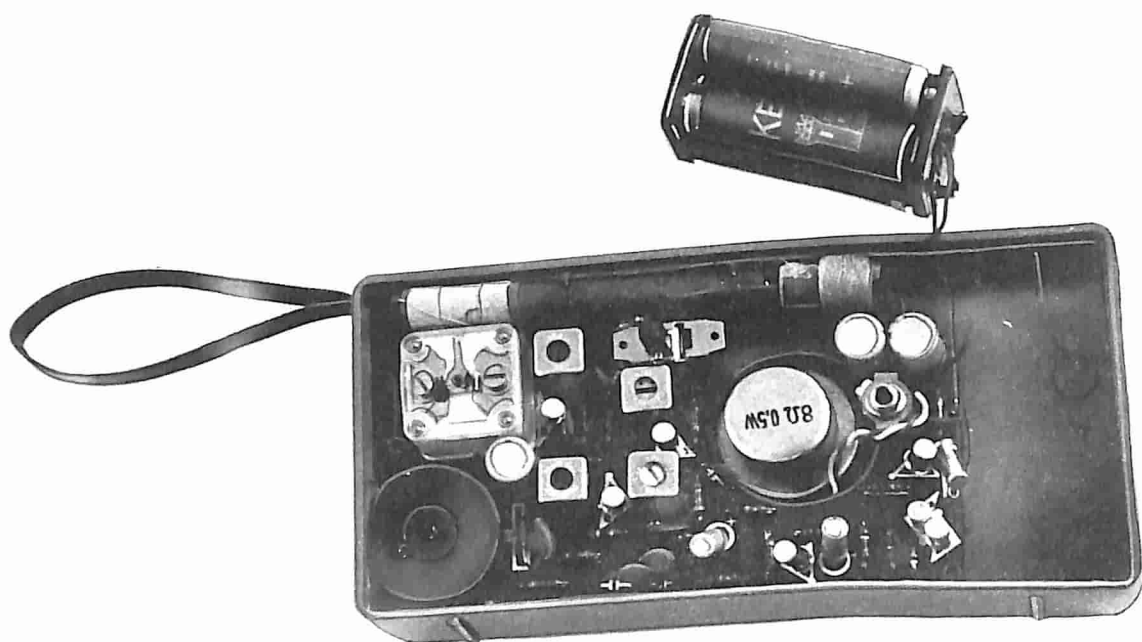
Fig. 5 - Ai lettori principianti raccomandiamo di non commettere errori di polarità all'atto dell'inserimento delle pile nel contenitore. Lungo l'asse centrale del contenitore sono riportati i segni che caratterizzano le tensioni positive e quelle negative; in ogni caso occorre tener presente che il polo negativo della pila deve formare contatto con la lamella flessibile, mentre il polo positivo deve formare contatto elettrico con la lamella rigida.
