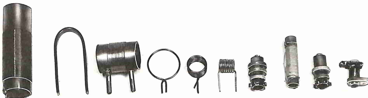
Fig. 2 - Le bobine possono essere diversamente costruite. Come si vede in questa foto, pur rimanendo fermo il concetto dell'avvolgimento del filo conduttore, le bobine assumono aspetti esteriori diversi, per la forma e per la grandezza.
