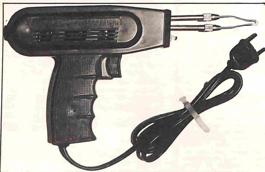
è di tipo con impugnatura a revolver; è dotato di trasformatore di alimentatore incorporato che, oltre ad isolare l'utensile dalla rete, permette di alimentarlo con tutte le tensioni di rete più comuni tramite commutazione del cambiotensione. Sulla parte anteriore è applicata una piccola lampada-riflettore, che proietta un fascio di luce sul punto in cui si lavora. La sua potenza è di 90 W.
