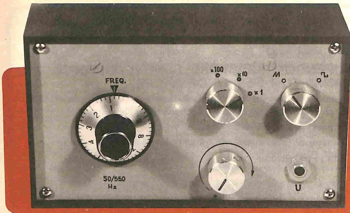
**Questo apparato, che completa il laboratorio del dilettante elettronico, serve per le operazioni di messa a punto e taratura, per la verifica e per la riparazione di radioapparati, per il controllo delle bande passanti dei filtri amplificatori, degli attenuatori, degli amplificatori non lineari, per l'analisi di segnali BF sconosciuti, per il controllo e la verifica di oscilloscopi, frequenzimetri e distorsionometri.**
