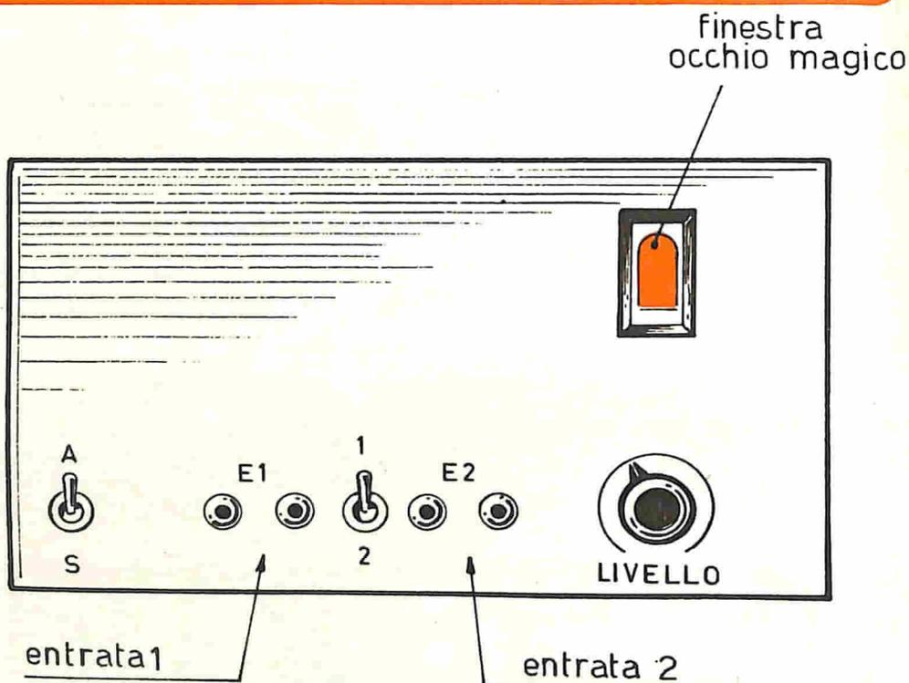
Fig. 4 — L'interruttore, il commutatore e il regolatore di sensibilità (livello), rappresentano gli unici elementi di comando del circuito del dispositivo. Sul pannello frontale sono anche presenti: le boccole relative alle due entrate e la finestra su cui si affaccia la parte luminosa dell'occhio magico.
