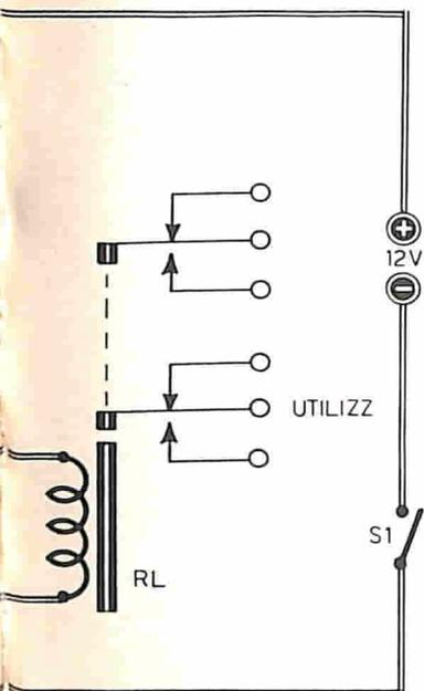
**Fig. 1** — Il principio di funzionamento di questo progetto è basato sulle variazioni della costante dielettrica che si può verificare nel condensatore composto dalla piastra sensibile e dalla terra. Ogni eventuale variazione di questo tipo fa scattare il relé il quale, a sua volta, mette in azione un qualsiasi dispositivo di allarme.
