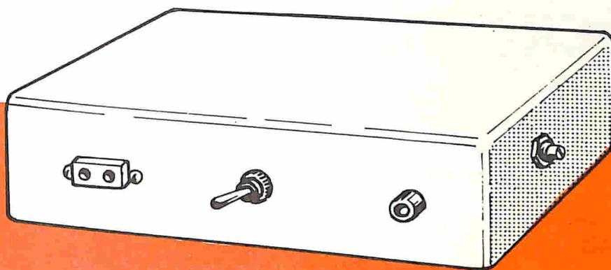
Fig. 5 — Sulla parte esterna del contenitore sono presenti: l'interruttore S1, che permette di chiudere ed aprire il circuito di alimentazione; il perno del potenziometro R4, che permette di regolare la sensibilità del circuito, le prese per il collegamento dei conduttori destinati a raggiungere l'avvisatore sonoro o di altro tipo; nella parte esterna del contenitore è anche applicata la boccola per il collegamento con la piastra sensibile.
