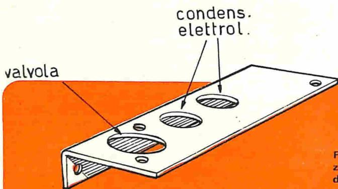
Fig. 3 — L'angolare di alluminio, prima della sua applicazione al contenitore di plastica, deve essere forato in modo da permettere un agevole fissaggio dello zoccolo porta-valvola e dei due condensatori elettrolitici.
