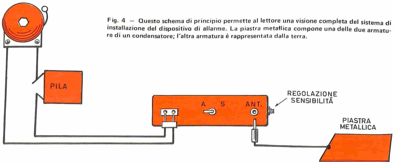
Fig. 4 - Questo schema di principio permette al lettore una visione completa del sistema di installazione del dispositivo di allarme. La piastra metallica compone una delle due armature di un condensatore; l'altra armatura è rappresentata dalla terra.
