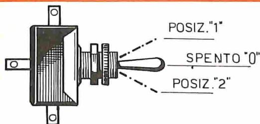
Fig. 3 - Il commutatore S2 può assumere tre diverse posizioni, 1-0-2, corrispondenti alle tre diverse condizioni elettriche del dispositivo; lampeggiatore, spento, lampada a luce costante.
