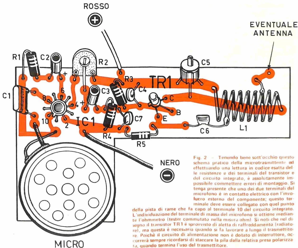
Fig. 2 - Tenendo bene sott'occhio questo schema pratico della microtrasmettente ed effettuando una lettura in codice esatta delle resistenze e dei terminali del transistor e del circuito integrato, è assolutamente impossibile commettere errori di montaggio. Si tenga presente che uno dei due terminali del microfono è in contatto elettrico con l'involucro esterno del componente; questo terminale deve essere collegato con quel punto
