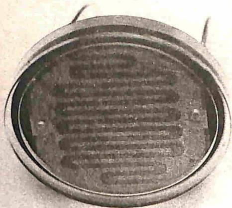
**Questa fotoresistenza di notevoli dimensioni è da adottarsi in quei casi in cui la corrente elettrica assume un certo valore di intensità. La sua più naturale applicazione è quella dei circuiti con relé poco sensibili. La notevole superficie dello strato sensibile permette di dissipare bene il calore.**
