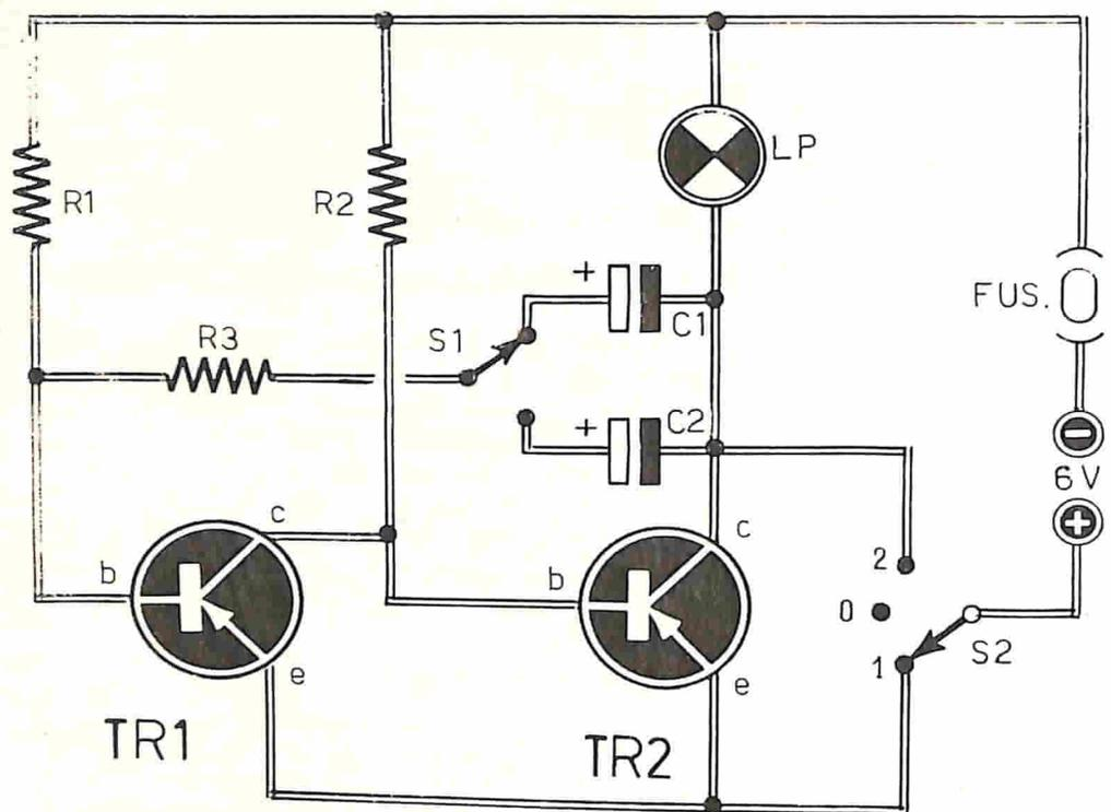
Fig. 1 - Quando il commutatore S2 si trova nella posizione indicata nel disegno, il circuito funziona come lampeggiatore elettronico; con S2 in posizione 0 il circuito rimane "aperto", cioè spento; con S2 in posizione 2 il dispositivo diviene quello di una comune lampada di illuminazione a luce costante.
