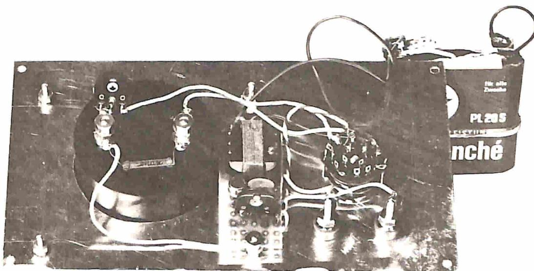
**Fig. 6** — In questa foto è riprodotto il cablaggio del semplice capacimetro per principianti realizzato nei laboratori di Elettronica Pratica.
