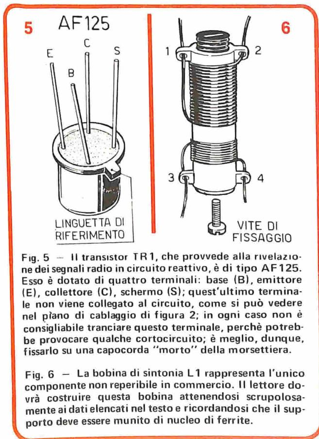
Fig. 5 — Il transistor TR1, che provvede alla rivelazione dei segnali radio in circuito reattivo, è di tipo AF125. Esso è dotato di quattro terminali: base (B), emittore (E), collettore (C), schermo (S); quest'ultimo terminale non viene collegato al circuito, come si può vedere nel piano di cablaggio di figura 2; in ogni caso non è consigliabile tranciare questo terminale, perché potrebbe provocare qualche cortocircuito; è meglio, dunque, fissarlo su una capocorda "morta" della morsettiera.
