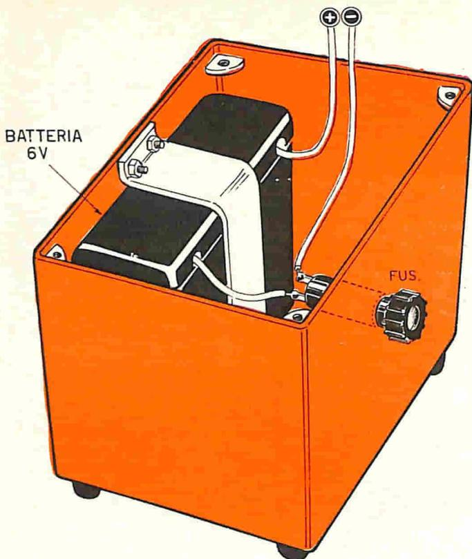
**Fig. 4** — La batteria a 6 V di una moto può trovare agevole alloggiamento nel contenitore metallico del dispositivo. Ma è molto più comodo far funzionare l'apparato prelevando l'energia elettrica di alimentazione direttamente dalla batteria del veicolo.
