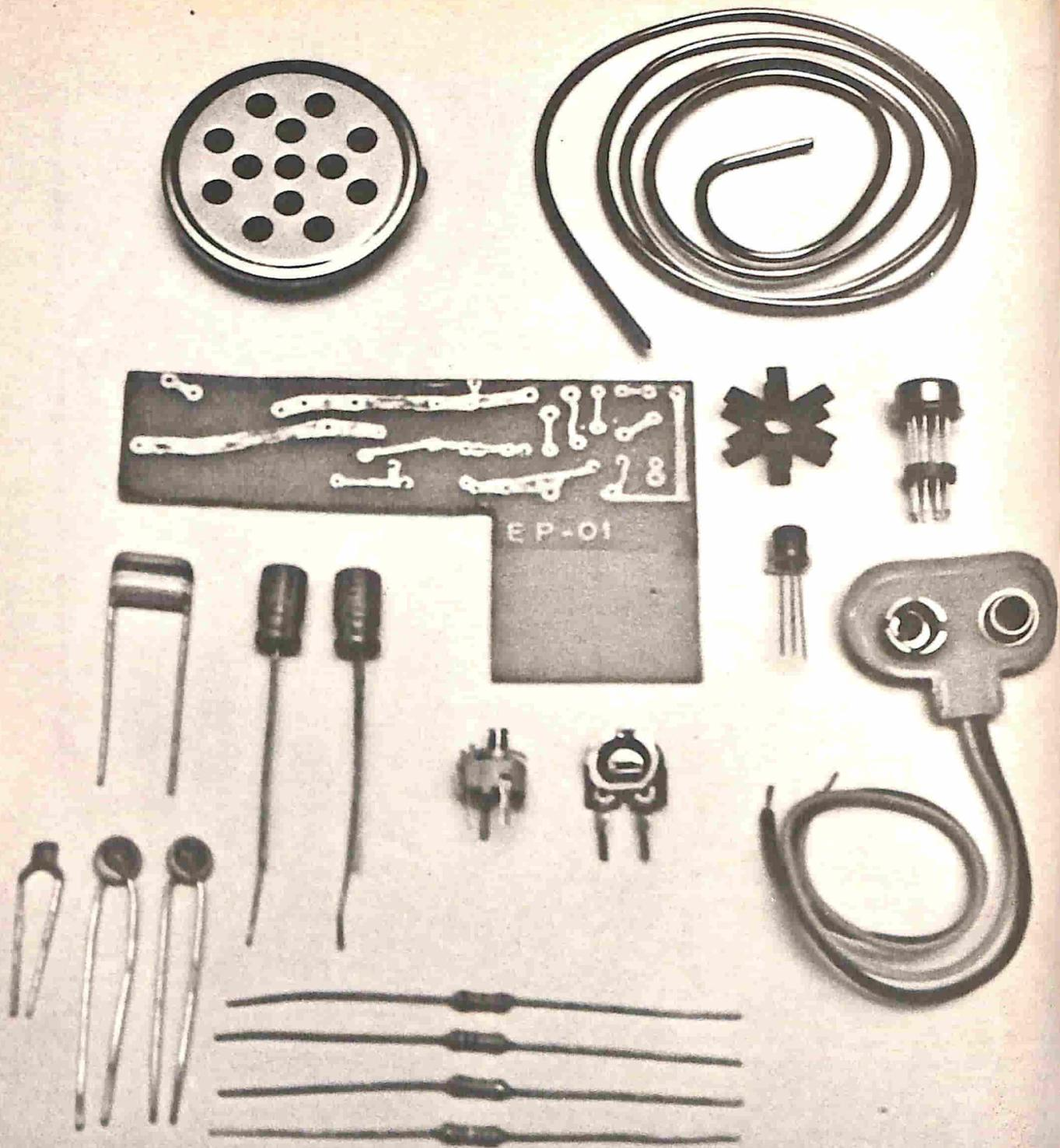
Fig. 8 — Il kit della microtrasmettente comprende: n° 4 resistenze fisse; n° 1 resistenza variabile; n° 6 condensatori, di cui 2 sono elettrolitici; n° 1 compensatore; n° 1 transistor; n° 1 circuito integrato; n° 1 microfono piezoelettrico; n° 1 presa polarizzata; n° 1 radiatore per transistor; n° 1 pila a 9 V; n° 1 circuito stampato; filo per realizzazione bobina.
