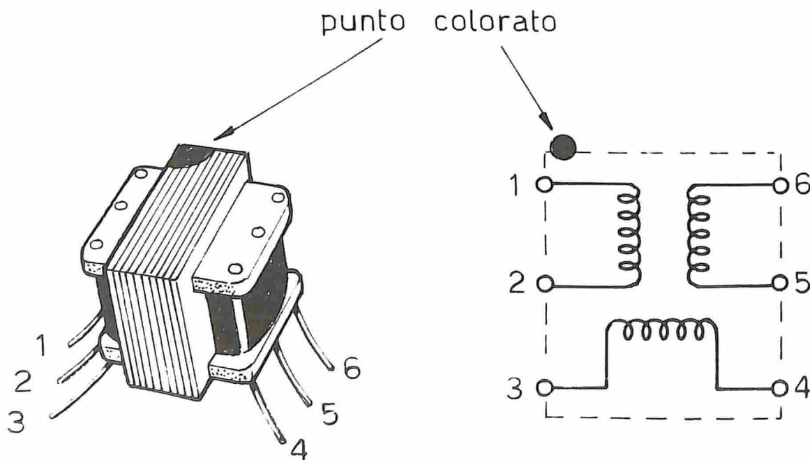
Fig. 5 — Non tutti i trasformatori intertransistoriali si assomigliano. Ma la maggior parte di essi presentano, sul pacco lamellare un punto colorato, che permette di individuare l'ordine di successione dei tre avvolgimenti e la loro corrispondenza con i terminali. Il lettore dovrà tener presente che, in caso di mancata oscillazione, si dovrà invertire l'ordine di collegamento dei terminali contrassegnati con i numeri 5 e 6.
