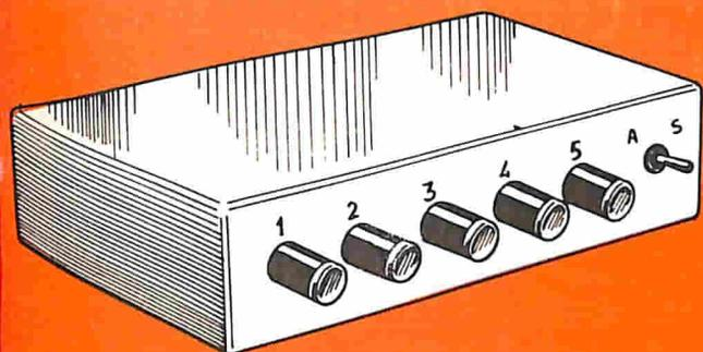
Fig. 2. — Tutte le entrate del miscelatore sono necessariamente schermate, dato che il loro "corpo" esterno si trova in contatto elettrico con il telaio metallico del miscelatore. I cinque potenziometri, applicati nella parte anteriore del telaio, permettono di regolare il segnale prima di inviarlo ai successivi stadi amplificatori.
