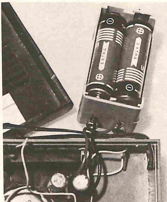
**Fig. 6** — Non commettete errori quando inserite le pile nel contenitore. E tenete presente che la polarità negativa deve formare contatto con la lamella flessibile; nel contenitore sono riportati i segni + e - (positivo e negativo) che non permettono di sbagliare.
