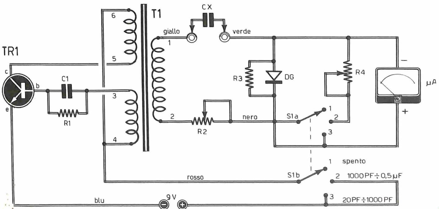
Fig. 2a — Il circuito dell'oscillatore di bassa frequenza è composto su una basetta di bachelite, di forma rettangolare. I colori con cui sono contrassegnati i conduttori elettrici trovano preciso riscontro con quelli citati nelle figure 1 e 3. Si tenga conto che il circuito, che può essere stampato o realizzato con fili conduttori di rame, è da considerarsi visto in trasparenza.
