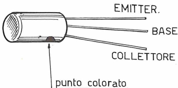
**Fig. 4** Il transistor montato nel circuito del misuratore di campo è di tipo AC127. Nel disegno è evidenziato il fatto per cui la successione dei terminali del componente è pilotata dalla presenza di un punto colorato impresso sull'involucro esterno del transistor. Per quanto riguarda il diodo D1, si tenga presente che in prossimità del terminale dell'elemento di catodo è presente una fascetta.
