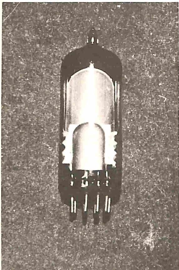
Fig. 5 — Il tubo elettronico EM81 è una valvola di moderna produzione, dotata di due sezioni: quella triodica e quella dell'indicatore visivo vero e proprio. Il secondo anodo della valvola, quando è colpito dagli elettroni, si illumina di una colorazione verde.
