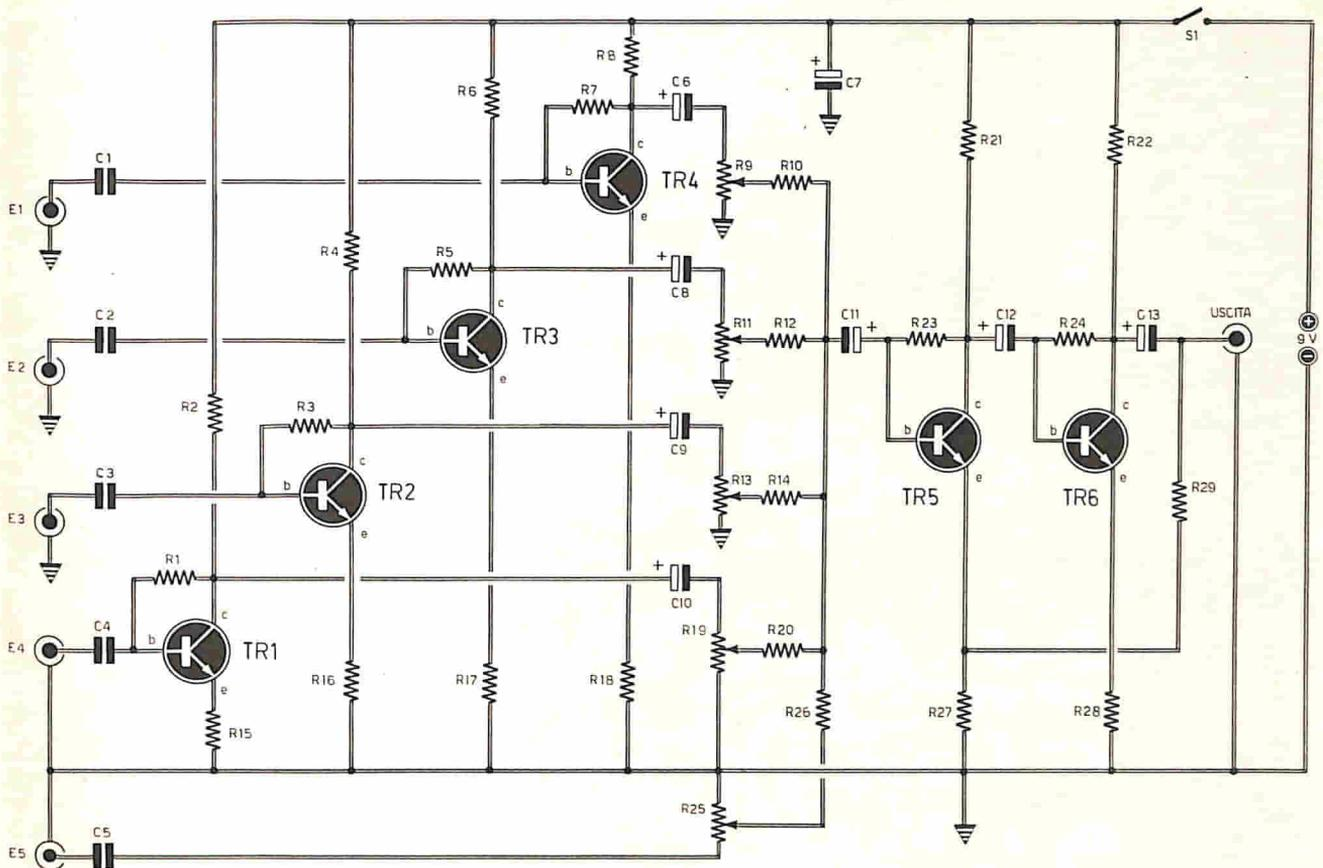
**Fig. 1** — I potenziometri per il controllo del guadagno sono applicati a valle di ogni transistor amplificatore. Le entrate sono quattro, ma possono essere molte di più. E' importante prevedere sempre una entrata ausiliaria (E5) per ogni eventuale necessità pratica.
