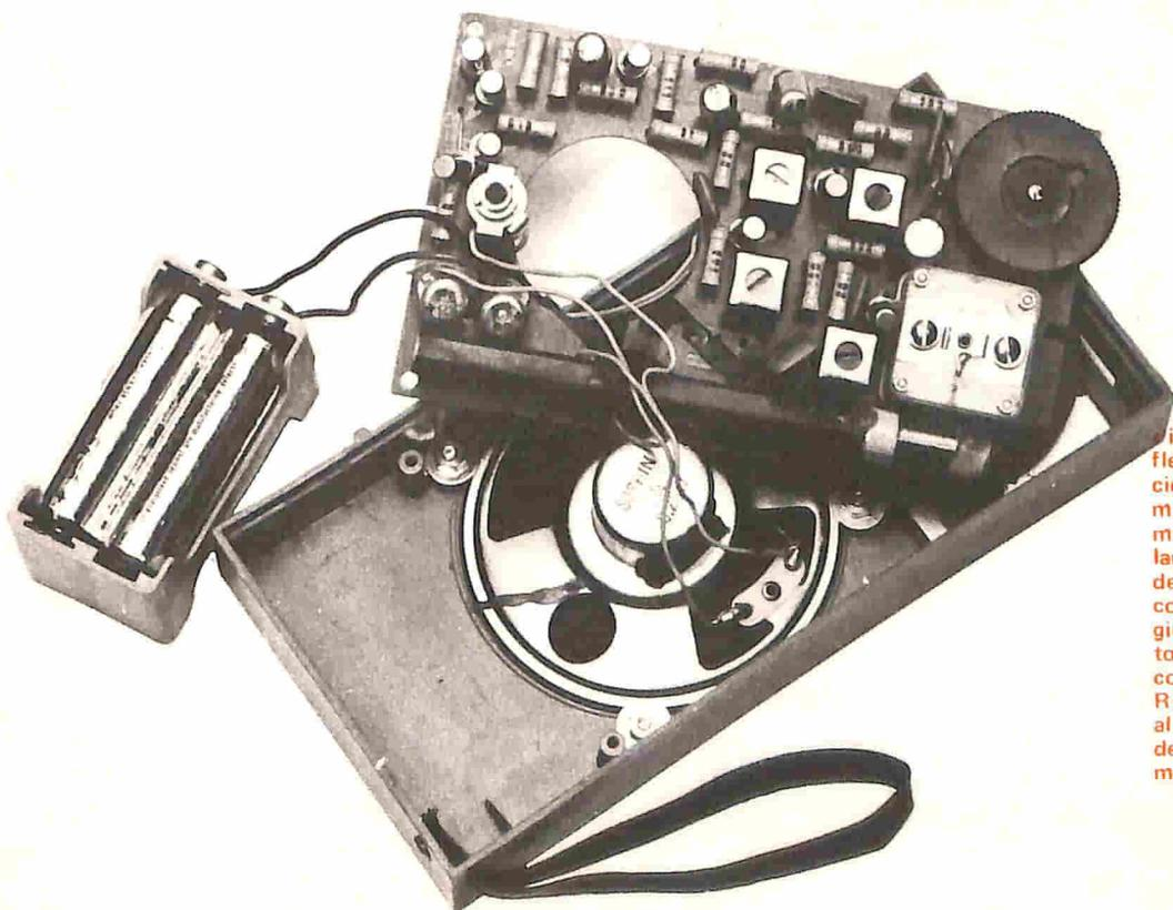
fig. 8 — Pochi fili flessibili sono sufficienti per il collegamento della bobina mobile dell'altoparlante con il circuito del ricevitore. I due conduttori, che raggiungono l'interruttore, incorporato con il potenziometro R10, appartengono alla linea positiva della tensione di alimentazione.
