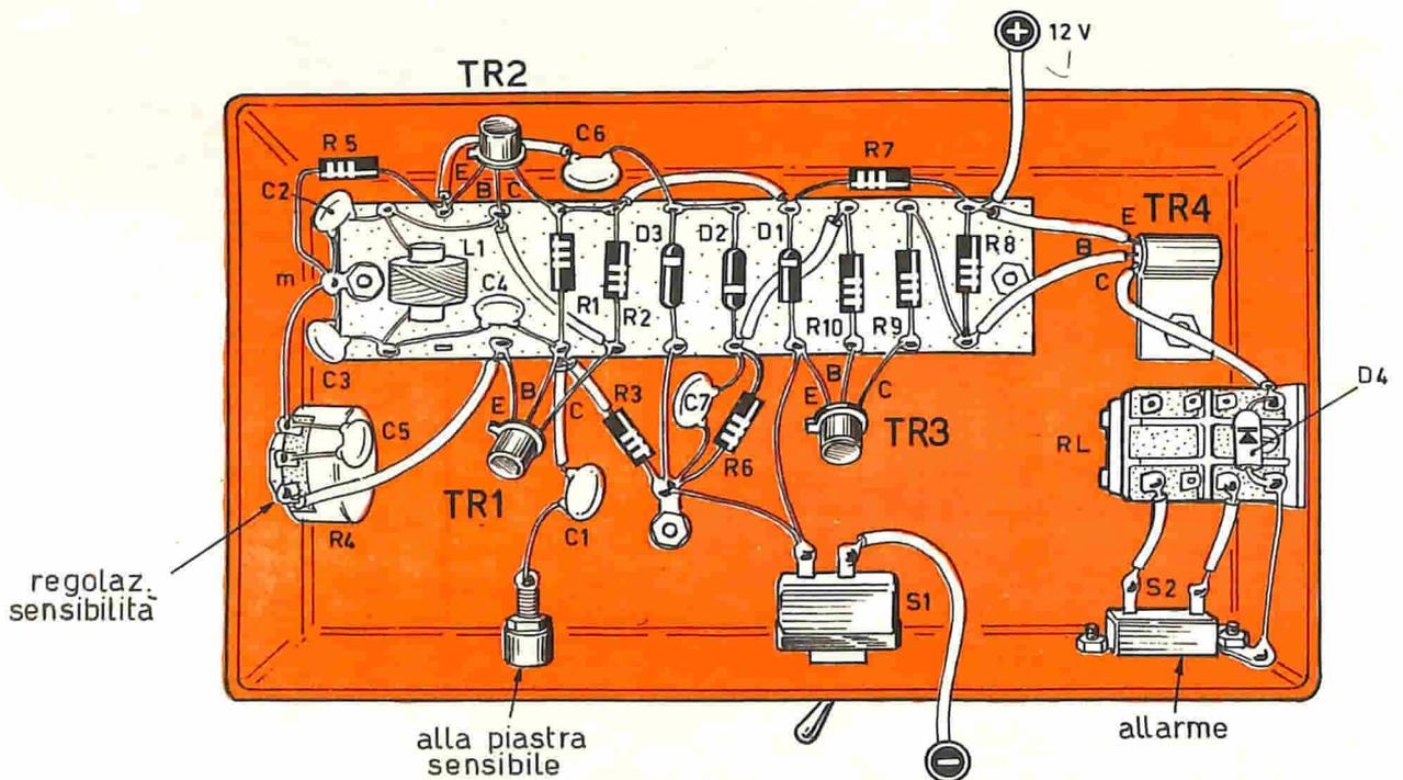
Fig. 2 — Il dispositivo avvisatore, o segnalatore di allarme, è montato in un contenitore metallico, che funge da conduttore della linea negativa della tensione di alimentazione. Come si nota, per il transistor TR4 è necessario realizzare un sistema di raffreddamento, avvolgendo il componente in un elemento metallico dispersore dell'energia termica. La tensione di alimentazione, di 12 V, può essere derivata da un apposito alimentatore in corrente continua, oppure da una batteria d'auto.
