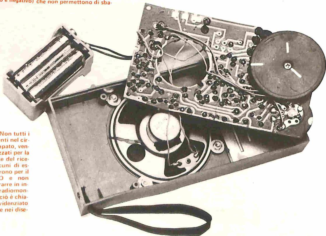
**Fig. 7** — Non tutti i fori, presenti nel circuito stampato, vengono utilizzati per la costruzione del ricevitore. Alcuni di essi non servono per il TICO-TICO e non debbono trarre in inganno il radiomontatore. Ma ciò è chiaramente evidenziato nelle foto e nei disegni.
