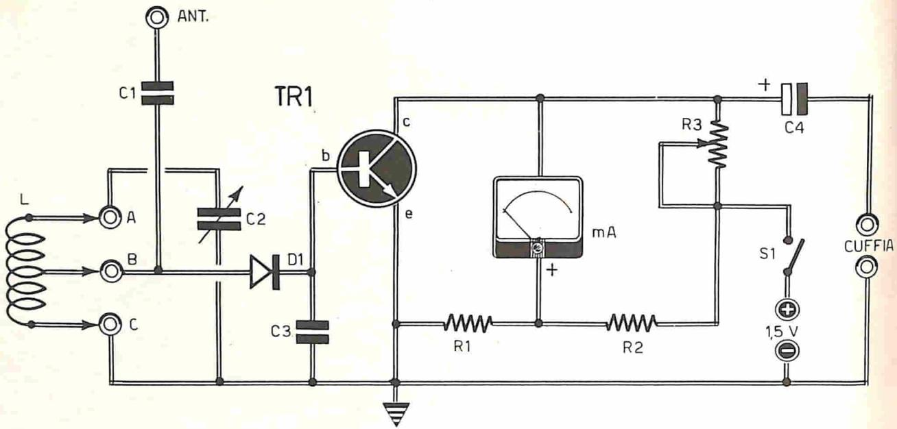
Fig. 1 — Il progetto del misuratore di campo è stato concepito per funzionare su sei bande di frequenze diverse, facendo uso, per L, di sei bobine diverse. La lunghezza dell'antenna, che si deve applicare al circuito di sintonia del misuratore di campo, dipende dalla frequenza di funzionamento del circuito ed anche dalla potenza del trasmettitore posto sotto controllo.
