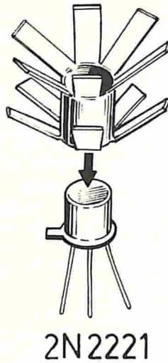
Fig. 3 — L'elemento radiante dell'energia termica prodotta dal transistor è dotato di 12 alette, distribuite su due piani orizzontali. Queste possono essere facilmente ripiegate verso l'alto, qualora dovessero toccare qualche componente. In ogni caso si deve ripiegare verso l'alto quell'aletta che verrà a trovarsi in corrispondenza del compensatore C5, in modo da evitare ogni contatto dell'elemento radiante con il componente elettronico.
