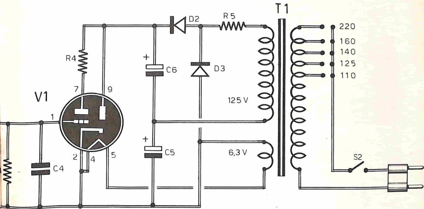
Fig. 2 — Il montaggio dei vari componenti dell'indicatore di livello di bassa frequenza è realizzato in un contenitore di plastica. Il telaio di alluminio, sul quale sono montati i due condensatori elettrolitici e la valvola, è isolato dal circuito di massa. Anche i due terminali negativi dei due condensatori C5-C6 devono essere isolati da massa, cioè non devono trovarsi in contatto elettrico con l'involucro metallico esterno.
