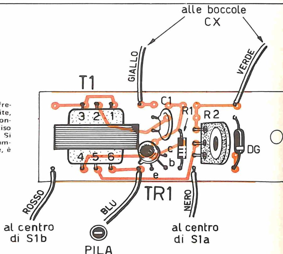
Fig. 2b — Il circuito dell'oscillatore di bassa frequenza, qui disegnato, può essere stampato oppure realizzato con pezzetti di rame nudo. In questo secondo caso la piastrina deve essere opportunamente rivettata.
