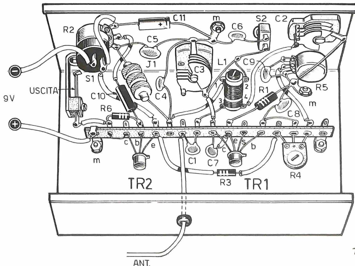
Fig. 2 — Questa tipica distribuzione dei componenti elettronici sul telaio metallico è stata da noi concepita, in sede di progettazione, in modo da raggiungere il miglior funzionamento dell'apparecchio radio, che lavora su due gamme delle onde corte, a seconda della posizione di S2.
