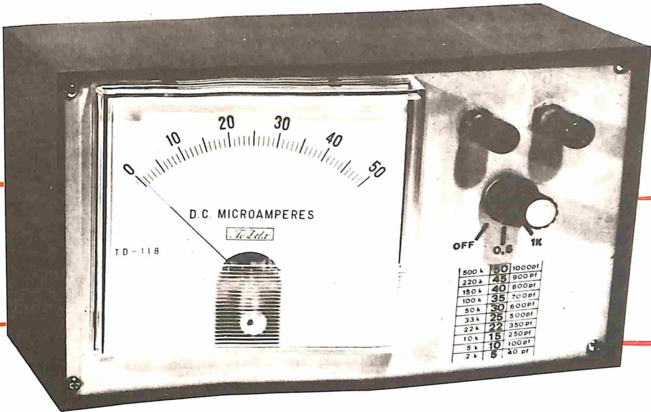
non si deve pretendere soltanto la perfezione dell'isolamento, ma è necessario che esso funzioni con il valore capacitivo, per il quale è stato costruito, fino al valore della frequenza d'uso. E per valutare questi elementi, la prova in corrente continua non è sufficiente perché è necessario sottoporre il condensatore in esame ad un segnale in corrente alternata.
