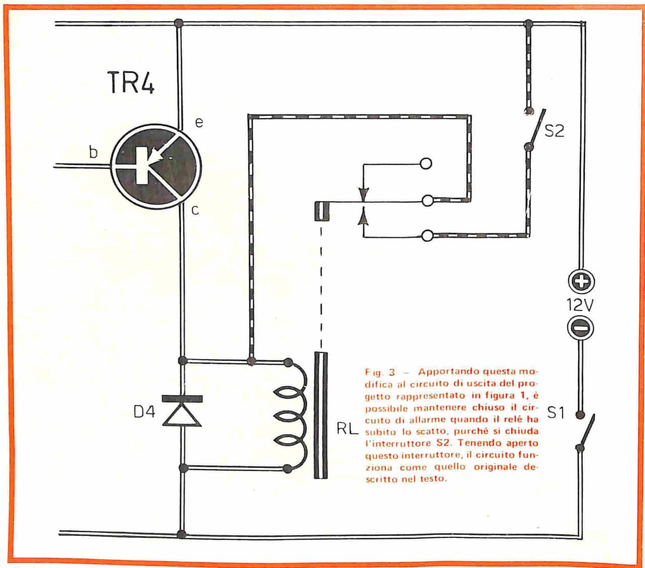
Fig. 3 - Apportando questa modifica al circuito di uscita del progetto rappresentato in figura 1, è possibile mantenere chiuso il circuito di allarme quando il relé ha subito lo scatto, purché si chiuda l'interruttore S2. Tenendo aperto questo interruttore, il circuito funziona come quello originale descritto nel testo.
