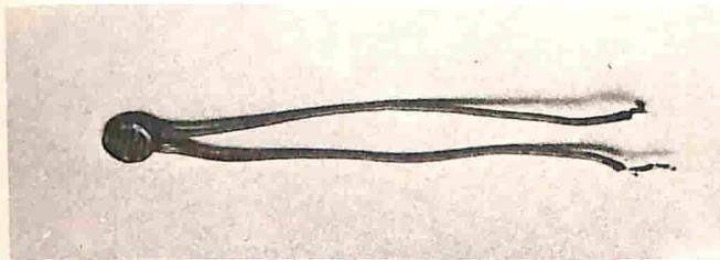
Piccolissima fotoresistenza adatta per tutte quelle applicazioni in cui si renda necessario un minimo ingombro e dove non sia necessario dissipare una notevole potenza elettrica. Questa LDR è sensibile sia allo spettro di luce visibile, sia ai raggi infrarossi. Quest'ultima caratteristica la rende particolarmente adatta per l'impiego nei circuiti di allarme.
