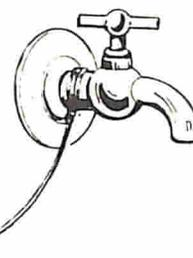
Fig. 4 — Gli ascoltatori più esigenti, allo scopo di esaltare ulteriormente la sensibilità del ricevitore, potranno realizzare un circuito antenna-terra come quello illustrato nel disegno, applicando sulla parte posteriore del telaio metallico le due prese A-T (antenna-terra).
