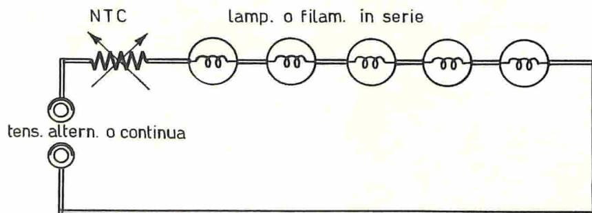
Fig. 8 — Un'altra importante applicazione delle resistenze NTC consiste nell'ottenere il fenomeno dell'accensione lenta di più lampade o valvole elettroniche collegate in serie tra loro. A caldo, le lampade assumono il loro normale valore resistivo. La resistenza NTC limita la corrente elettrica durante il riscaldamento delle lampade mentre, a caldo, si cortocircuita automaticamente
