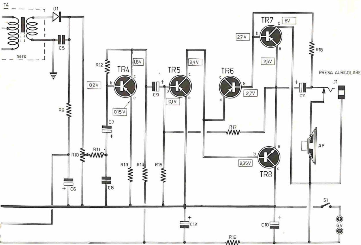
**Fig. 1** — Nel progetto del TICO-TICO sono presenti tutti gli elementi che caratterizzano gli analoghi ricevitori commerciali di classe elevata. Il circuito supereterodina è arricchito dalla presenza di due stadi amplificatori MF. L'alimentazione, in corrente continua, a 6 V, è ottenuta da un collegamento di quattro pile a torcia, da 1,5 V, collegate in serie. I valori delle tensioni, riportati nei vari punti del circuito, sono stati misurati con un voltmetro da 20.000 ohm/volt.
