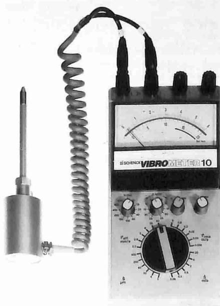
mm/s e in inch/s ed il valore di picco dell'ampiezza della vibrazione in  $\mu\text{m}$  e mils. Nelle analisi di frequenza l'apparecchiatura fornisce le frequenze
