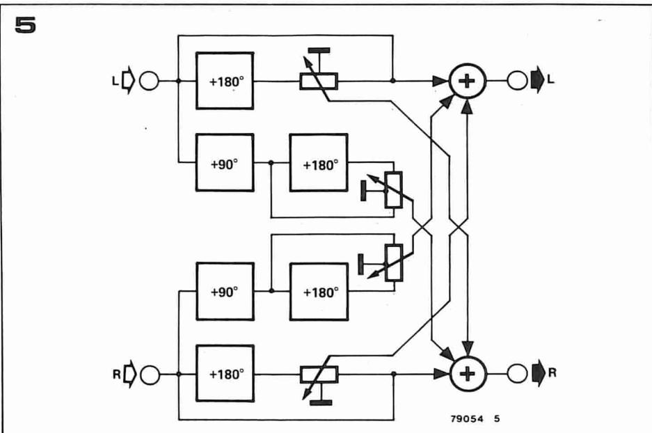
Per il controllo indipendente delle tensioni C' e D', sono necessari due potenziometri per canale, e visto che la modulazione incrociata da un canale all'altro non è necessariamente la stessa, perchè può evolversi diversamente (in effetti ciò in genere non avviene), sono necessari quattro potenziometri per la totale efficacia.
