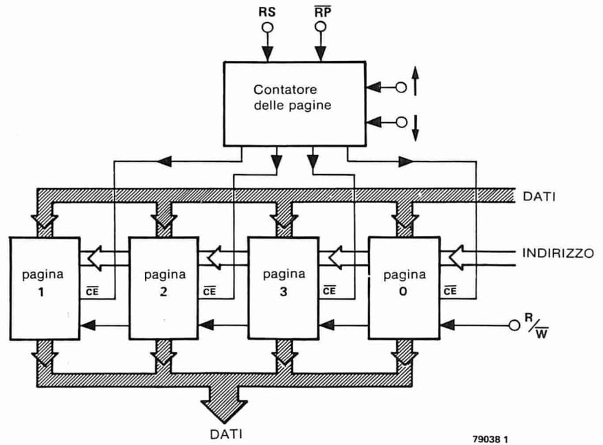
Figura 1. Schema a blocchi del sistema di estensione delle pagine memoria. La pagina 0 è compresa nel pannello dell'Elekterminal.
