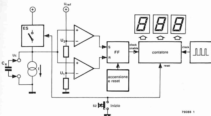
Figura 1. Schema a blocchi del capacimetro digitale. La capacità ignota,  $C_x$ , è scaricata tramite una corrente costante. La lunghezza del periodo di scarica dà luogo ad un proporzionale periodo di conteggio degli impulsi.
