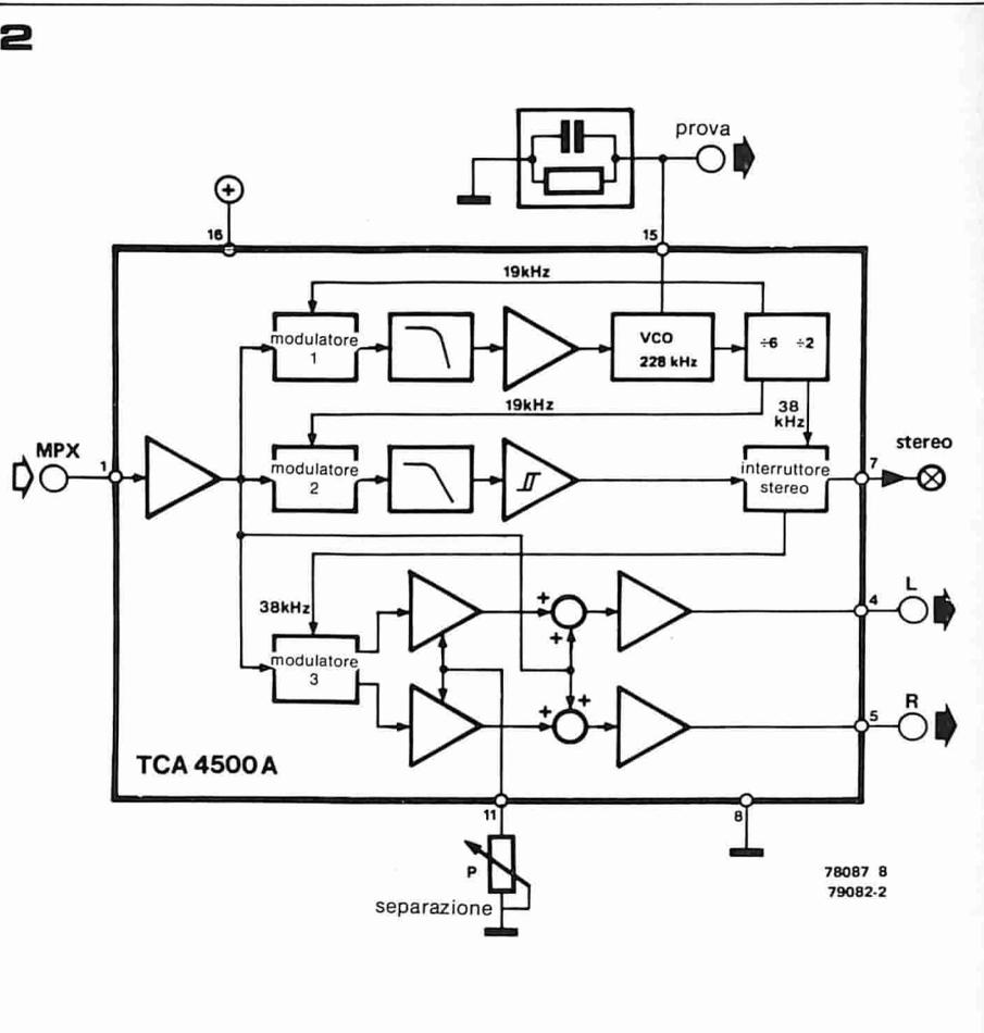
come dire 228 kHz. La frequenza d'uscita del VCO è divisa per 6 ad ottenere la sottoportante a 38 kHz (che è soppressa nel trasmettitore).
