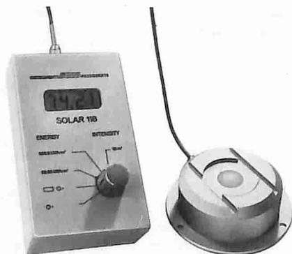
La precisione di misura dell'energia è di  $\pm 2\%$  del valore letto  $\pm 1$  digit, mentre per l'intensità è di  $\pm 3\%$  v.f.s.  $\pm 1$  digit.
