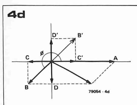
Figura 4. Il diagramma delle relazioni di fase illustra come il segnale della modulazione incrociata può essere eliminato sommandolo ad un altro segnale dall'ampiezza medesima ma dalla fase opposta.
