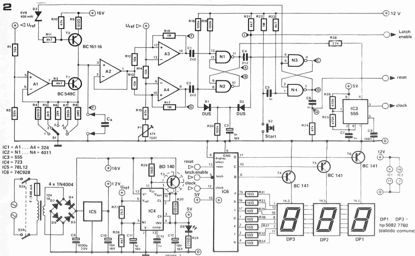
Figura 2. Schema elettrico completo. S'impiegano dei display con il catodo comune.
