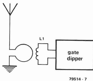
**Figura 7.** Impiegando il grid-dip meter come sintonizzatore AM (operante sul principio della conversione diretta), è possibile ottenere una scala di frequenze accuratamente calibrata. Come antenna, si deve impiegare un tratto di filo lungo una decina di metri.
