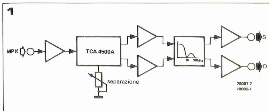
Figura 1. Schema a blocchi del decodificatore stereo.
