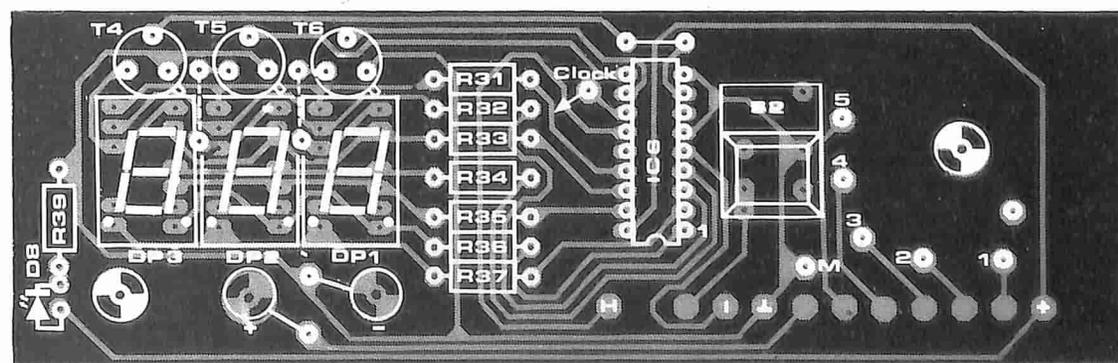
zione la gamma di misura preferita tramite S1, si collega il condensatore ignoto, si preme il pulsante di avvio (S2) e si guarda il risultato che appare sul display. Le gamme di misura sono indicate nell'apposita tavola; la corrente I, indicata nella tavola, è la intensità costante impiegata per scaricare Cx.
