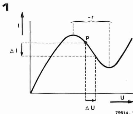
**Figura 1. La caratteristica peculiare di un diodo tunnel, è la possibilità di esibire un tratto a resistenza negativa nella curva tensione-corrente.**
