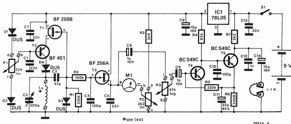
Figura 4. Schema elettrico completo del gate dipper. Il FET T1 ed il transistor bipolare T2 formano il diodo lambda.
