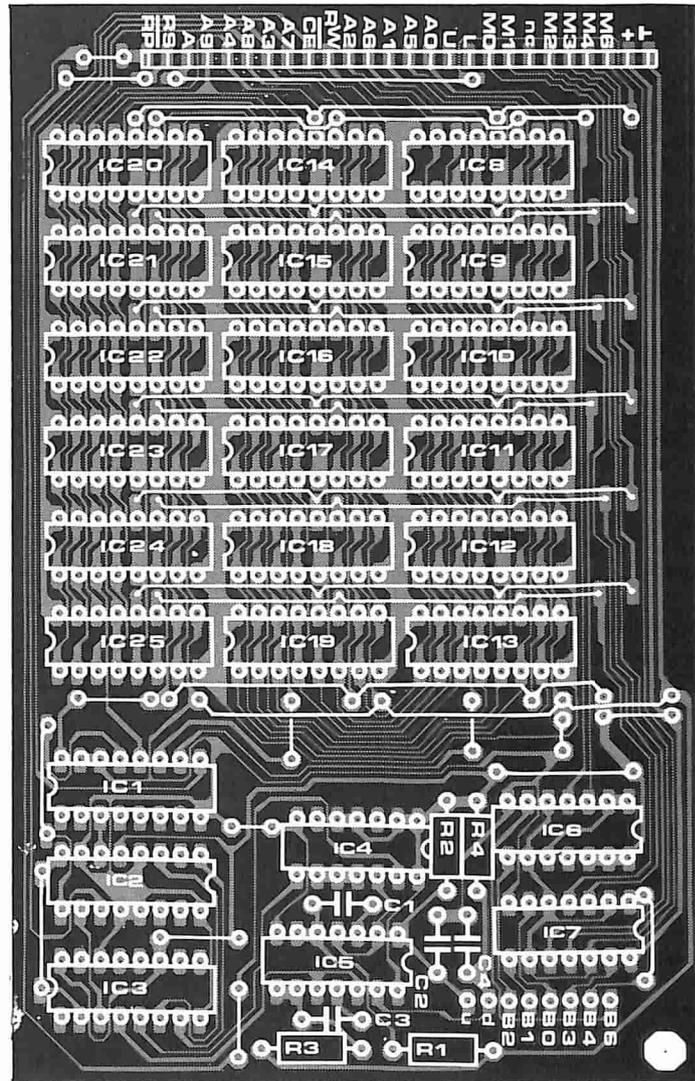
Figura 4. Circuito stampato lato rame e lato parti del pannello espansore di memoria.
