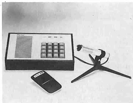
L'RP800 è composto da un emettitore, da un ricevitore (bip-bip) fisso o mobile, ricevitore di suoni o di parole e in certi casi di messaggi parlati e da una tastiera di chiamata con microfono separato. La tastiera ha incorporato il codificatore che serve per la ricerca.
