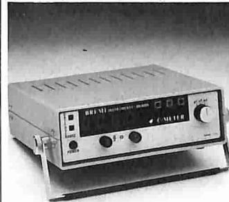
Indicazioni luminose ausiliarie forniscono il tempo di gate, overrange, scala prescelta. I collegamenti avvengono a mezzo bocchette, con indicazione di polarità per i condensatori elettrolitici.
