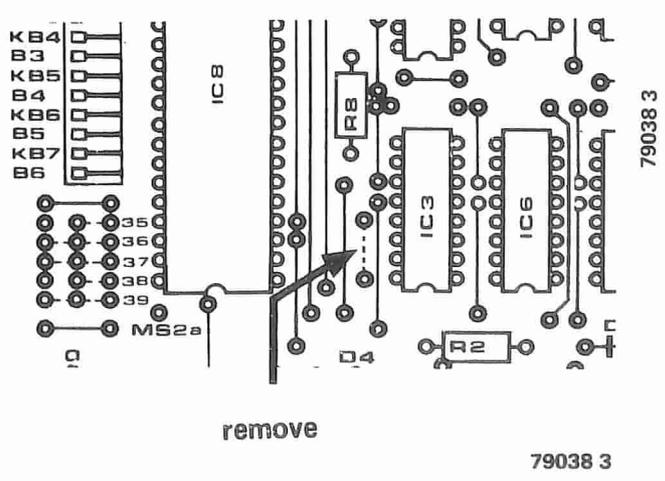
Figura 5. La figura mostra chiaramente il cavallotto in filo che deve essere tolto nel pannello dell'Elekterminal.
