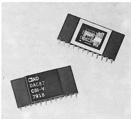
L'AD DAC 87 offre ranges di uscita di  $\pm 2,5$ ,  $\pm 5$ ,  $\pm 10$ , da 0 a +5V o da 0 a +10V (nei modelli V); i ranges delle correnti di uscita (modelli I) sono sia  $\pm 1$  mA che da 0 a -2 mA.
