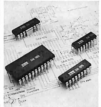
principio PPL, per la sintonia digitale, la memorizzazione del programma, la ricerca delle stazioni, e per visualizzare il numero del programma sullo schermo.
