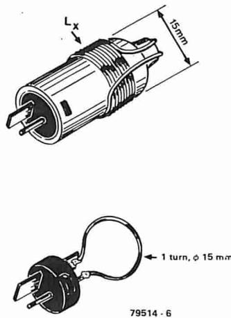
**Figura 6.** Questa figura mostra come si possano avvolgere le bobine su di uno spinotto per altoparlante. Le spire devono essere allontanate per quanto possibile dai reofori metallici della spina, per evitare perdite di energia.
