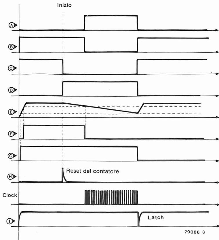
Figura 3. In questo diagramma degli impulsi, le lettere da A ad L sono riferite ai corrispondenti del circuito di figura 2.
