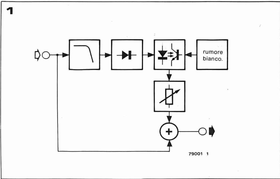
Figura 1. Diagramma funzionale del circuito proposto. Quando il circuito rivela una nota bassa di forte intensità all'interno del brano musicale, genera in corrispondenza ad essa un effetto di percussione a partire da una sorgente di rumore bianco.
