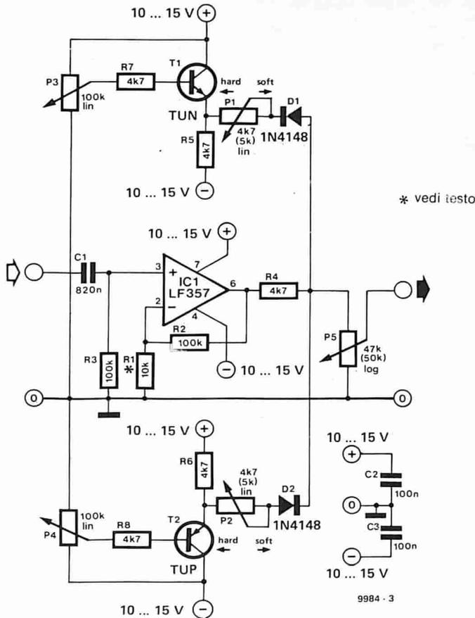
Figura 3. Schema del circuito per un fuzz-box variabile con alimentazione simmetrica.
