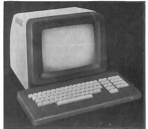
Il terminale video della serie MDL si basa su un microprocessore: ha molte pagine di memoria, le possibilità di editing su tutto lo schermo e di block mode, indirizzamento della posizione di lettura e di scrittura del cursore, più altri dispositivi destinati ad essere utilizzati con gli altri sistemi commerciali. Infine c'è il terminale APL-100, caratterizzato dalla sovrapposizione dei caratteri APL, dai modi ASCII/APL perfezionati con editing dei dati sullo schermo e capacità di block mode.
