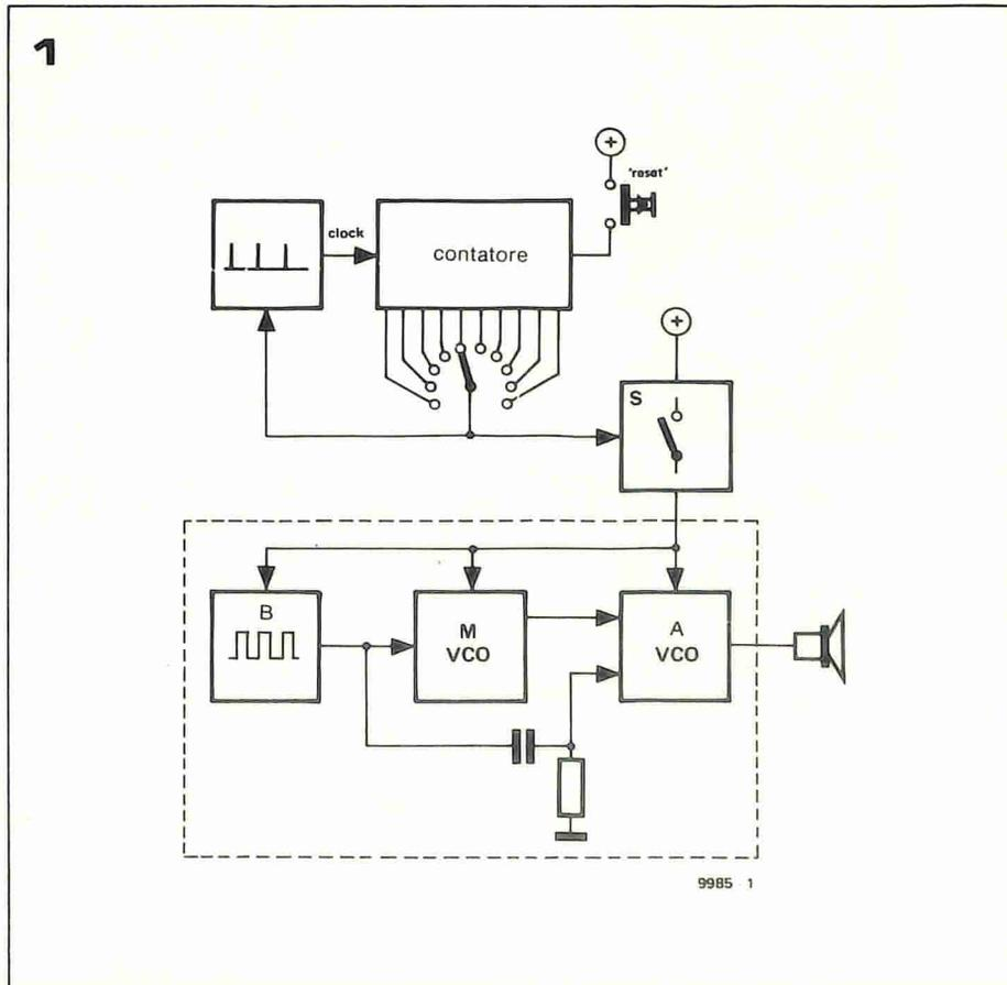
Figura 1. Schema a blocchi del contaminuti. Compito della parte del circuito racchiusa nella linea tratteggiata è produrre un suono simile al verso della gallina.
