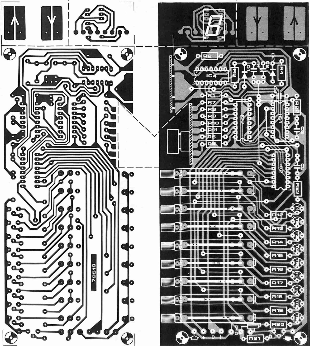
Figura 3. Basetta stampata relativa al circuito descritto. Prima di iniziare il montaggio dei componenti, occorre separare le due piccole basette relative ai sensori ed al display aiutandosi con una sega da traforo.
