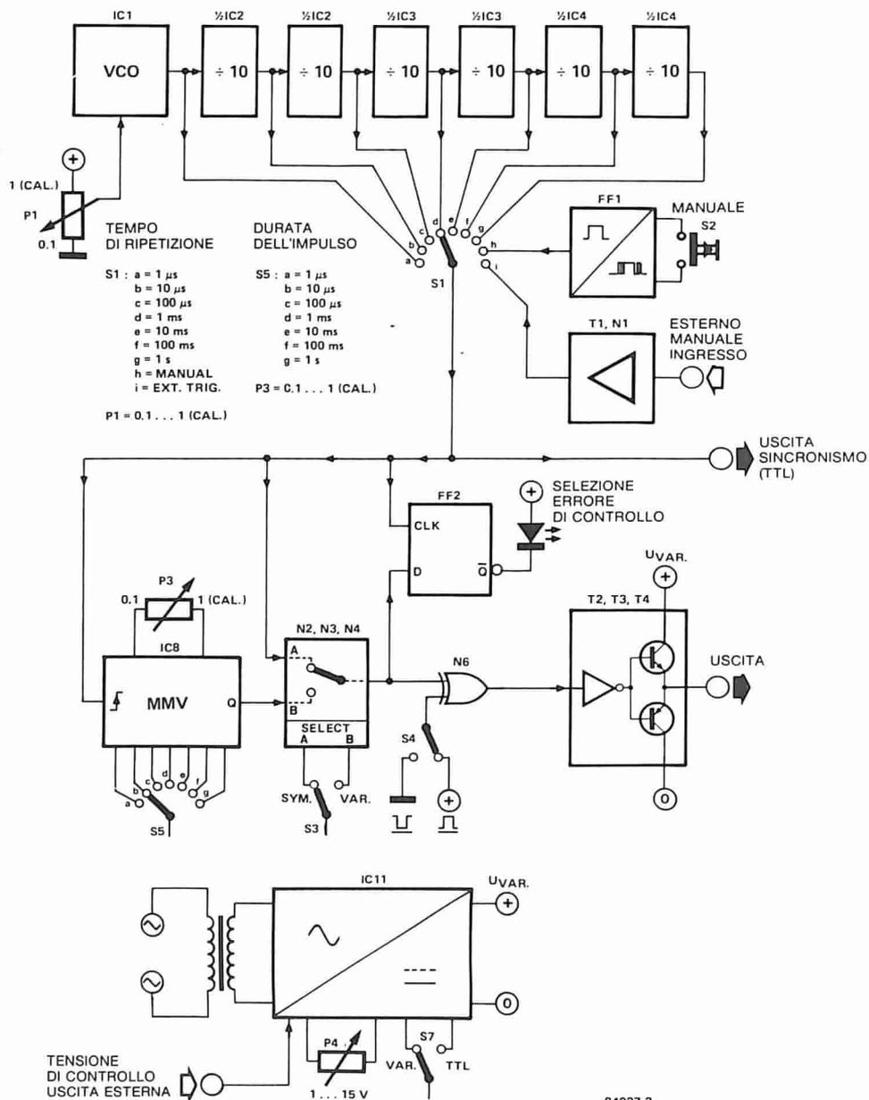
Figura 2. Schema a blocchi del generatore di impulsi descritto in questo articolo. Le designazioni corrispondono a quelle dello schema elettrico.
