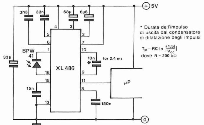
XL486: Applicazione in un'interfaccia con microprocessore
