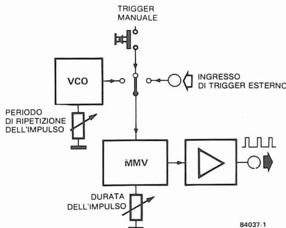
Figura 1. Il generatore di impulsi nella sua forma più semplice: il VCO permette di regolare il periodo di ripetizione degli impulsi, mentre l'MMV regola la durata degli impulsi stessi.
