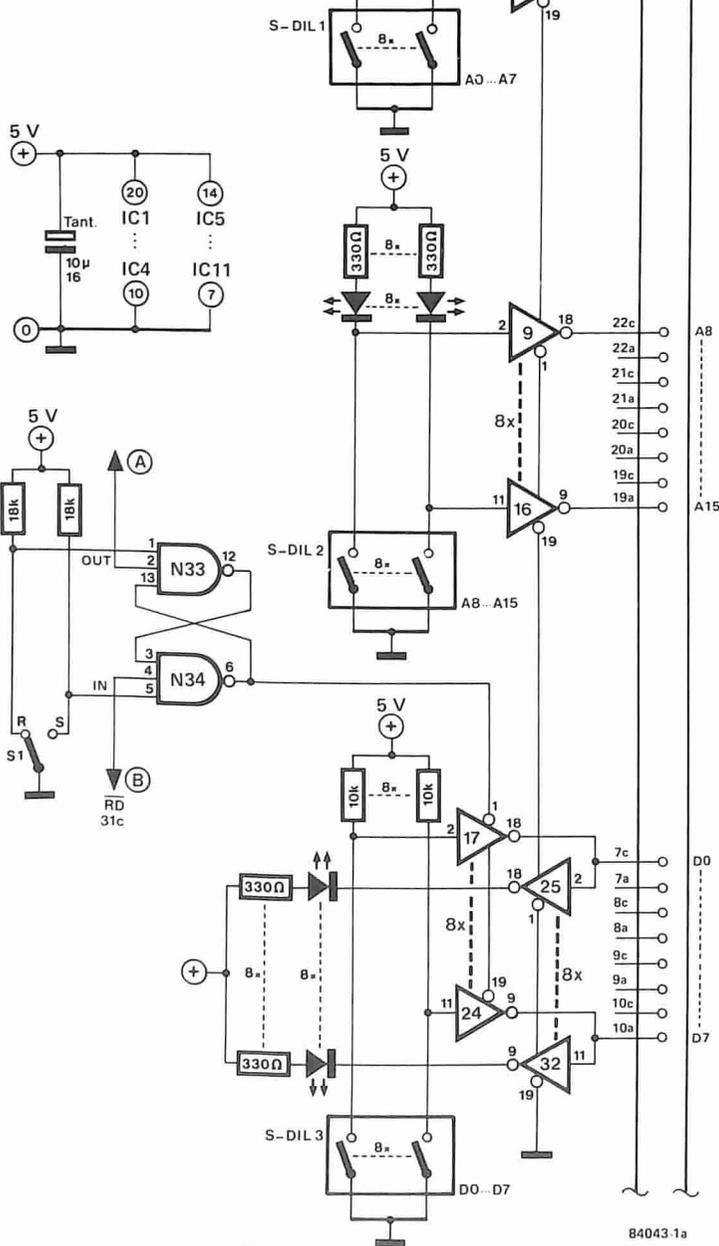
Figura 1a. La parte più semplice del simulatore è anche la più efficiente. I microinterruttori DIL (o di altro tipo) permettono all'utente di scegliere in modo autonomo i livelli logici sulle linee di indirizzamento, e quelli sulle linee dei dati nel modo di "scrittura". I livelli vengono visualizzati mediante LED.
