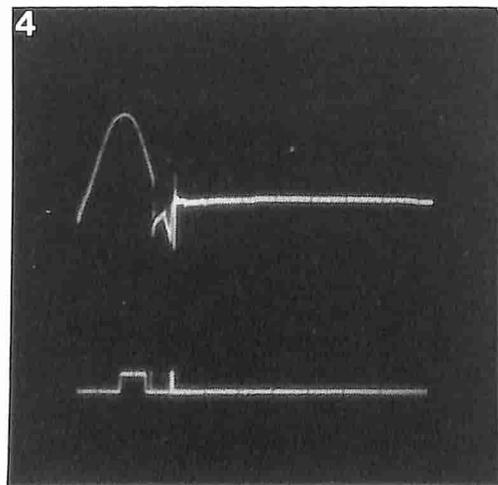
Figura 4. Oscillogramma dell'intervento del limitatore di corrente, quando la corrente supera un determinato valore limite.
