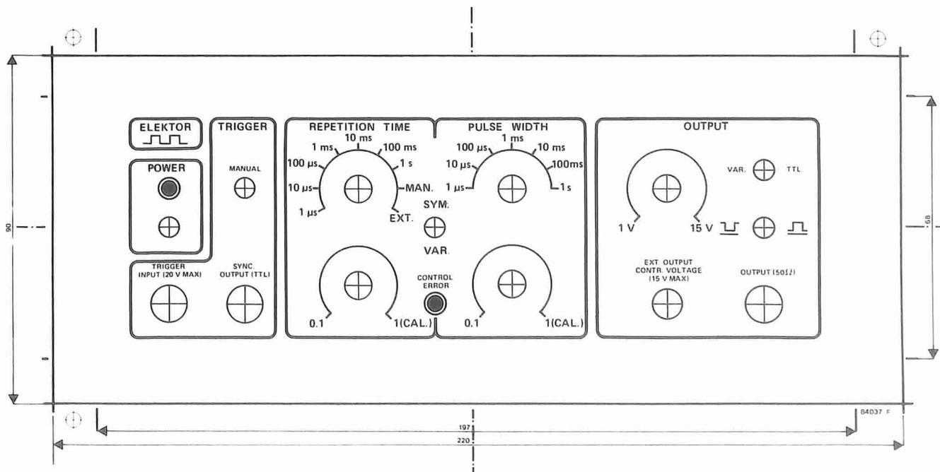
stampato posteriore (Figura 5) mentre i restanti interruttori ed i potenziometri sono montati sull'altra scheda. Adatti fori sono stati previsti sul pannello frontale, allo scopo di permettere l'attraversamento da parte degli alberini di S1 ed S5. Osservare che le filettature dei commutatori e dei potenziometri non devono sporgere più del necessario (circa 3 ... 4 mm), per evitare difficoltà durante il montaggio del pannello frontale.
