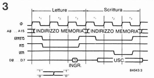
Figura 4. I cicli di lettura e scrittura verso le periferiche, qui rappresentati simultaneamente, non possono apparire insieme nello Z80 e nemmeno nel simulatore, che respinge le configurazioni proibite sia nel modo statico che in quello dinamico.
