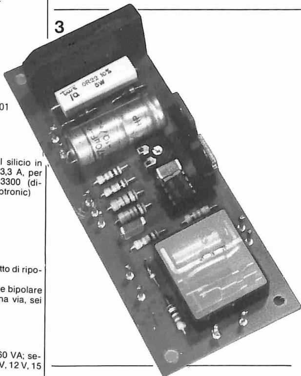
chiaramente visibile. Il collegamento anodico di questo LED viene prelevato dalla presa a 3 V di Tr1. Se è stato scelto un diverso trasformatore, dovrà essere cambiata la resistenza limitatrice di corrente (R8 ~ U/0,04). Se la tensione è maggiore di 3 V, è anche una buona idea collegare un normale diodo al silicio in serie a D7, come misura precauzionale.
