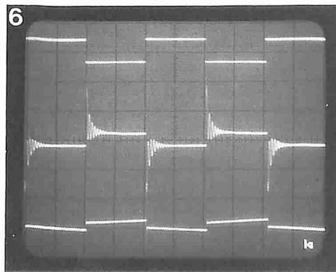
facilmente provati la stabilità dell'amplificatore ed il tasso della velocità di variazione.
