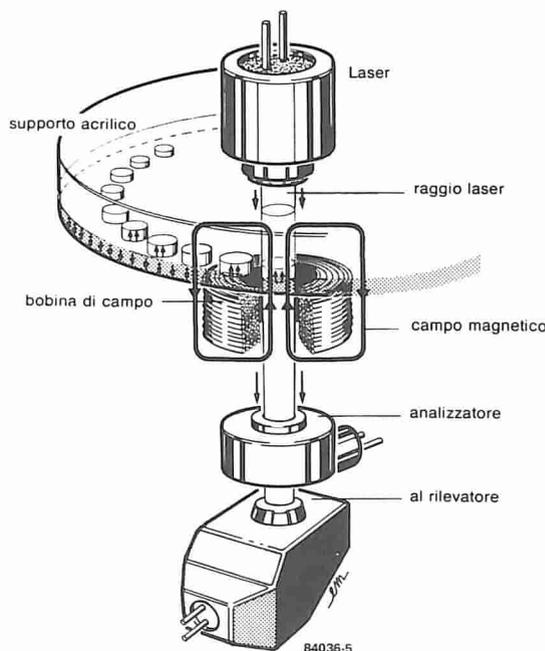
Figura 5. I dischi a memoria ottica cancellabile utilizzano le proprietà termo-magnetiche delle cosiddette "terre rare". La direzione della magnetizzazione si inverte quando il raggio laser colpisce il materiale che si trova in un campo magnetico.
