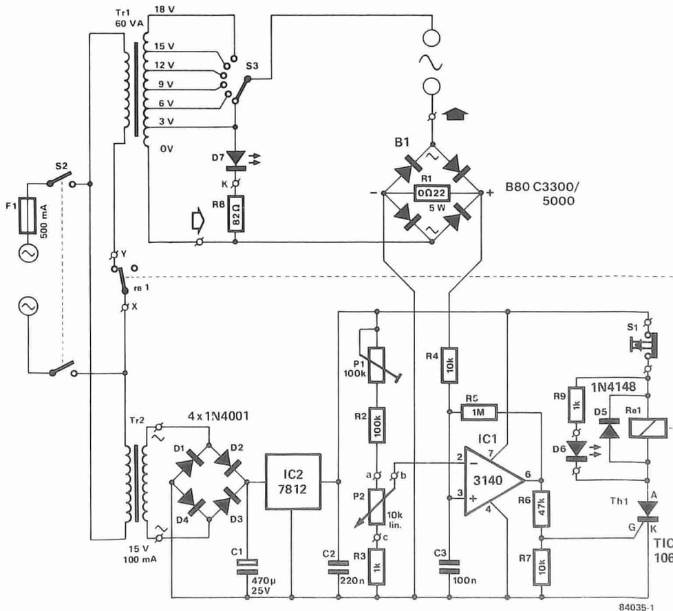
Figura 1. La maggior parte del circuito per l'alimentatore c.a., qui illustrato, serve alla limitazione della corrente.
