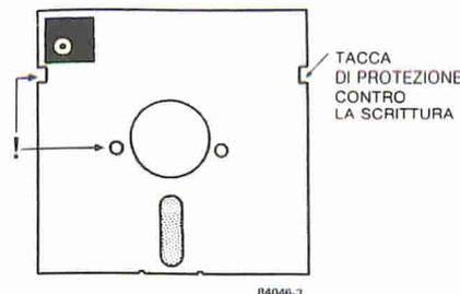
Figura 3. Anche la facciata posteriore di un floppy disk a singola facciata può essere usata, se vengono accuratamente intagliati una tacca di protezione alla scrittura ed un foro indice nella foderina, in posizioni simmetriche rispetto a quelle già esistenti.
