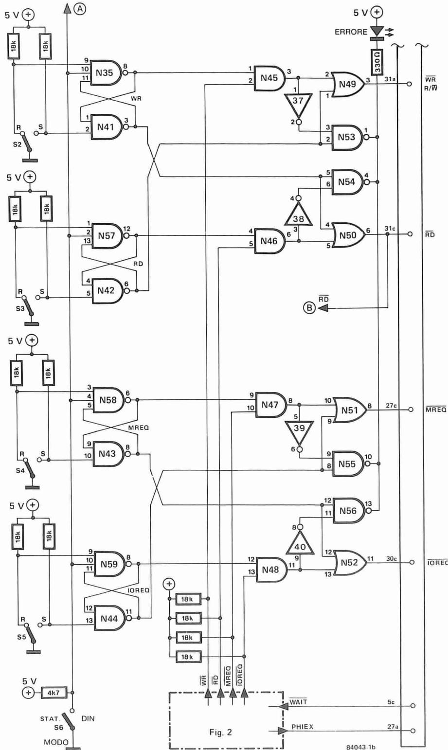
Figura 1b. Nel modo manuale, il commutatore S6 deve essere aperto, altrimenti il flip flop verrà bloccato. Se desiderate usare il circuito esclusivamente in questo modo, potranno essere trascurate le porte logiche N45...N48. In questo caso dovrete fare a meno del funzionamento in modo dinamico, ottenuto con l'aiuto del circuito di Figura 2.
