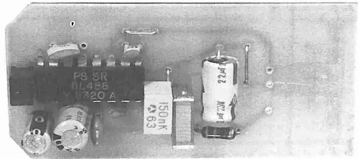
XL486: Circuito stampato di interfaccia con microprocessore
