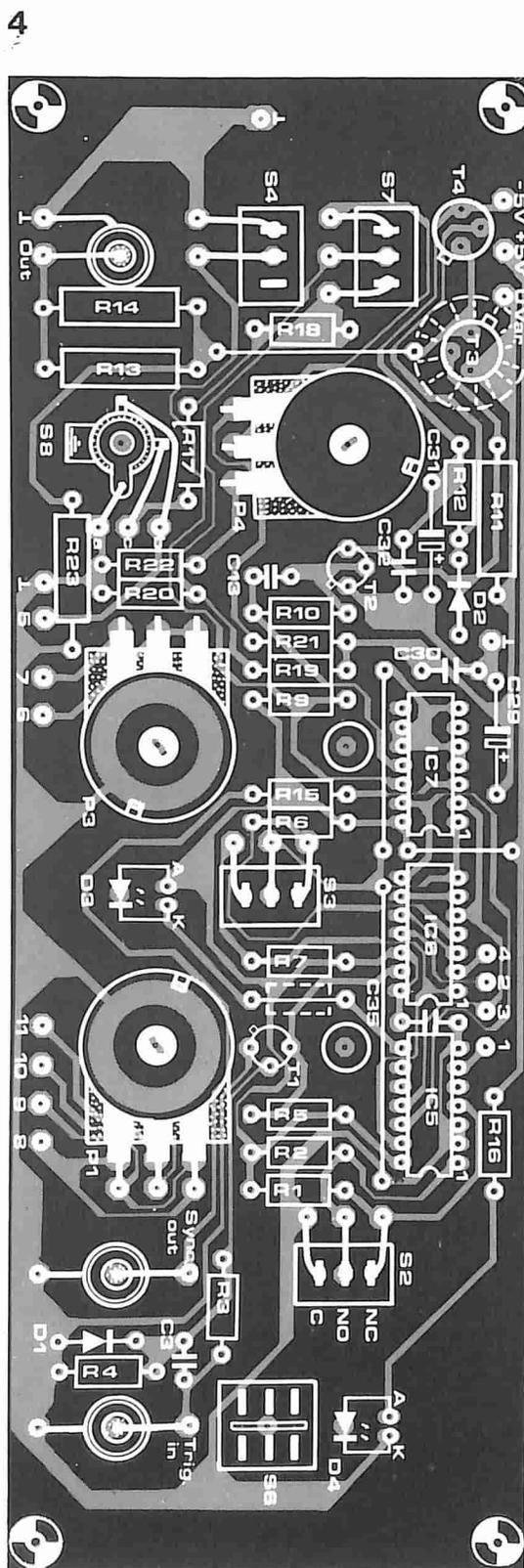
Figura 4. Lo schema è stato diviso in due circuiti stampati: quello qui illustrato contiene le parti dello schema delimitate da linee tratteggiate.
