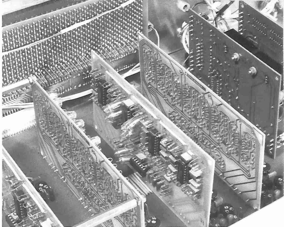
possibile mantenere alta la corrente senza peggiorare la durata dei LED. A causa della corrente elevata, le uscite dei decodificatori sono applicate a circuiti Darlington (T12...T41), e la corrente effettiva viene definita dal valore delle resistenze R23...R52.
