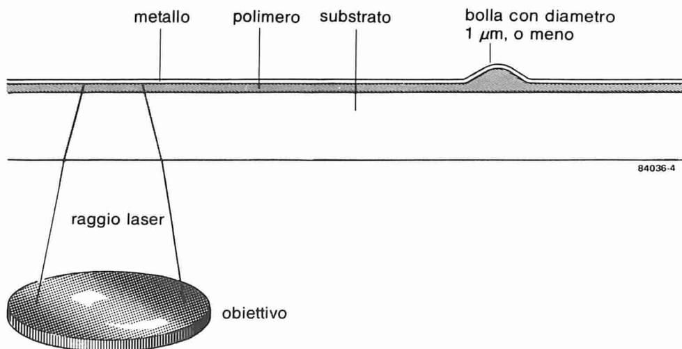
Figura 4. Dove il raggio laser colpisce la superficie del disco per memoria ottica, si forma una bolla, che rappresenta un bit.
