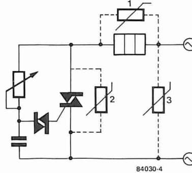
Figura 4. Protezione di un tiristore in un relè elettronico: VDR1 sopprime il disturbo all'origine, mentre VDR3 sopprime i disturbi di origine esterna. Alternativamente, la VDR (2) può essere collegata in parallelo al tiristore stesso.
