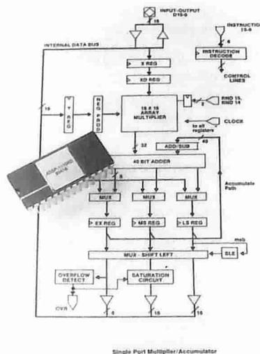
L'ADSP-1110 riduce il costo dei MAC a 16 bit di un fattore da 1 a 2 mentre il packaging con un DIP a 28 pin riduce lo spazio occupato sulla scheda quasi di un fattore da 1 a 4 rispetto ai DIP a 64 pin. Il MAC ADSP-1110 consuma 150 mW, fornisce un accumulatore interno da 40 bit, l'overflow flag, l'aritmetica di saturazione, lo swapping del registro, la capacità shift-left ed altre caratteristiche utili per l'elaborazione digitale dei segnali.
