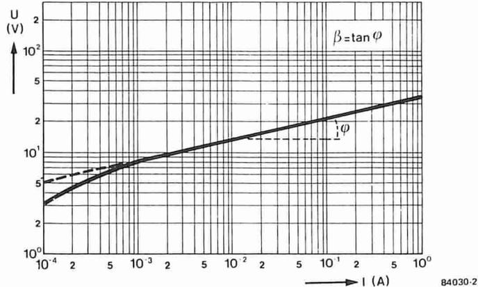
Figura 2. Il grafico della tensione e della corrente su una scala logaritmica permette di determinare  $\beta$ . Questa è la curva caratteristica standard fornita dal fabbricante.
