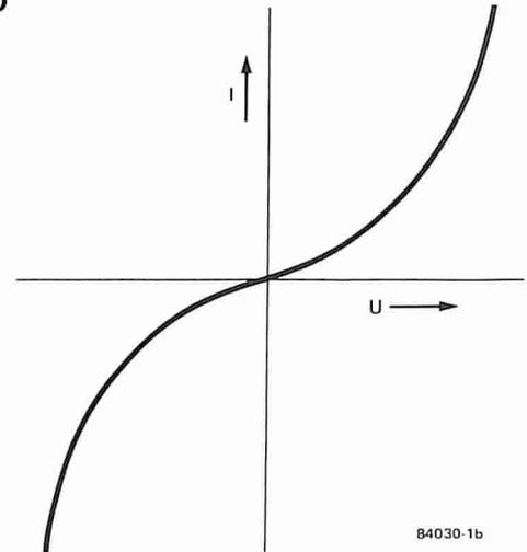
Figura 1. La resistenza di un varistore (resistenza dipendente dalla tensione) dipende dalla tensione applicata (a). La corrente aumenta con legge esponenziale quando aumenta la tensione (b).
