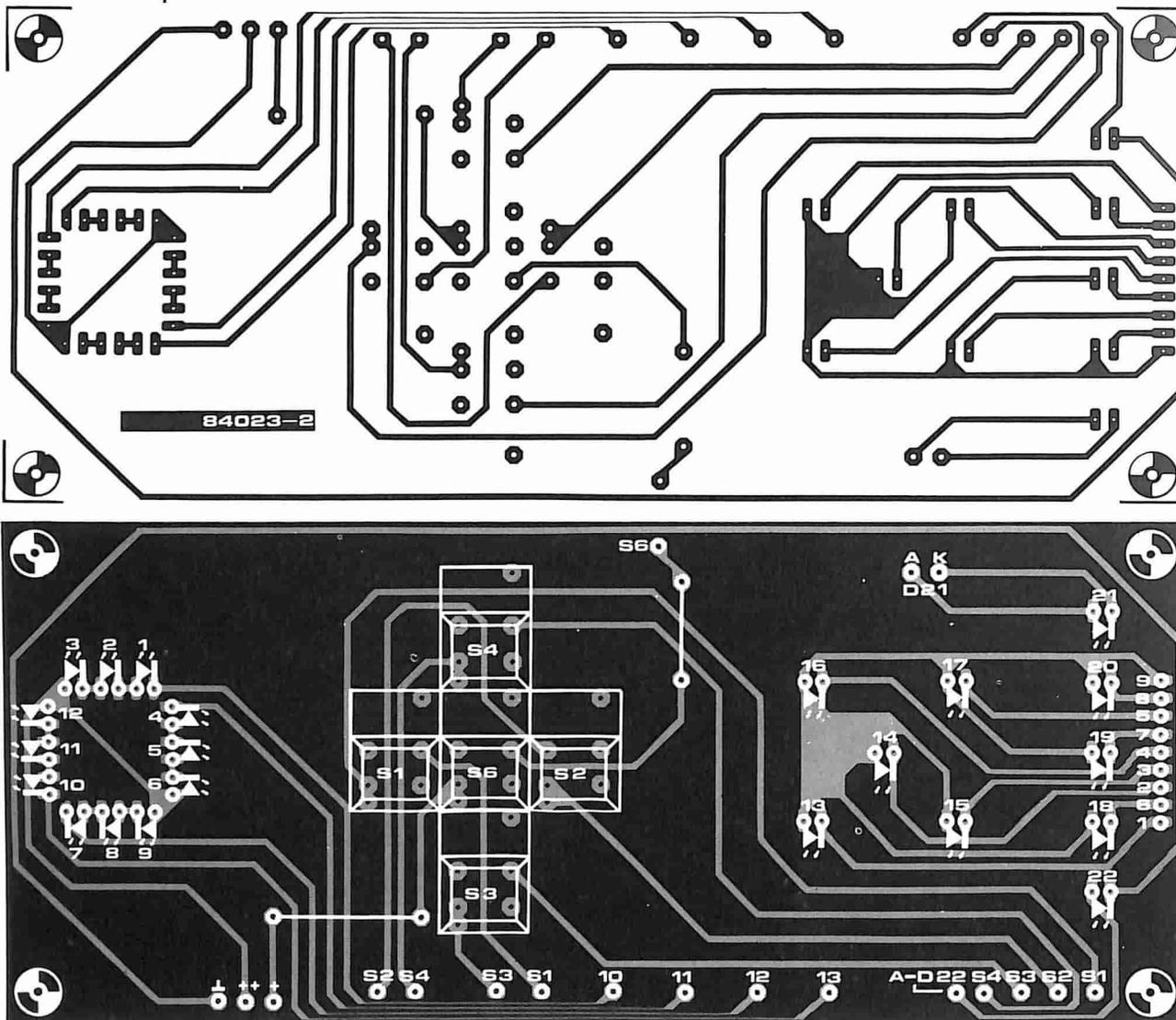
Figura 8. Tutti i pulsanti, gli interruttori ed i LED sono montati sulla scheda di "controllo".
