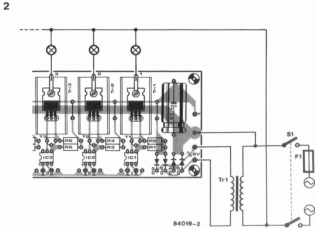
Figura 2. In generale, il cablaggio di rete di una singola scheda di controllo a triac dovrebbe essere analogo a quello qui mostrato.
