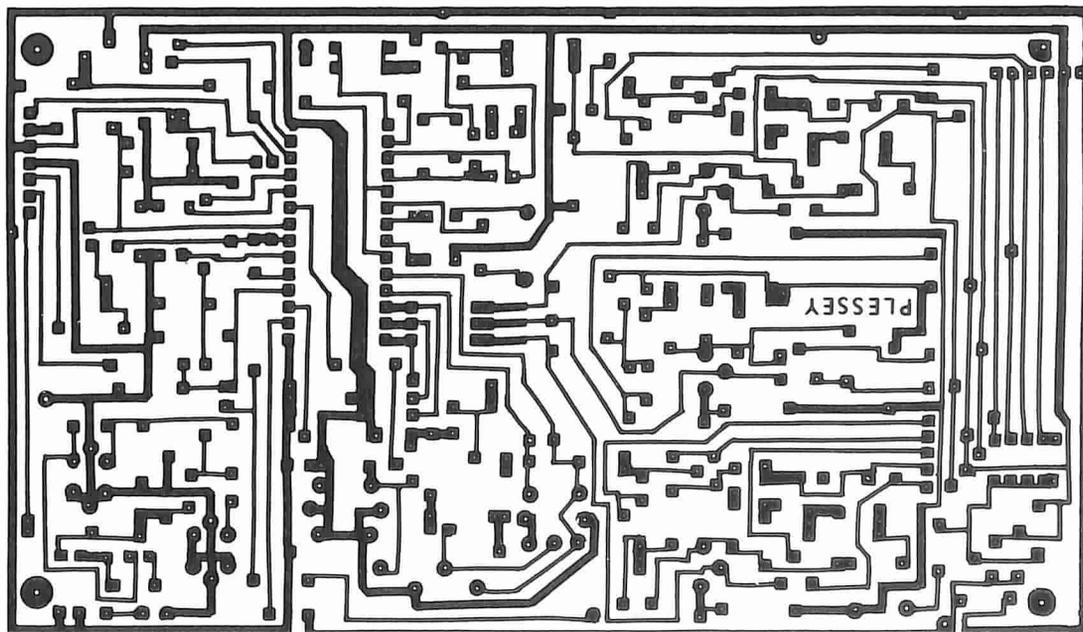
Figura 2. Lato componenti e lato rame del circuito stampato completo per il decodificatore. Se non è necessario il Televideo, potranno essere omessi R53...R70, C29...C36, VR7...VR10, T6...T12 e D1...D4.
