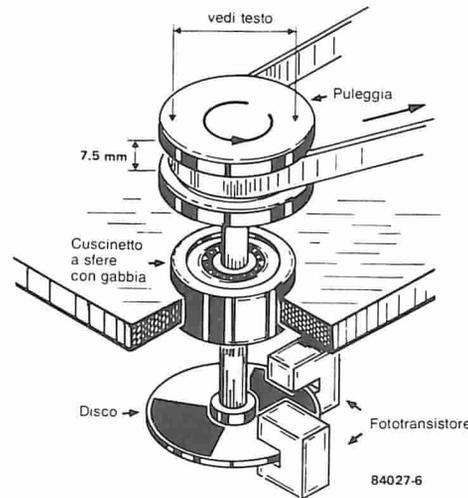
Figura 6. Suggerimento per costruire la puleggia completa di disco. Raccomandiamo di usare un cuscinetto a sfere per minimizzare l'inerzia e l'attrito.
