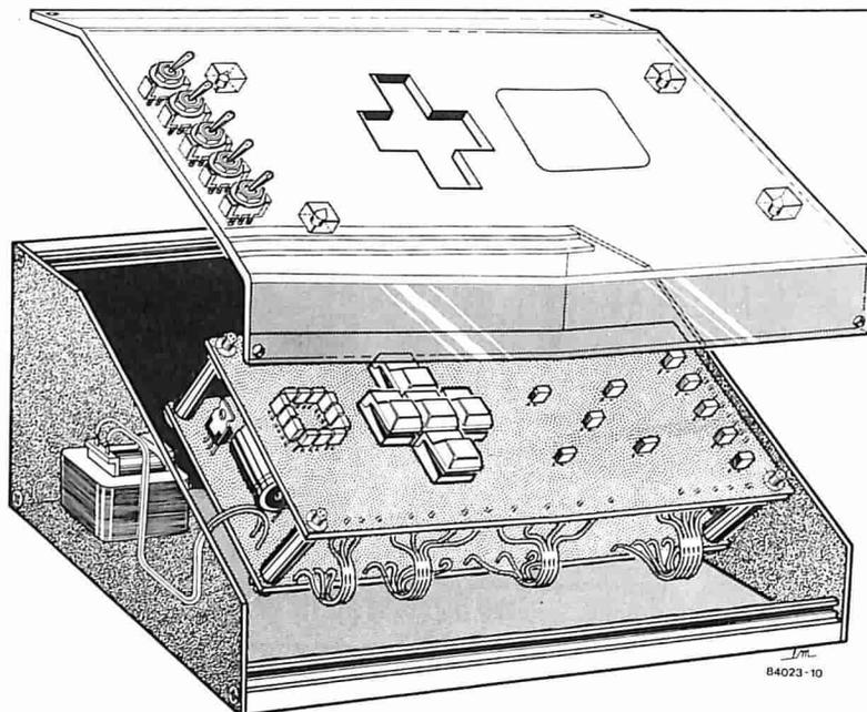
Figura 10. Questo disegno dà un'indicazione del montaggio complessivo dell'intero progetto. La scheda di "controllo" è ricoperta da una lastra di plexiglas rosso nella quale sono stati praticati i fori di passaggio per gli interruttori ed i pulsanti.
