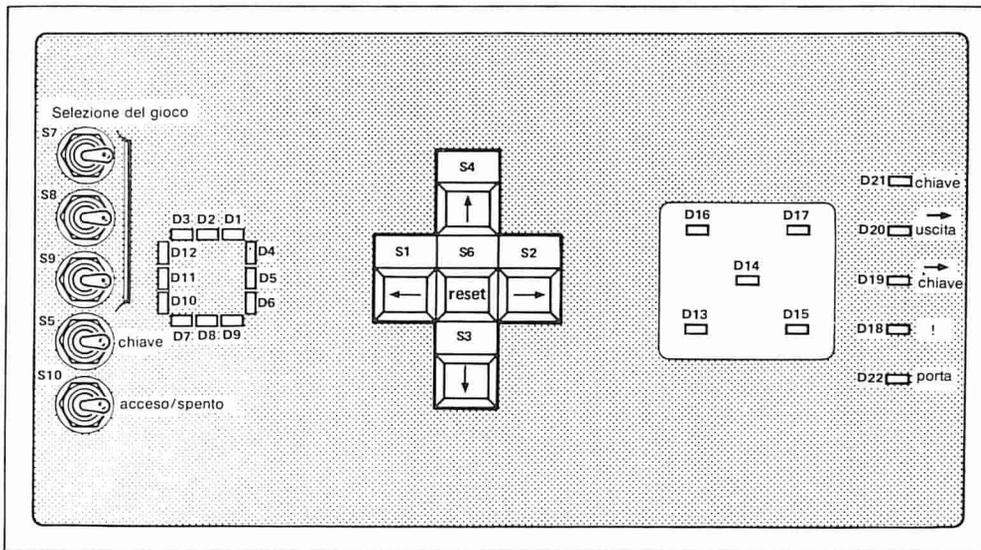
Figura 2. Disposizione del pannello di controllo usato nel nostro prototipo. Gli interruttori usati per il movimento e per l'azzeramento sono al centro, mentre i 12 display a LED per le pareti e gli altri interruttori per usi vari sono a sinistra. I restanti LED, usati per informazioni varie, sono sul lato destro del pannello.
