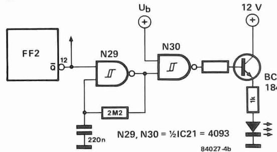
Figura 4. Diversi sistemi per ottenere l'indicazione del segno "meno". In 4a, il LED si accende in continuità mostrando un segno "—". Il LED in 4b lampeggia. Il circuito originale (Figura 2) ha due LED che lampeggiano alternativamente.
