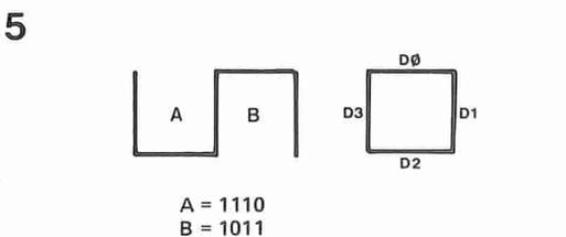
Figura 5. Programmazione dei blocchi. "0" = assenza di parete. "1" = presenza di parete. La sequenza è: sinistra - basso - destra - alto = D3...D0.
