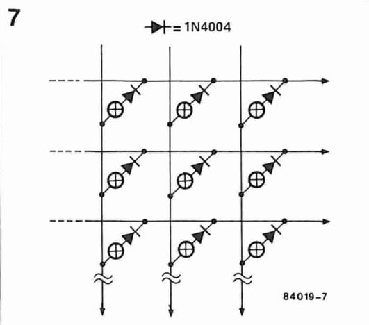
Figura 7. Quando è necessario accendere singole lampade, dovrà essere collegato un diodo in serie con ciascuna lampada, come mostrato in questa figura. Osservare che tutti i diodi sono collegati nella medesima direzione.
