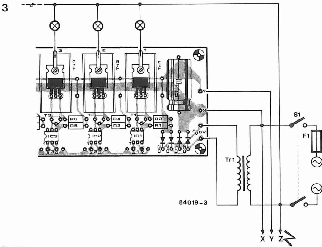
Figura 3. Usando un'unica scheda di controllo a triac unitamente al Generatore programmabile di figure luminose, il cablaggio di rete dovrà essere quello indicato.
