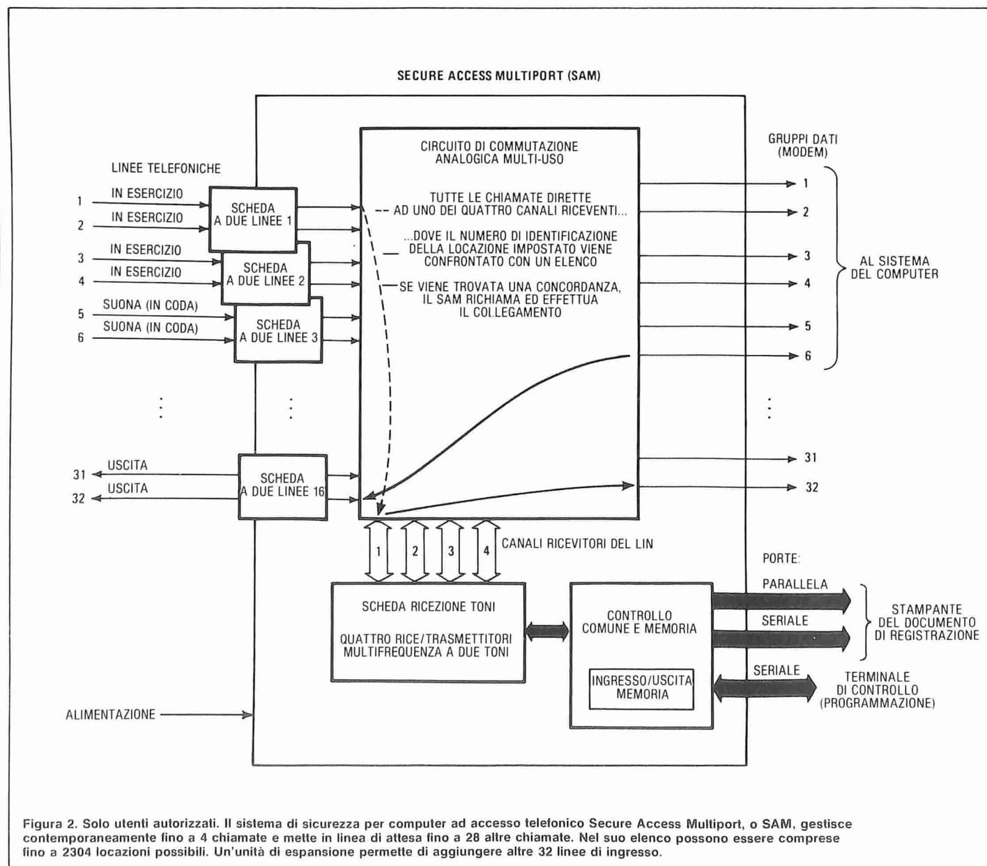
Figura 2. Solo utenti autorizzati. Il sistema di sicurezza per computer ad accesso telefonico Secure Access Multipoint, o SAM, gestisce contemporaneamente fino a 4 chiamate e mette in linea di attesa fino a 28 altre chiamate. Nel suo elenco possono essere comprese fino a 2304 locazioni possibili. Un'unità di espansione permette di aggiungere altre 32 linee di ingresso.
