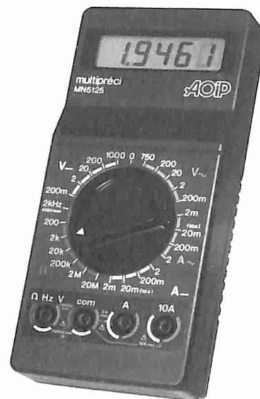
Le sue caratteristiche principali sono: precisione di base di  $5 \times 10^{-4}$ , risoluzione di 10  $\mu\text{V}$ , commutatore unico, alimentazione con normali pile a 9 V, completamente protetto in tutto il range.
