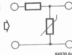
Figura 6. Alcune altre applicazioni del varistore: a: protezione di contatti, in modo analogo alla protezione di un tiristore; b: protezione del collettore in un motore c.c.; c: protezione di un circuito a ponte con carico induttivo; d: Regolazione o limitazione di tensione (taglio dei picchi).
