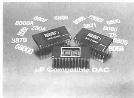
L'accuratezza dei DAC709 garantisce un errore di linearità di  $\pm 0,003\%$  FSR. La monotonicità è garantita su 14 bit in due campi di temperatura, da 0 a 70 °C (versione KH) e da -25 a 85 °C (versione BH). La deriva del guadagno è  $\pm 10$  ppm/°C (versione KH) e 7 ppm/°C (versione BH). Sono disponibili modelli con uscita in corrente o in tensione.
