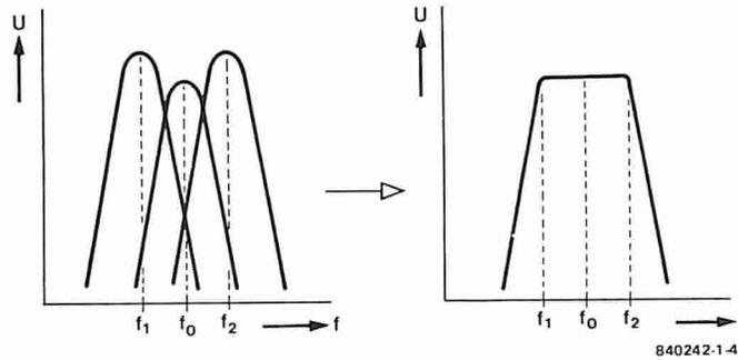
Figura 4. Questo schizzo mostra come è composto un filtro, collegando in serie tre filtri di banda. Il risultato è un filtro molto preciso, con sommità appiattita.
