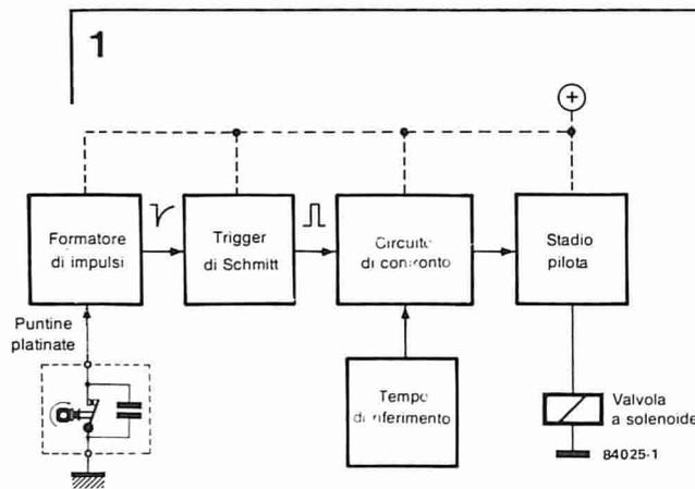
**Figura 1.** Questo schema a blocchi mostra le parti principali del circuito e dà un'idea del suo funzionamento. La velocità del motore viene rilevata e confrontata con un valore di riferimento: l'informazione viene usata per determinare se la valvola di intercettazione del getto del minimo dovrà essere aperta o chiusa.
