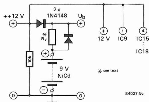
Figura 5. Alimentatore separato (a). L'indicazione del contatore può essere conservata mediante una batteria di riserva, formata da pile a secco (b) o da elementi al Ni-Cd (c).
