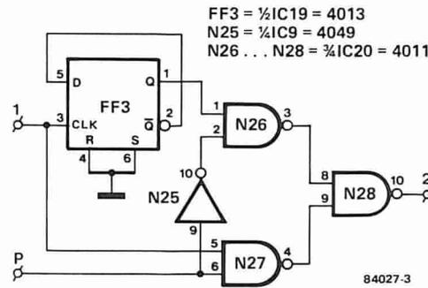
Figura 3. Questo circuito, inserito tra i punti 1 e 2 di Figura 2, rende il contatempo adatto per macchine a due velocità. "P" va a livello alto alla velocità più bassa del nastro, ed a livello alto in corrispondenza all'altra velocità.
