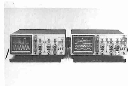
La sensibilità del trigger è stata aumentata, per quanto riguarda sia l'interno sia l'esterno, sia sulla base A sia sulla base B del 2215A.
