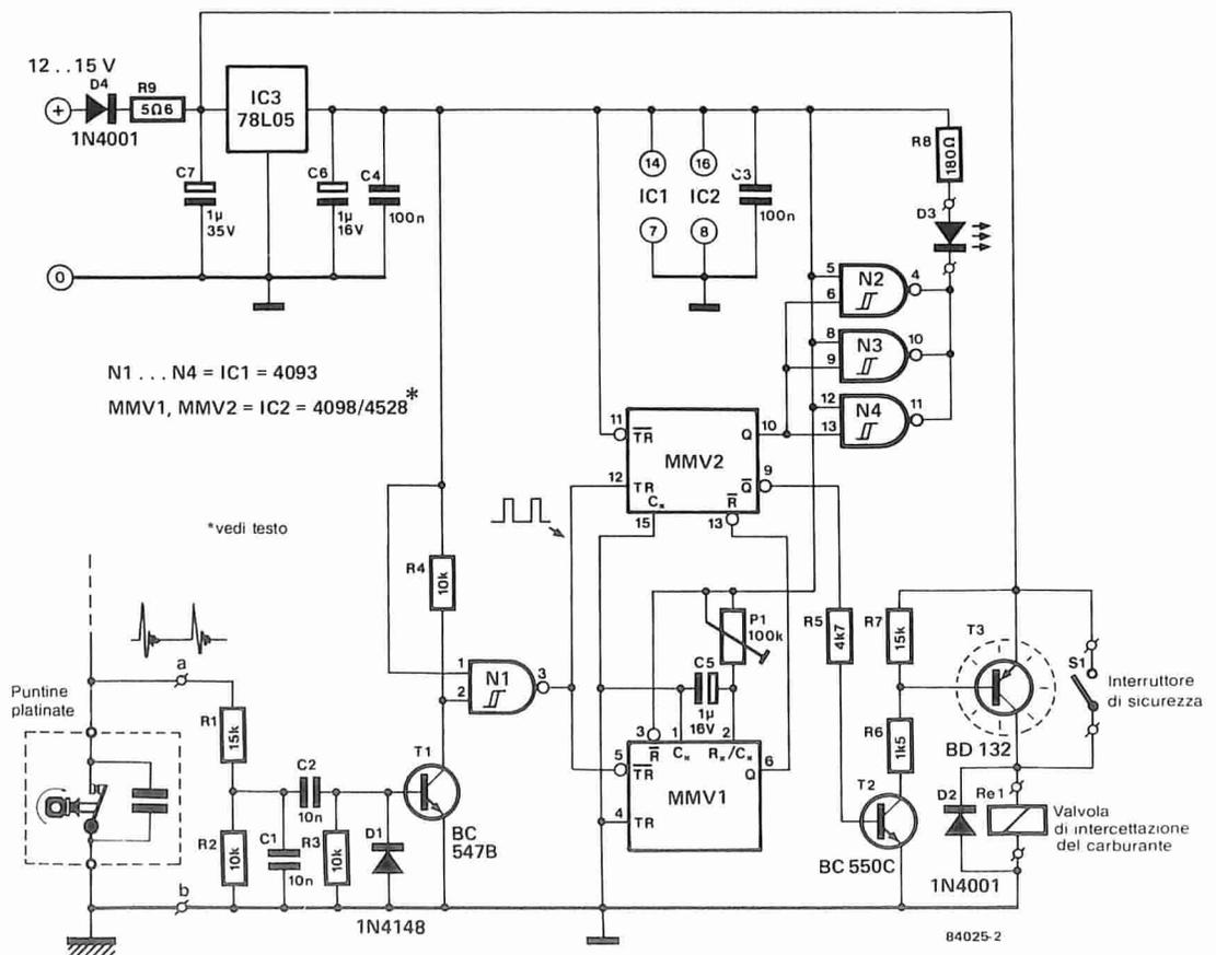
**Figura 2.** Il circuito qui mostrato impiega componenti comuni. Esso preleva l'alimentazione da una linea a 12 V dell'impianto elettrico dell'auto provvista di fusibili e rileva la velocità del motore a partire dalla frequenza del segnale proveniente dalle puntine platinare.
