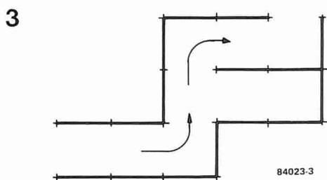
Figura 3. Tipica sezione di un labirinto.
