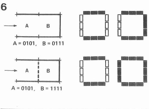
Figura 6. Un'altra piccola sezione del labirinto con la relativa indicazione del display. L'esempio in alto è un normale corridoio cieco e l'esempio in basso mostra un "trabocchetto".
