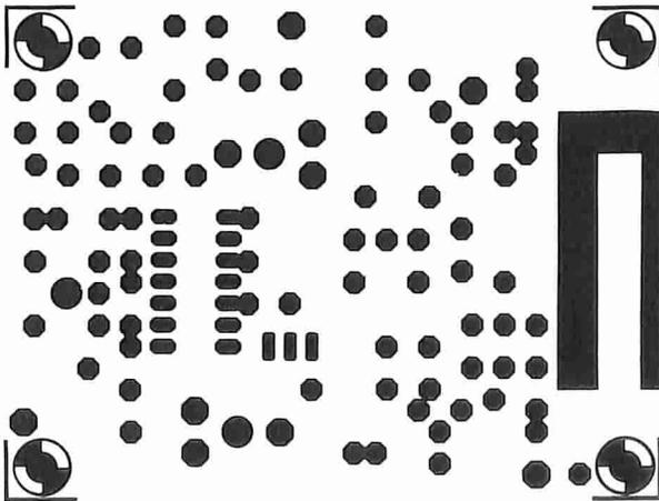
Figura 4. Il circuito stampato per il modulatore è a doppia faccia incisa. Tutti i collegamenti di massa dovranno pertanto essere saldati anche sul lato componenti. L'oscillatore a quarzo deve essere schermato con una lastrina di banda stagnata.
