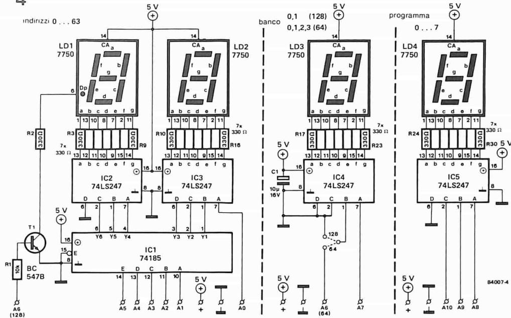
Figura 4. Gli indicatori degli indirizzi, dei programmi e dei banchi di memoria sono mostrati in questo schema. Le linee di indirizzamento sono collegate a quelle del circuito principale di Figura 3.
