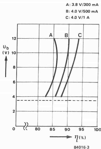
Figura 3. Curve caratteristiche che mostrano il rendimento di tre diversi tipi di lampada rispetto alla tensione di batteria: il rendimento aumenta con l'aumento della corrente assorbita dalle lampade.
