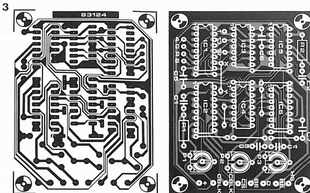
Figura 3. Circuito stampato e disposizione dei componenti per il box di sincronismi video.
