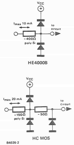
**Figura 2. Circuiti di protezione di ingresso per integrati HCMOS e CMOS.**
