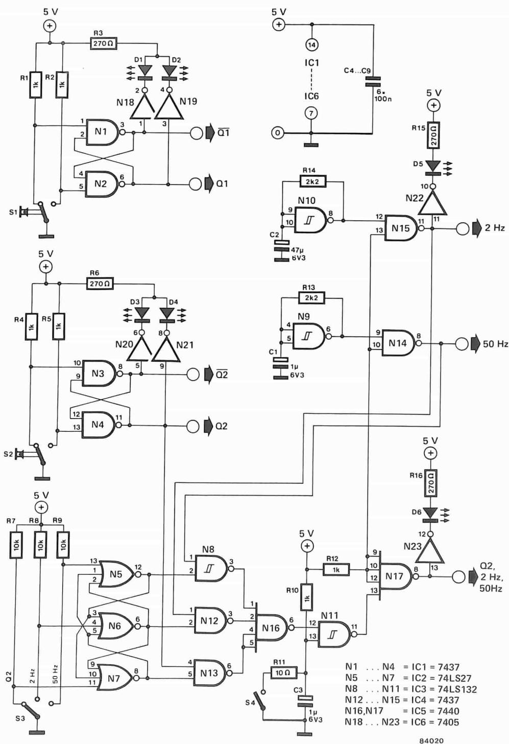
mediante un regolatore da 5 V: un tipo da 500 mA andrà benissimo. La tensione di alimentazione per ciascuno dei circuiti integrati dovrà essere singolarmente disaccoppiata mediante un condensatore da 100 nF. E' meglio inserire l'alimentatore in un mobiletto, insieme al digitester, in modo da poter avere uno strumento di prova per circuiti
