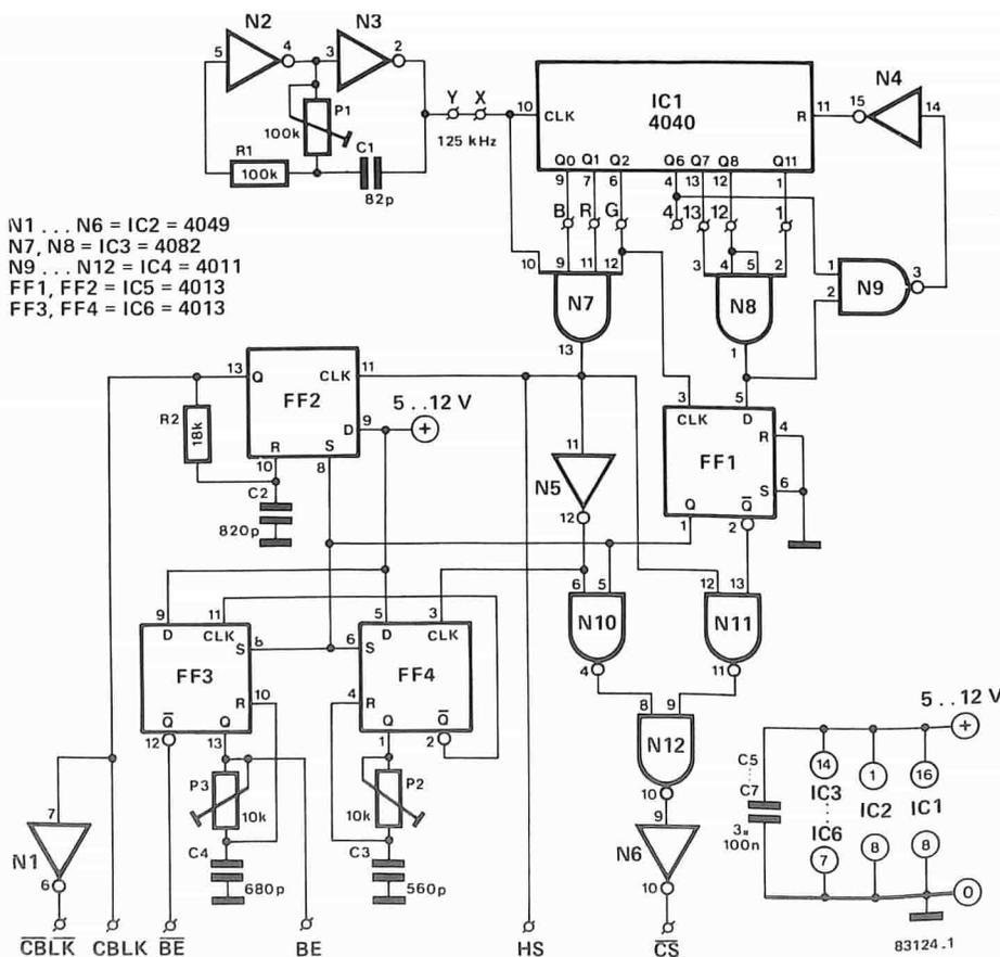
di circa 4 microsec. L'impulso di sincronismo di quadro viene ricavato direttamente dal segnale di sincronizzazione di riga, invertendo quest'ultimo durante l'intervallo di sincronizzazione di quadro. Il vantaggio di questo sistema è che il segnale di sincronizzazione di riga rimane stabile durante la sincronizzazione di quadro. I circuiti elettronici del televisore garantiscono automaticamente che il sincronismo di riga invertita sia riconosciuto come sincronismo di quadro.
