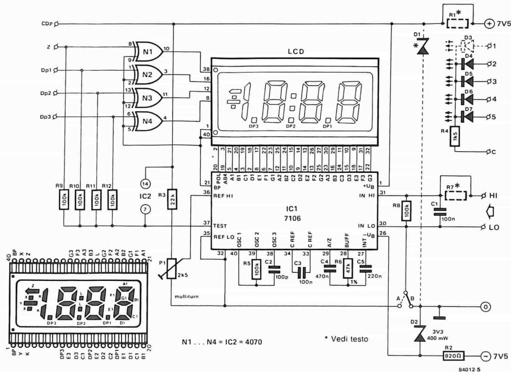
Figura 5. Il voltmetro digitale nella familiare configurazione con IC1 ed un LCD. Questo circuito può essere usato in modo indipendente, come strumento da pannello LCD.
