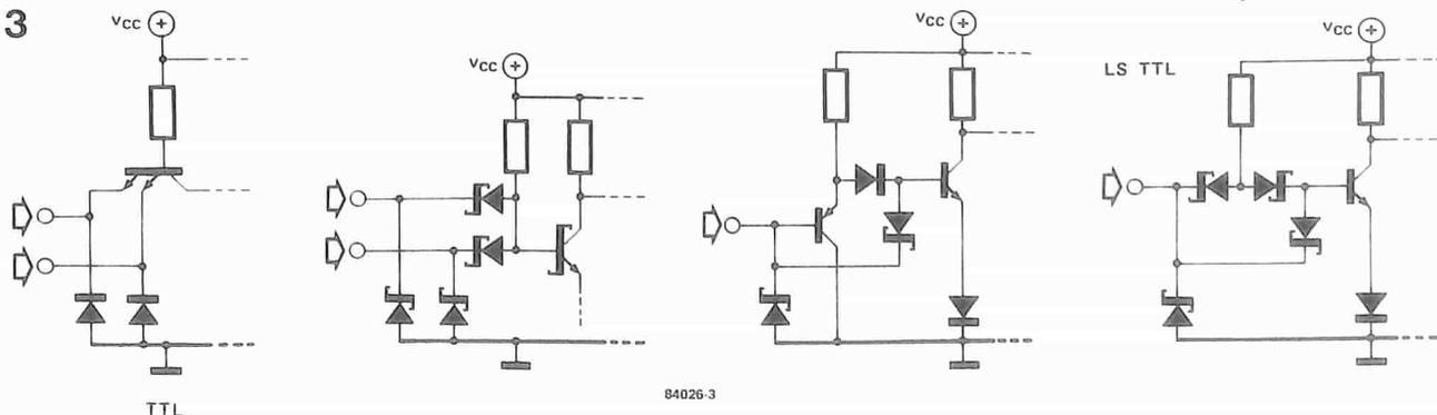
Ne consegue che non è possibile collegare direttamente i CMOS ai TTL, anche se i loro livelli di tensione sono simili. Esistono tuttavia alcuni circuiti integrati CMOS con uscite bufferizzate, che possono assorbire anche una corrente di 1,6 mA. Altrimenti le uscite dei CMOS potrebbero anche essere collegate in
