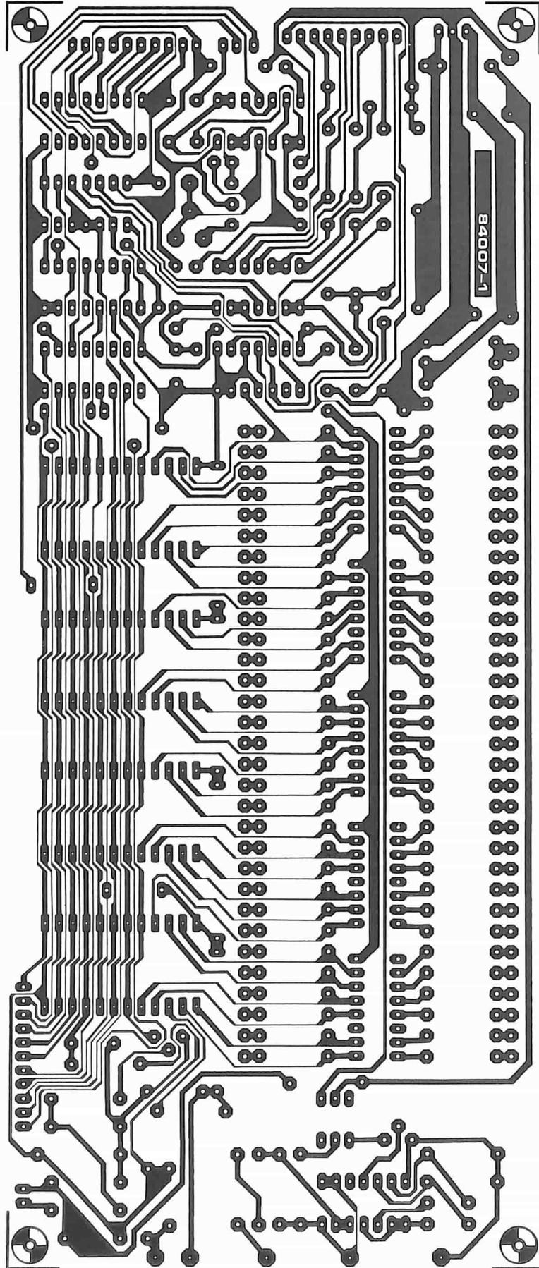
Figura 5. Piste di rame e disposizione dei componenti del circuito stampato sul quale montare lo schema di Figura 3.
