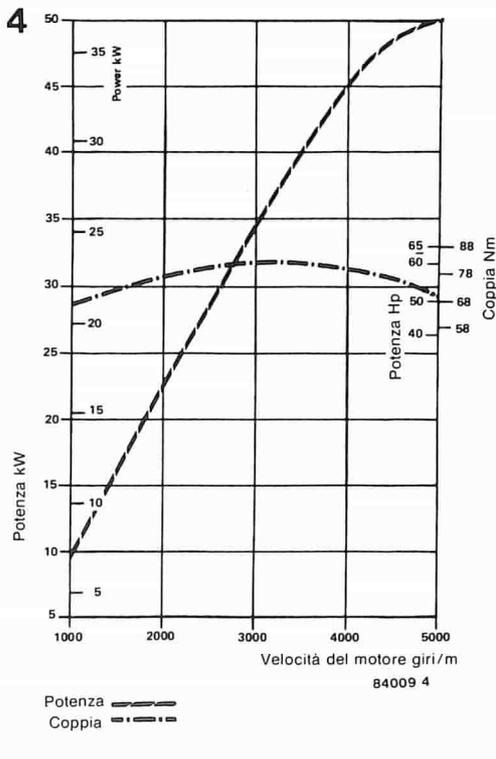
Figura 4. Le curve potenza/giri e coppia/giri, qui illustrate, dicono molte cose circa il modo in cui funziona un motore. Un breve studio di queste curve può aiutare un guidatore a fare un uso "intelligente" del contagiri.
