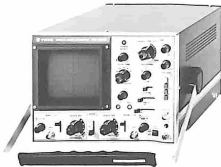
Dotato di linea di ritardo sullo sweep (un sistema della Trio che sfruttando una base dei tempi singola si basa su un ritardo di trigger), questo oscilloscopio è indicato per osservazione e misurazione di segnali singoli molto veloci o di forme d'onda complesse come segnali video. La linea di ritardo ha 5 portate, da 1  $\mu\text{s}$  a 100 ms (come regolazione intermedia) ed è inserita contemporaneamente all'intensificazione traccia.
