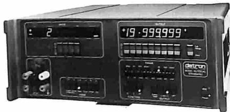
Il mod. 4000 è completamente programmabile tramite interfaccia GPIB IEEE 488.
