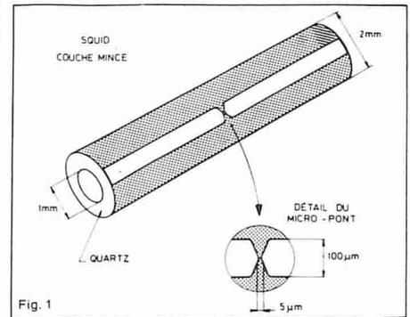
periodicamente in funzione del flusso applicato. Per mettere in evidenza queste variazioni, lo SQUID è accoppiato magneticamente ad un circuito risonante LC, ciò si misura l'impedenza dello SQUID in radiofrequenza.
