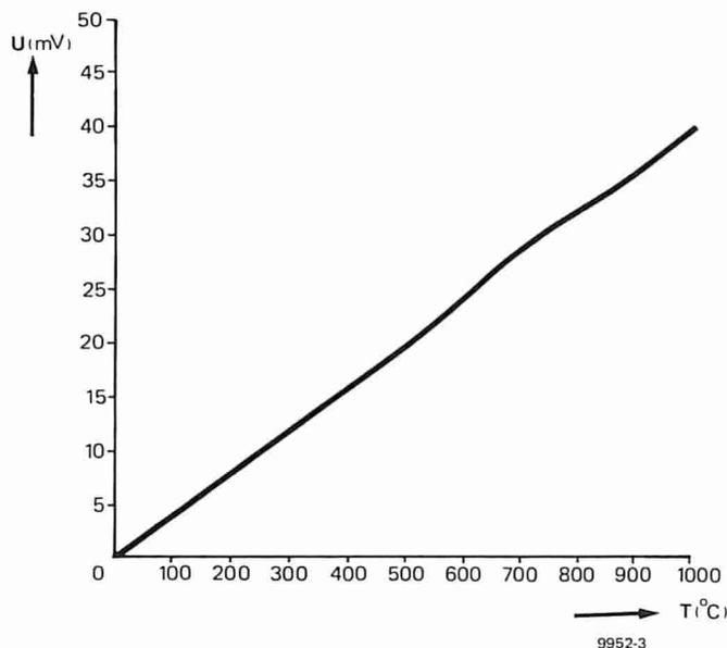
Figura 3. La caratteristica temperatura-tensione di una termocoppia nichel-cromo/nichel-alluminio (il tipo usato, ad esempio, nei saldatori Antex). Come è evidente, la risposta è virtualmente lineare nel campo di temperature usate in questa applicazione specifica.
