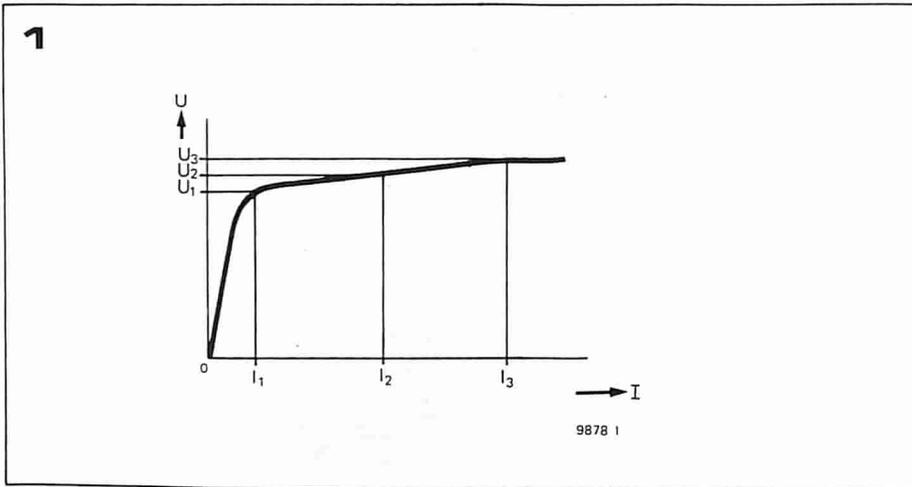
Figura 1. Curva tensione/corrente caratteristica di un diodo zener. Solo quando è stata raggiunta la tensione di "breakdown", la tensione di zener è pressoché indipendente dalla corrente.
