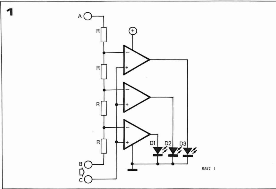
Figura 1. Principio di funzionamento dell'UAA 180. Una serie di comparatori di tensione misurano la tensione in ingresso confrontandola con le tensioni di riferimento ricavate da un partitore di tensione. Quando la tensione in ingresso supera una tensione di riferimento, il LED corrispondente si illumina.
