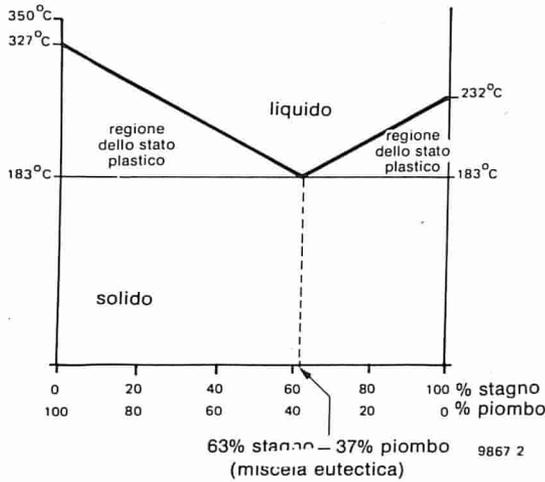
ra; piuttosto, in un certo intervallo di temperatura, essa assumerà consistenza "plastica". Ciò è illustrato in figura 2.
