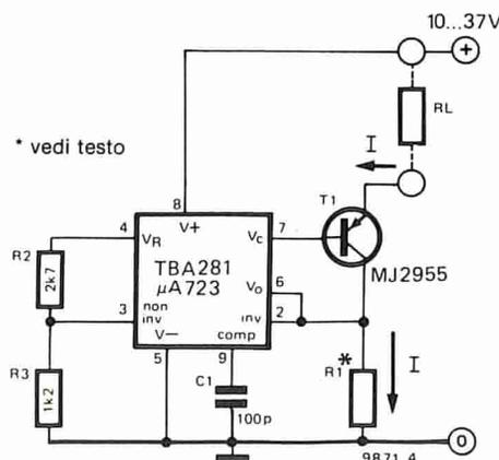
invertente dell'amplificatore differenziale. Se si userà invece un transistor PNP, si renderà necessaria una piccola modifica al circuito:  $V_{oe}$  e l'ingresso invertente saranno
