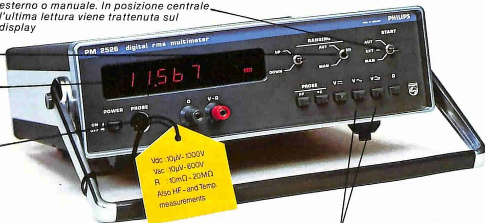
Le misure del valore efficace reale possono essere con accoppiamento in c.a. per misurare solo i segnali a.c. o con accoppiamento c.c. per misurare segnali c.a. più una componente c.c. sovrapposta.
