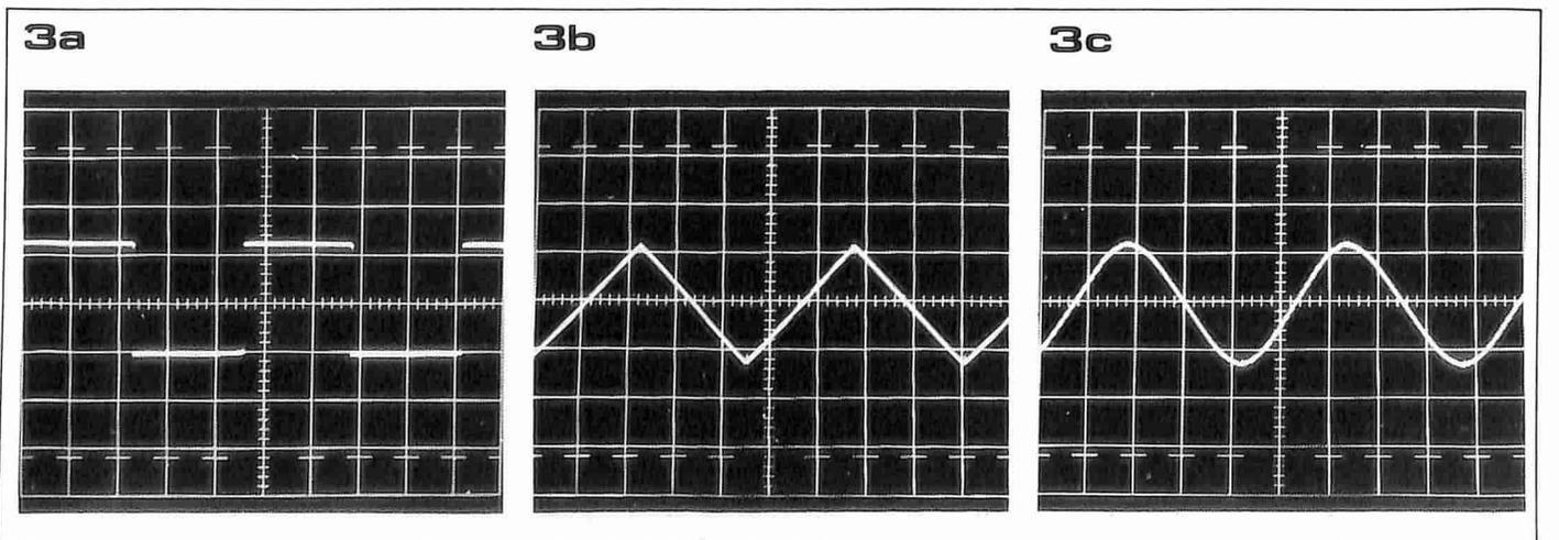
ca corrente, ma al di sopra di questo voltaggio la loro resistenza dinamica cade ed essi limitano picchi e depressioni del segnale triangolare in modo logaritmico, producendo un'approssimazione di onda sinusoidale. L'uscita sinusoidale è inviata per mezzo di C5 e R10 verso l'ingresso dell'amplificatore d'uscita.
