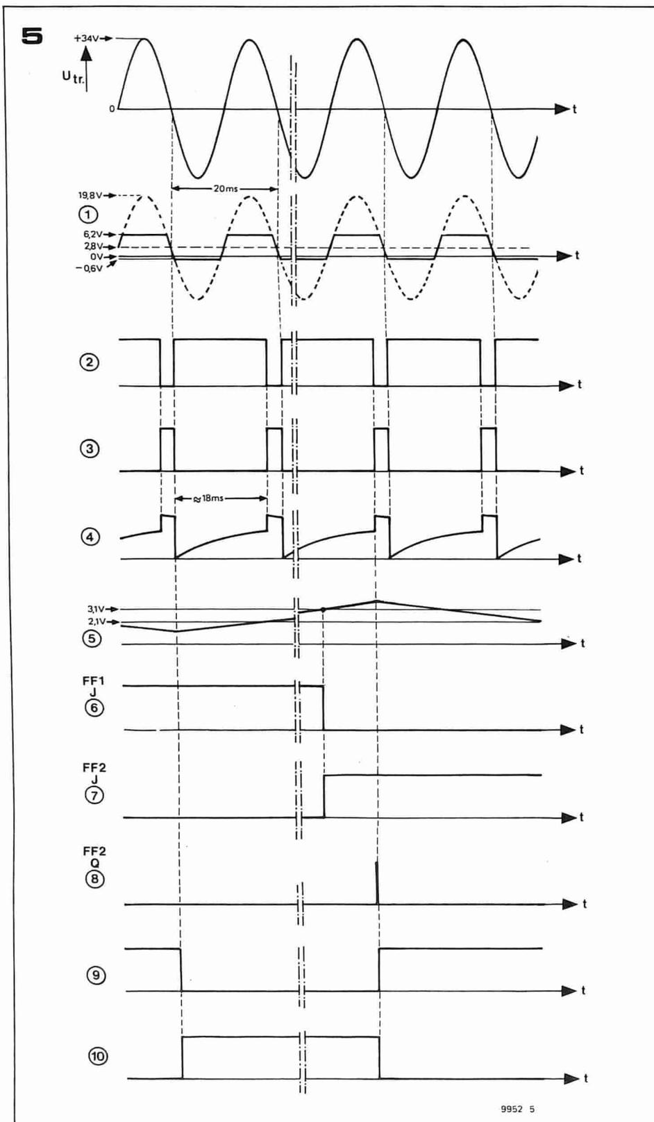
pra al contenitore dell'unità di controllo. La corrente passante attraverso P 2 e R 6 può essere variata per mezzo di P 1. P 2 determina la grandezza della tensione di riferimento all'ingresso invertente di IC 1. La termocoppia è connessa tra l'ingresso non invertente di IC 1 e il nodo tra R 3 e R 6. In questo modo la differenza di tensione agli ingressi del comparatore corrisponde alla differenza esistente tra la tensione ricavata da R 6 più P 2 e quella fornita dalla termocoppia.
