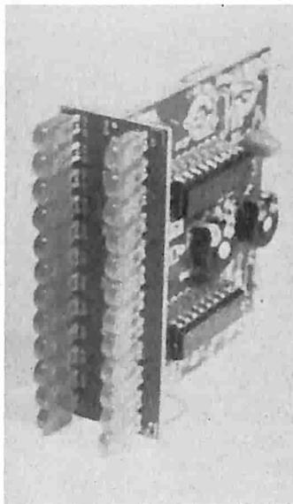
Usando solo un circuito integrato (IC) e pochi componenti discreti è possibile costruire un circuito pilota per un PPM, che fornirà una indicazione su scala logaritmica del livello di entrata di picco AC. Il circuito può essere usato con il voltmetro a LED con UAA 180 per formare un PPM compatto a due canali.
