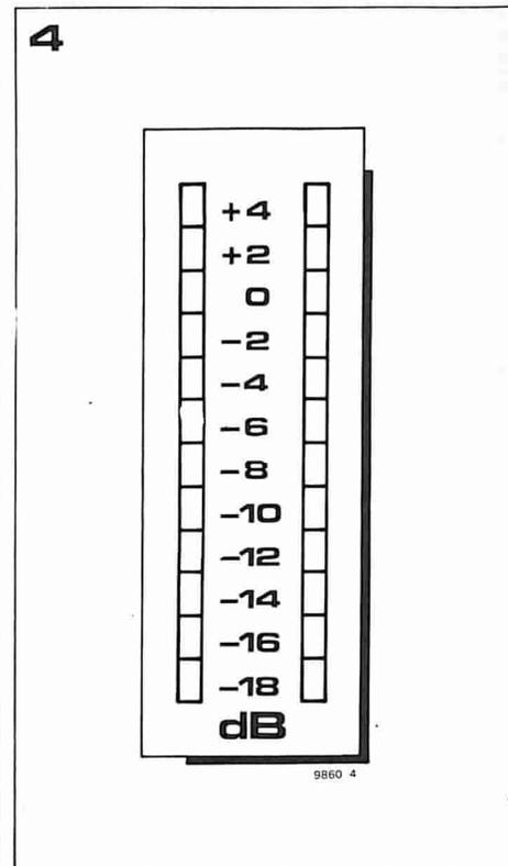
di ogni canale. Questa dipenderà ovviamente dall'applicazione desiderata per lo strumento. La scala del misuratore può essere calibrata in modo lineare da -18 a +4 dB, segnando in rosso la porzione della scala superiore a 0 dB per indicare il sovraccarico. Se si usa il voltmetro LED, allora i LED verdi possono essere usati fino a -2 dB, e i LED rossi da 0 a +4 dB in modo tale che una condizione di sovraccarico possa essere vista facilmente.
