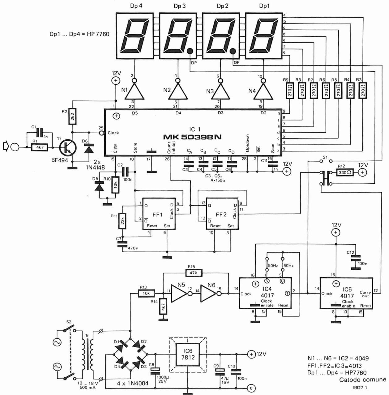
contatori in preparazione del successivo ciclo di conteggio, ma non ha effetti sulla memoria, così che il risultato della misura non viene perso. Il diodo D5 protegge l'ingresso di "clear" dell'integrato rispetto ad impulsi di polarità negativa.
