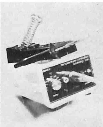
Il circuito descrive un'unità di controllo termostatico che è semplice da costruire ed impiega componenti standard.
