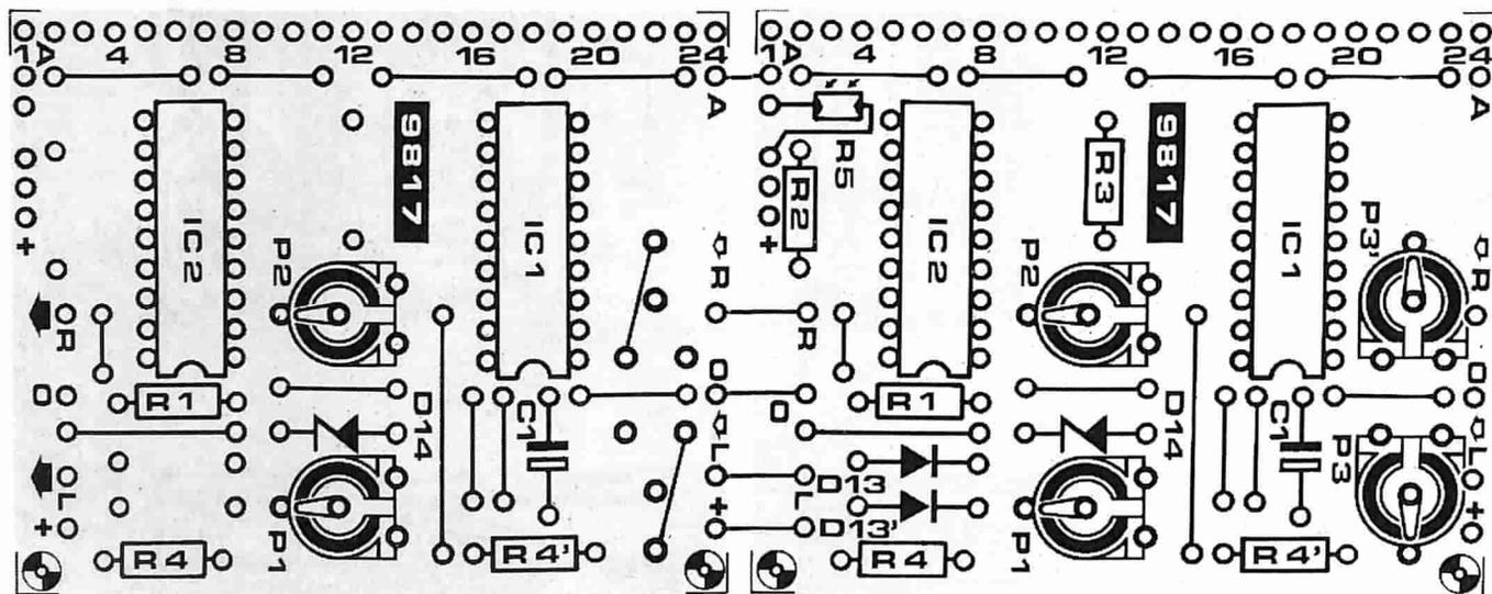
basetta di sinistra della figura 5. E' anche necessario piazzare dei collegamenti al posto degli omessi P3 e P3' come mostrato in figura, e collegare le adiacenti connessioni +, 0, L, R e A sulle due basette.
