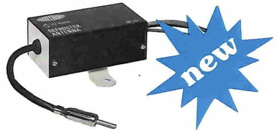
La possibilita' di sostituire la tradizionale antenna sulle autovetture e' diventata una necessita' per quanto concerne la manomissione dell'installatore e una certa sicurezza contro coloro che, osservando un'antenna sulla vettura, ne deducono il contenuto. Questo apparecchio dotato di appositi filtri, consente di usufruire del dispositivo termico del lunotto retrovisore quale elemento d'antenna. Facile da installare all'interno dell'autovettura e non richiede nessuna tensione di alimentazione.
