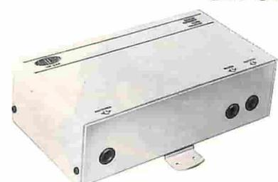
Questo ricevitore in unione al trasmettitore UK 943 forma un dispositivo di comando a distanza applicabile a cancelli, porte, saracinesche, ecc. Il sistema di ricezione con segnale codificato con 4095 combinazioni diverse rende sicuro il dispositivo di comando.
