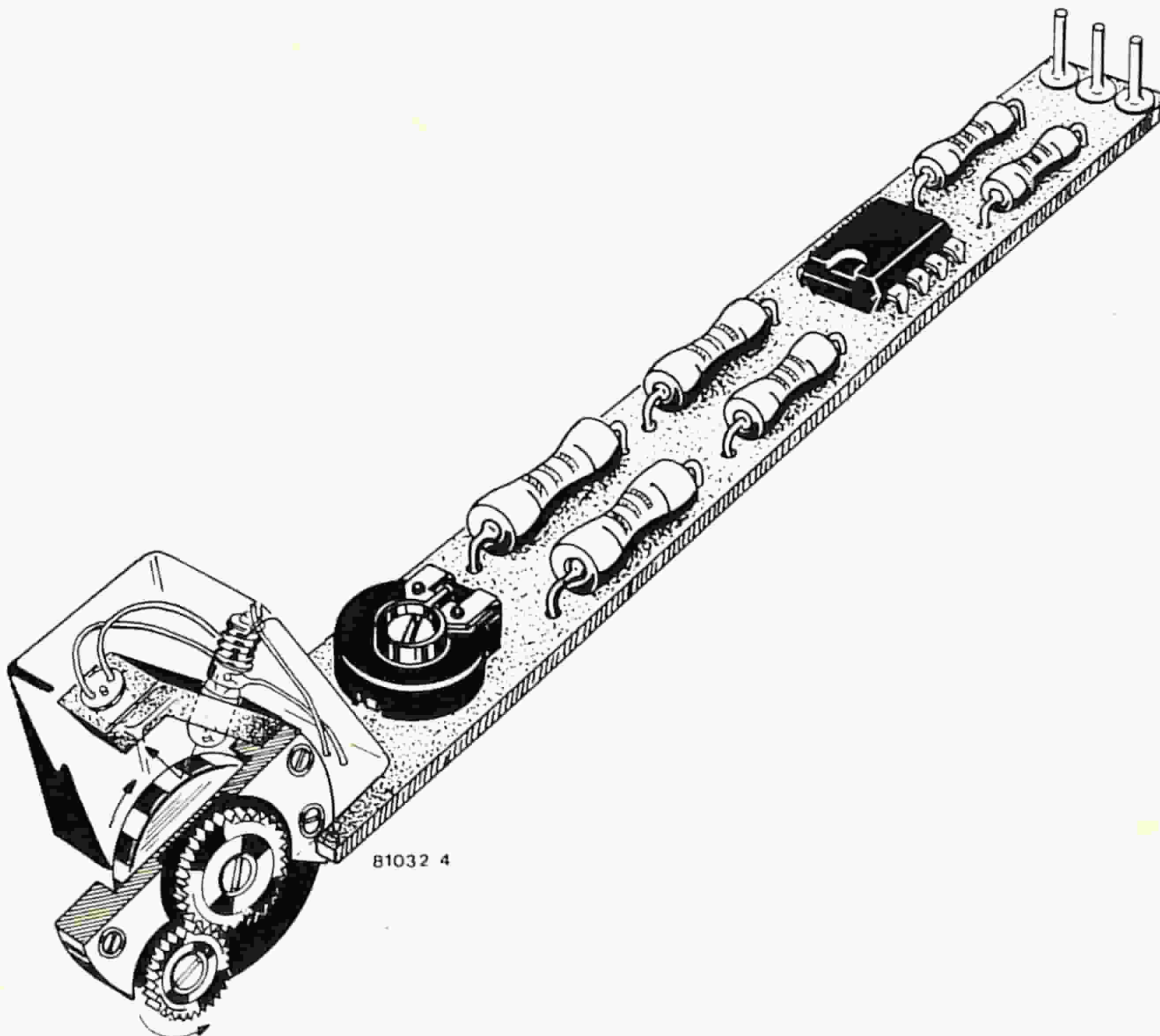
Figura 4. Un prototipo di sensore "fatto in casa". È stato costruito utilizzando i pezzi di un vecchio orologio.
