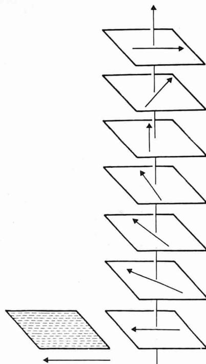
Figura 3. Rappresentazione del posizionamento delle molecole in un cristallo liquido colesterico. Le frecce rappresentano la direzione dell'asse maggiore delle molecole in ciascuno strato.
