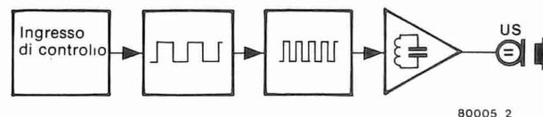
Figura 2. Schema a blocchi del trasmettitore.
