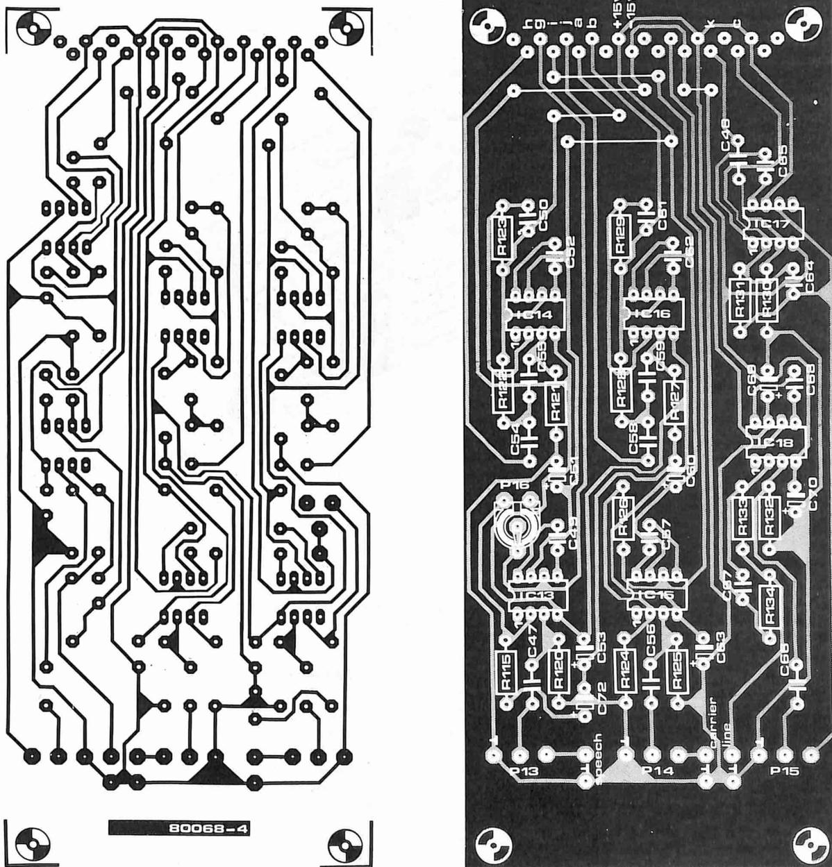
Figura 6. Circuito stampato, lato rame e lato parti, per il modulo d'ingresso/uscita.
