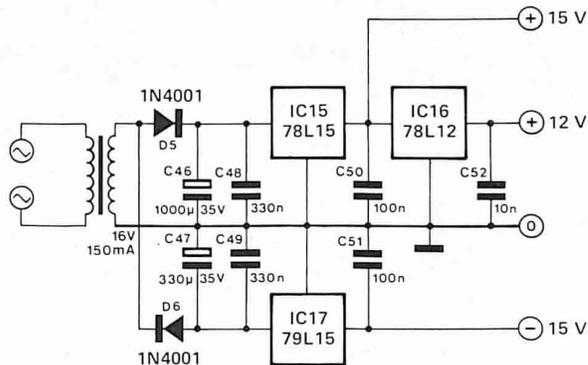
Figura 3c. Alimentatore regolato per Il Chorosynt che è incluso nel circuito stampato generale.
