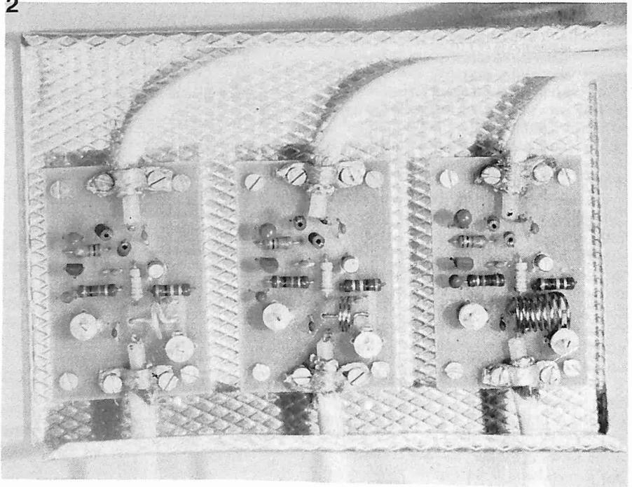
Fotografia 2. Una combinazione tipica di tre boosters (centralino) che mostra come si devono collegare correttamente i cavi coassiali al circuito stampato.
