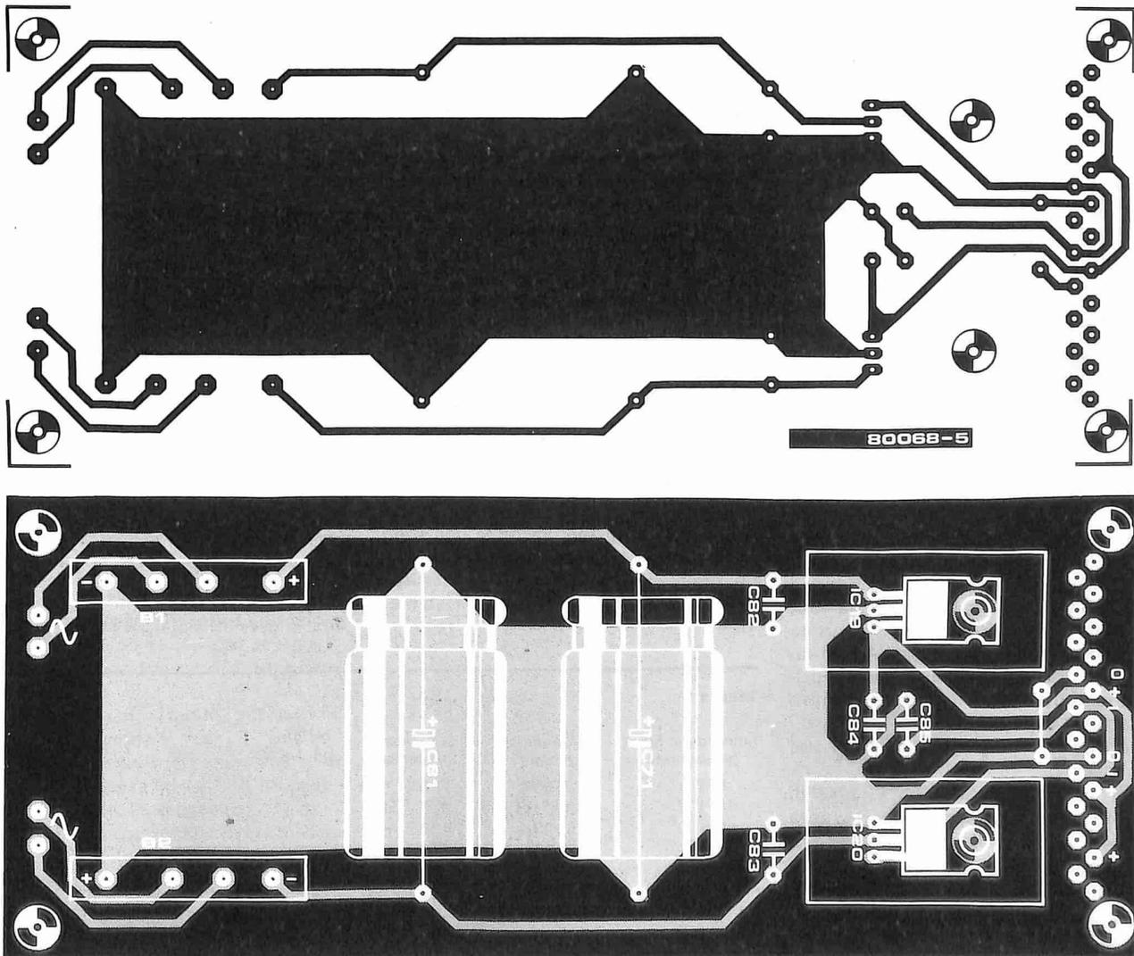
Figura 2. Circuito stampato dell'alimentatore. Come è spiegato nel testo, su questo pannello trova spazio solamente l'alimentazione da  $\pm 15$  V, mentre il riduttore di tensione stabilizzato a  $\pm 5$  V è montato sulla basetta "bus board".
