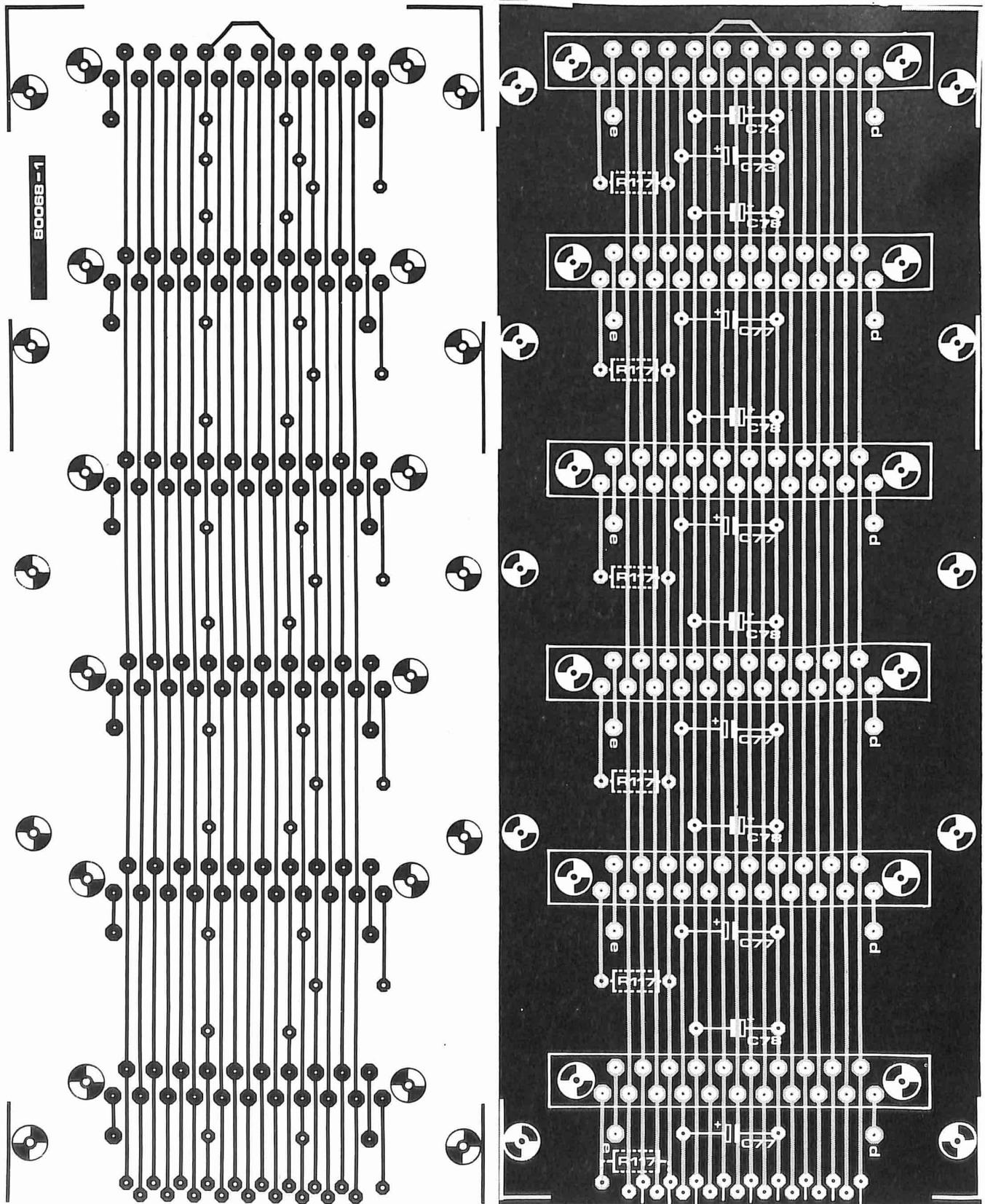
Figura 9. Il "bus board" è diviso in due settori, che devono essere interconnessi con dei ponticelli di filo nudo, rigido. L'intero "board" non solo porta gli undici connettori "femmina", ma anche il riduttore di tensione che eroga  $\pm 5V$ , i vari condensatori di disaccoppiamento ed alcuni capicorda che possono servire per possibili ed opzionali circuiti aggiuntivi, da studiare in un secondo tempo.
