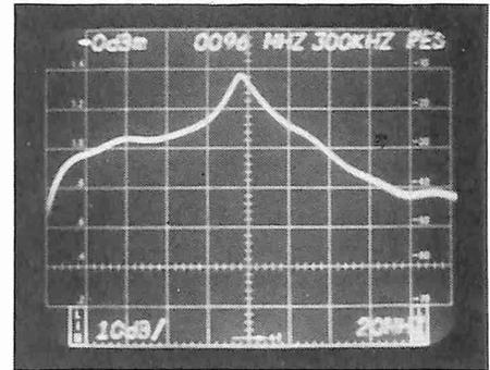
Fotografia 3. Guadagno del booster in funzione della frequenza con il filtro selettivo all'ingresso regolato per la banda degli 87,5 ... 104 MHz.
