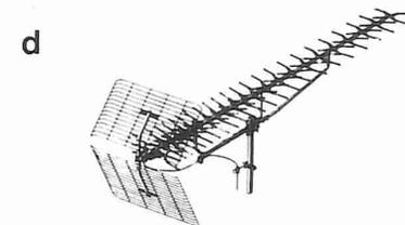
Figura 6. Un'antenna efficiente è il miglior amplificatore RF. I sistemi multielementi possono erogare un segnale più ampio del semplice dipolo pur senza generare alcun rumore inerte. Ciò è evidenziato dal grafico di figura 6a, che mostra il guadagno offerto dall'antenna come funzione del numero degli elementi. Le figure da 6b a 6d illustrano le antenne seguenti:
