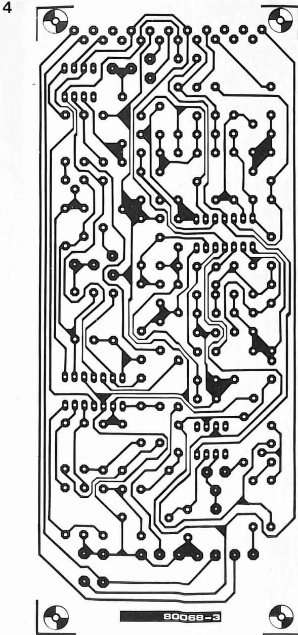
Figura 4. Basetta universale per i filtri. Lato rame.
