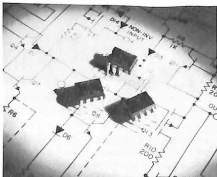
I dispositivi della serie CA080 vengono forniti in una vasta gamma di packages, che comprende il tipo DIP plastico a 8 terminali, il DIP a 14 terminali e il TO-5 a 8 terminali.
