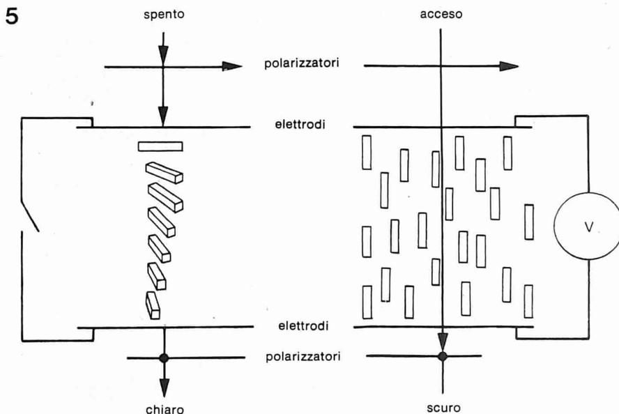
Figura 5. Il cambiamento nella disposizione molecolare quando il cristallo liquido nematico è polarizzato elettricamente, dalla condizione di trasparenza a corrente staccata (a sinistra) alla condizione opaca (a destra). Quando il campo elettrico è staccato, avviene rapidamente il ritorno allo stato primitivo di trasparenza, a motivo di forze che partono dalle superfici.
