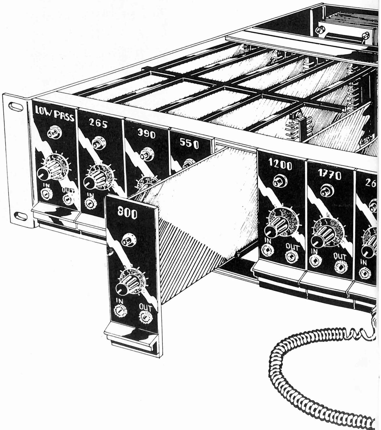
Figura 10. Tutti i moduli sono progettati in modo da poter essere compresi in un rack da diciannove pollici standard. I moduli sono ad innesto, e penetrano dall'area frontale, riempiendola esattamente. Il trasformatore d'alimentazione ed il pannello alimentatore, sono fissati sulla lamiera di fondo.
