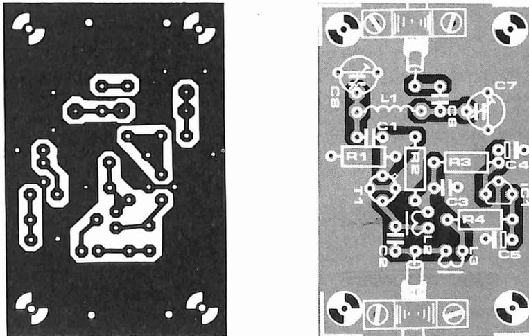
Figura 8. Circuito stampato relativo allo schema di figura 7. Lato rame e lato parti.
