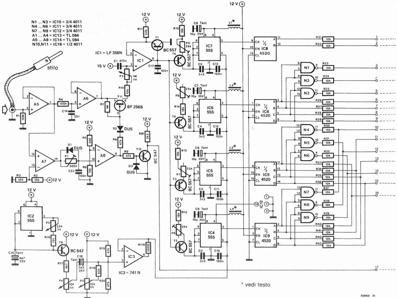
Figure 3a e 3b. Circuito principale del Chorosynt esposto in due settori per chiarezza.
