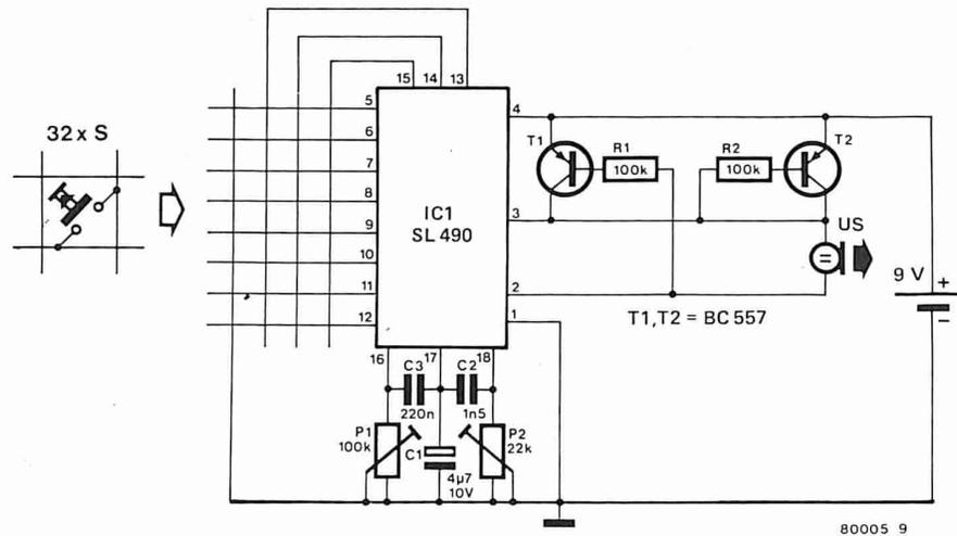
Figura 9. Il trasmettitore "completamente integrato".
