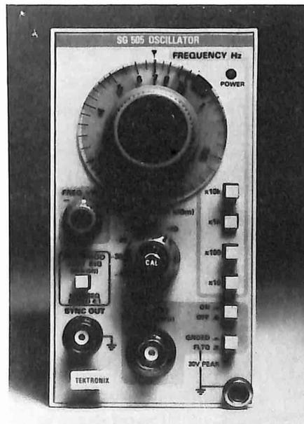
La costanza del livello (riferita a 1 kHz) è pari a +0,1 dB fra 20 Hz e 20 kHz ed a +0,2 dB nell'intero campo compreso fra 10 Hz e 100 kHz.
