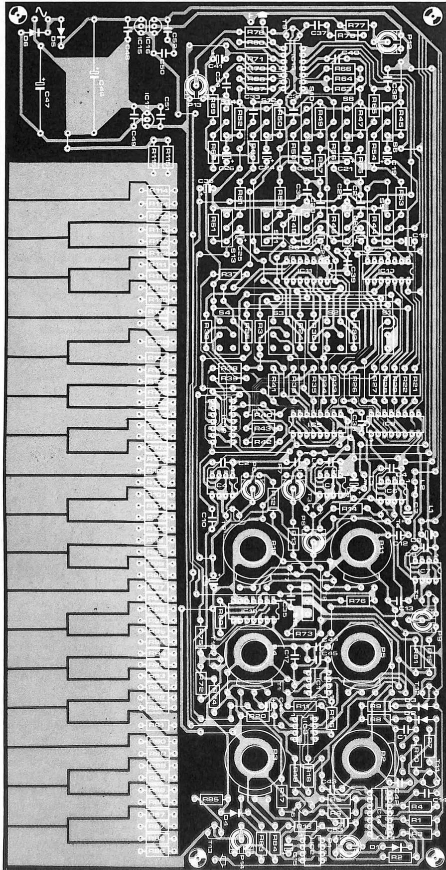
Figura 5. Circuito stampato del Chorosynt lato parti. Per poter rientrare nella pagina, il piano è ridotto in scala.
