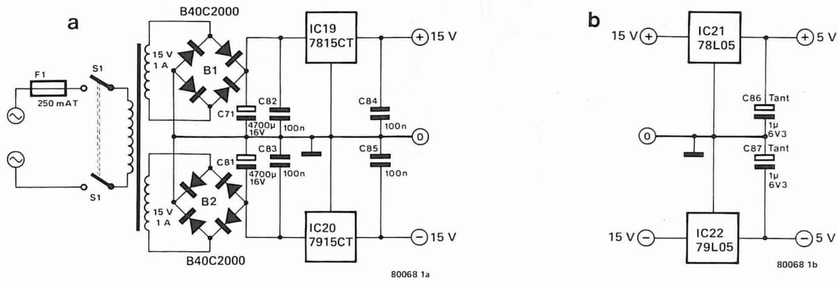
Figura 1. L'alimentazione del vocoder è molto semplice. Anche se la potenza erogata è quella che serve, per il momento, non è male l'idea d'impiegare un trasformatore d'alimentazione più potente, sicché si possano eventualmente coprire le esigenze introdotte da possibili estensioni future del progetto.
