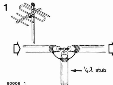
Figura 1. Il filtro è un tratto di cavo coassiale, inserito nel cavo che congiunge l'antenna all'amplificatore a larga banda. In pratica, è spesso meglio collegare lo stub ad  $1/4 \lambda$  all'ingresso dell'amplificatore.
