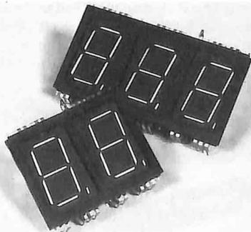
I display hanno il punto decimale a destra e possono essere saldati direttamente sulle schede a circuito stampato o montati su zoccoli a striscia.
