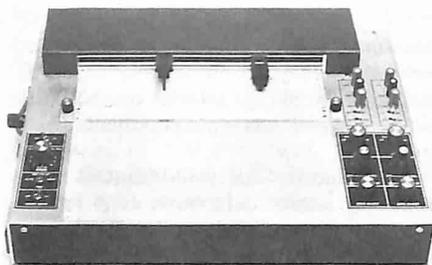
Le caratteristiche standard di questi registratori a carta comprendono l'impiego di penne di fibra con scrittura molto nitida, 16 range calibrati da 1 mV a 100V (con attenuatore variabile commutabile), switch on/off di ingresso e di polarità inversa, 12 velocità della carta selezionabili da 12 mm/min. a 500 mm/min, comando della carta a distanza, sollevamento del pennino elettrico, e shut down automatico per segnali over-range.
