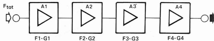
$$F_{tot} = F_1 + \frac{F_2-1}{G_1} + \frac{F_3-1}{G_1 \cdot G_2} + \frac{F_4-1}{G_1 \cdot G_2 \cdot G_3}$$
