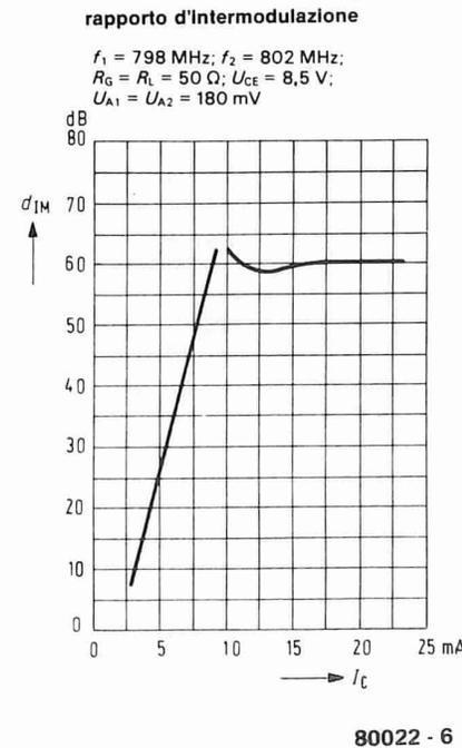
Figura 6. Rapporto d'intermodulazione ad un livello d'uscita di 180 mV, come funzione della corrente di collettore.
