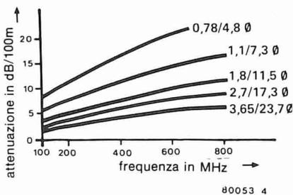
Figura 4. L'attenuazione introdotta dai cavi coassiali aumenta con la frequenza. La qualità dei cavi dipende in buona misura dal diametro del conduttore interno e dal diametro della calza schermante. Il grafico mostra l'attenuazione introdotta dal cavo in funzione della frequenza per cinque modelli diversi di cavo variamente realizzati, con le sezioni dei conduttori ed i diametri degli schermi.
