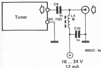
Figura 9a. Circuito adattatore da collocare al termine basso del cavo di raccordo per alimentare il tuner tramite il capo isolato del coassiale.
