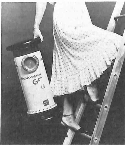
I parametri nominali di funzionamento sono 200 KV - 8 mA che consentono di radiografare in un minuto spessori di acciaio di 22 mm: con esposizioni più lunghe si possono raggiungere i 35 mm.
