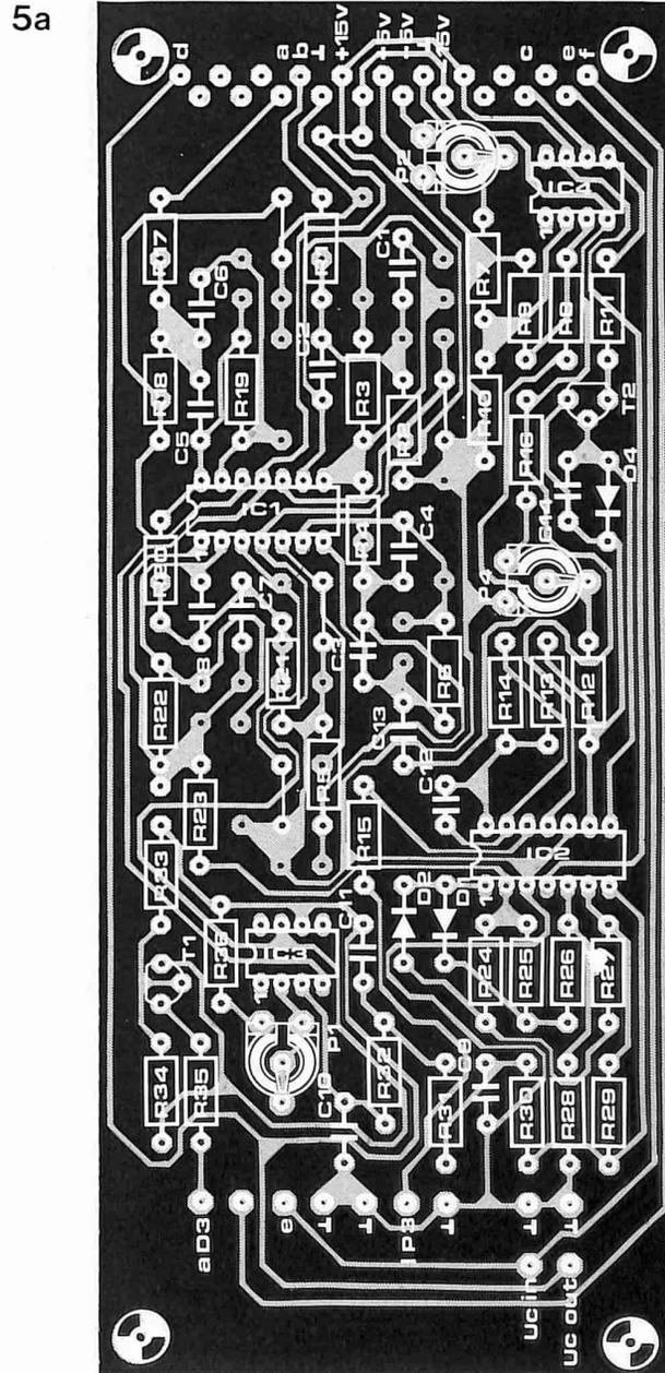
Figura 5. I filtri impiegano disposizioni diverse per le parti; quelle dei passabanda appaiono nella figura 5a; quelle dei passabasso nella figura 5b, ed infine quelle del passa-alto nella 5c. (Per le figure 5b e 5c si vedano le pagine seguenti).
