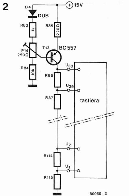
Figura 2. Sorgente ad intensità costante e divisore di tensione concatenato per la tastiera del Chorosynt.
