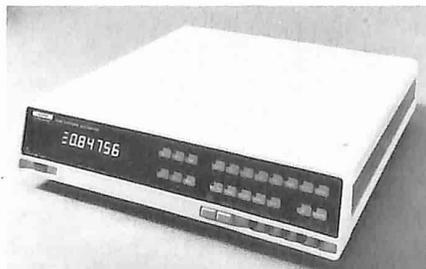
Con una risoluzione di  $3 \frac{1}{2}$  digit, si ottengono frequenze di lettura di 280 letture/secondo.
