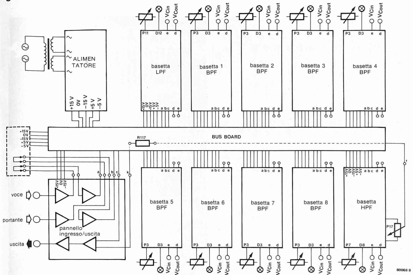
Figura 8. Schema a blocchi del vocoder completo. Le indicazioni a, b, c, d, e k, corrispondono a quelle tracciate nello schema elettrico apparso nella prima parte. Le stesse indicazioni compaiono anche nei circuiti stampati.
