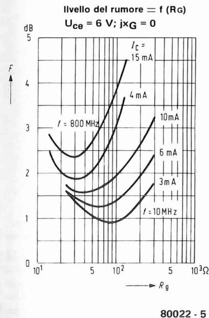
Figura 5. Livello del rumore generato dal BFT 66 come funzione della resistenza di emettitore, per diverse correnti di collettore prefissate, da 10 a 800 MHz. Si ha un minimo di curva piatta nei pressi dei valori di 50 e 75  $\Omega$ .
