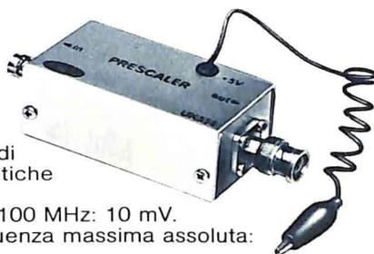
Utile per aumentare la sensibilità e la frequenza di utilizzo di frequenzimetri con scarse caratteristiche d'ingresso. Alimentazione: 5 Vc.c.
