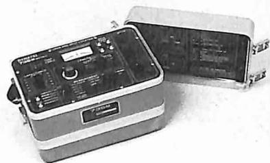
difetti sulle guaine. Esso è formato da un emettitore e da un ricevitore e permette di far passare un segnale radio su un cavo telefonico.
