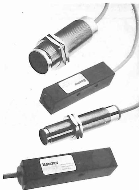
zionanti a 6 kHz nel trasmettitore e l'amplificatore d'impulsi nel ricevitore garantiscono un'ottima soppressione dei disturbi. L'interruttore di prossimità fotoelettrico Baumer può quindi essere usato in qualsiasi condizione di luce od oscurità ambientale.
