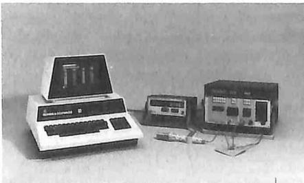
Il controllore di processo PPC può essere collegato agli altri componenti del sistema di test, quali strumenti di misura, unità di controllo e altre periferiche (estensione della memoria, stampante, plotter) attra-
