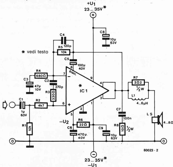
Figura 2. Amplificatore di potenza completo che impiega o il modulo OM931, o il modulo OM961. Il circuito è un progetto Philips.
