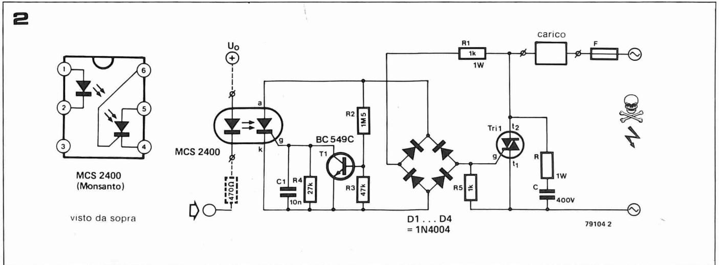
ottico. Quando attraverso il LED circola una corrente che lo accende, il fototransistore conduce.
