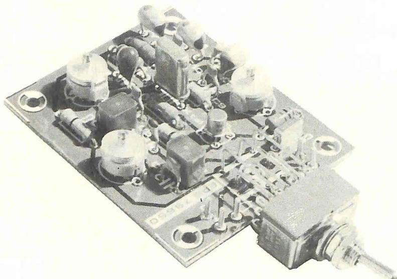
**Questo semplice convertitore per onde corte, controllato a cristallo, è previsto per essere impiegato in unione ad un ricevitore convenzionale per onde medie; ad esempio un autoradio. La banda preferita delle onde corte, è direttamente convertita come frequenza sulla banda delle onde medie, ed in tal modo, il ricevitore usuale MW, lo si usa come se fosse previsto per le onde corte.**
