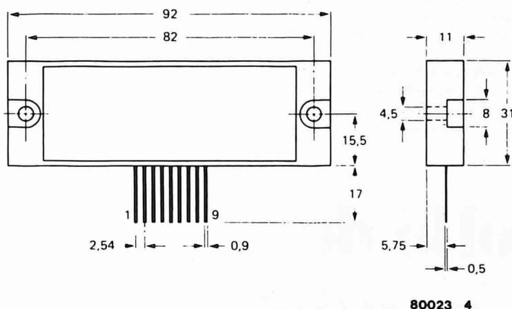
Figura 4. Dimensioni e meccanica dei moduli OM931 e OM961.
