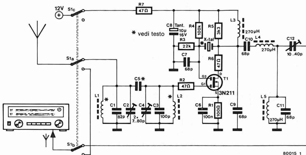
Figura 1. Circuito completo del convertitore per onde corte.
