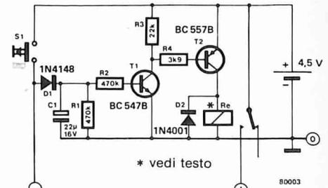
C1 si scarica lentamente in R1, R2 e la giunzione base-emettitore di T1; sono necessari alcuni secondi affinché la tensione ai suoi capi scenda ad un valore sufficientemente basso per portare T1 in interdizione. Quando ciò succede, il relais si diseccita, togliendo l'alimentazione al circuito del gioco.
