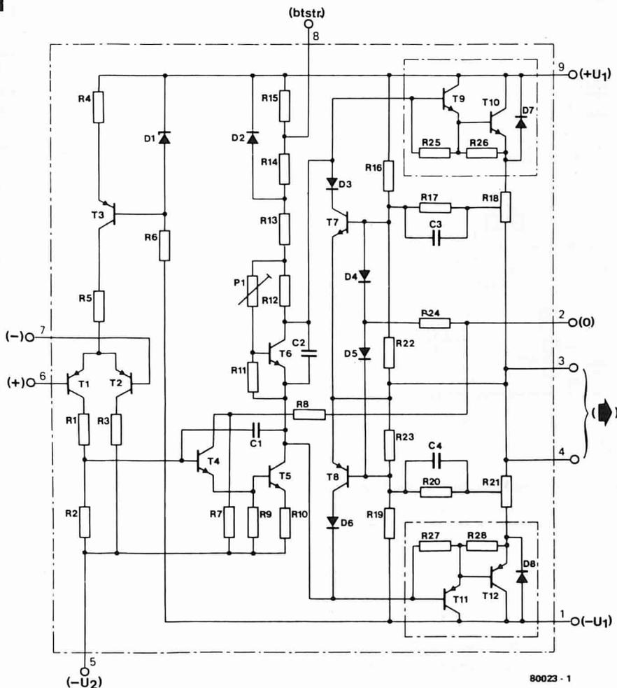
Figura 1. Circuito interno dei moduli amplificatori di potenza OM931 e OM961.
