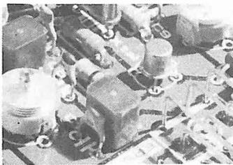
Questo semplice convertitore per onde corte, controllato a cristallo, è previsto per essere impiegato in unione ad un ricevitore convenzionale per onde medie, ad esempio un'autoradio.
