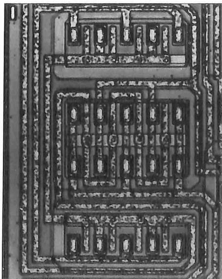
ciali tecniche per l'adattamento geometrico consentono di ottenere una tensione di offset tipica di 2mV.
