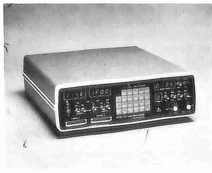
telefoniche, l'analisi della macchina da sottoporre al test direttamente dalla fabbrica, mentre una ulteriore possibilità è quella di memorizzare su EPROM sequenze di eventi da poter poi essere analizzate in separata sede. I 21 diversi modi di trigger permettono, tra l'altro, l'analisi dei dati prima o dopo del verificarsi o del non verificarsi di un evento atteso.
