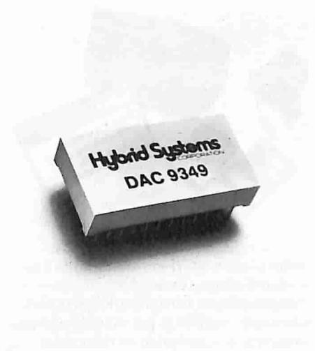
ingressi binari, offset binari o BCD. Il funzionamento può avvenire o con un riferimento interno di precisione o con una sorgente esterna a -10V. Il settling time nel peggiore dei casi è 15 $\mu$ s, e la linearità entro  $\pm 0,0125\%$  viene conservata in tutto il range di temperatura da 0 a +70°C. Il DAC 9349 richiede  $\pm 15V$  come alimentazione e ha un consumo massimo di 300 mW.
