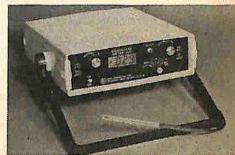
Il modello 906 lavora sia alla tensione di rete di 115V che a 230 V, con 50/60 Hz, o in alternativa, con una batteria ad elettrolita solido che è inclusa per il lavoro portatile. Un circuito di ricarica è incorporato nello strumento. Il Gaussmetro/Flussometro impiega un contenitore plastico antiurto munito di maniglia che serve anche per alzare lo strumento sul banco per una più facile leggibilità delle misure. Le misure sono  $21,6 \times 7,6 \times 24$  cm, ed il peso è 1,95 Kg.
