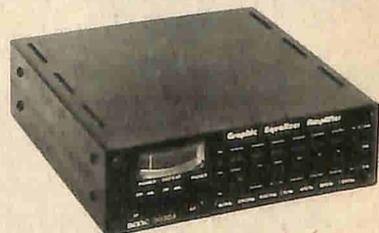
**Amplificatore equalizzatore stereo per autoradio e mangianastri Mod. 303DX**
