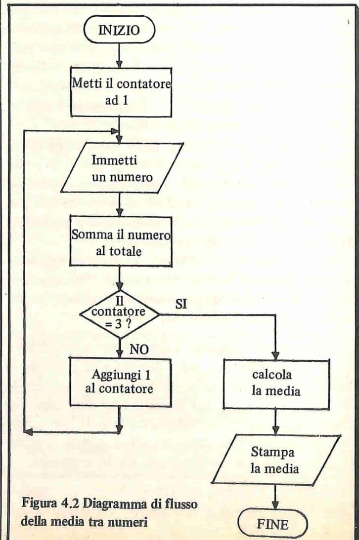
Figura 4.2 Diagramma di flusso della media tra numeri
