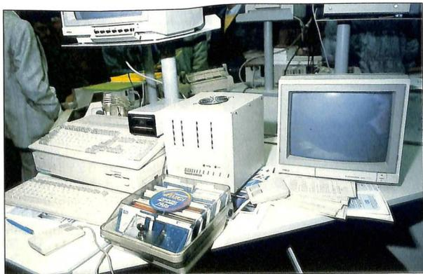
suo utente, ma che conserva la completa compatibilità con l'Amiga 1000. Il modello base possiede una capacità di memoria di 1.25 MB (1 MB di RAM e 256K di ROM) e comprende un disk drive da 3.5".
