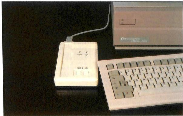
standard, non necessita di detto spinotto, n.d.r.). La peculiarità principale di questo prodotto risiede nella sua stessa architettura, basata sullo standard di comunicazione Hayes, che comprende comandi per la gestione degli automatismi sia in chiamata che in risposta. Ciò significa che, a differenza di altri prodotti presenti sul mercato, il WD 230 dispone delle funzioni di autodial (composizione automatica del numero) e di autoanswer (risposta automatica).
