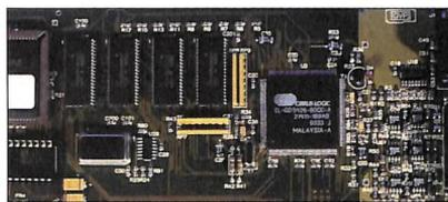
Un particolare della Picasso II (sopra) e della EGS Spectrum (sotto). Si noti il chip grafico Cirrus Logic
