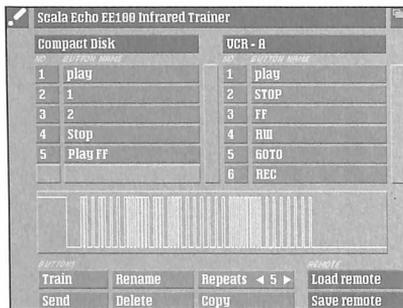
Il pannello di controllo di *Scala Echo*. Si noti la forma d'onda del segnale agli infrarossi e la possibilità di configurare molteplici comandi
