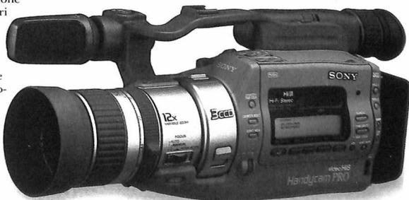
stereo è ottenibile solo se si registra contemporaneamente anche il video, in quanto il segnale audio stereo viene registrato dalla testina rotante contemporaneamente al video. Ecco perché l'AudioDubbing è possibile solo sulle tracce lineari ed è quindi in mono.
