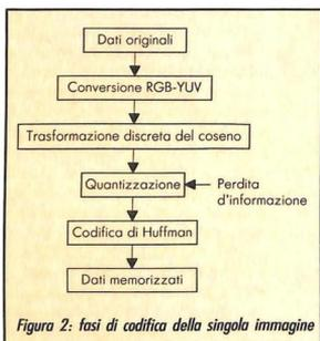
valori numerici delle sequenze di bit che saranno più corte quanto più frequente risulta il valore. Se per esempio l'insieme di dati contiene molti valori "0", questa codifica assegnerà una stringa di bit cortissima per indicare le sequenze di "0".
