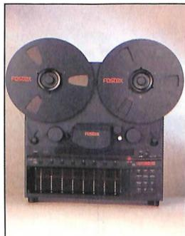
Registratore professionale multitraccia a 8 piste su bobine da 1/4". Caratteristiche tecniche: capstan a presa diretta con oscillatore al quarzo, counter in tempo con cinque cifre digitali, due pulsanti di azione A-B definita, Dolby C, interruttori elettronici senza click, remote a pedale per punch in/out, dimensioni: 430 x 445 x 235 mm (130 Kg).
