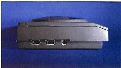
**Sopra: l'interfaccia per schede di espansione, l'interruttore e i connettori per alimentatore, TV, S-VHS, videocomposito, audio destro e sinistro. Sotto: le due porte controller e AUX**
