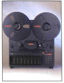
Registratore professionale multitraccia a 8 piste su bobine da 1/4". Caratteristiche tecniche: capstan a presa diretta con oscillatore al quarzo, counter in tempo reale a cinque cifre digitali, due pulsanti di memoria, due pulsanti di ricerca, repati di una sezione A-B definita, Dolby C, interruttori elettronici senza click, remote a pedale per punch in/out, dimensioni: 430 x 445 x 235 mm (130 Kg).
