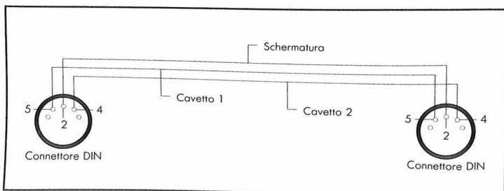
Le saldature tra i due cavetti e la schermatura e i pin dei connettori maschi DIN
