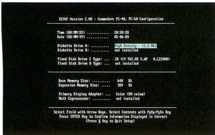
L'applicazione SETUP consente d'indicare al BIOS la configurazione di cui si dispone
