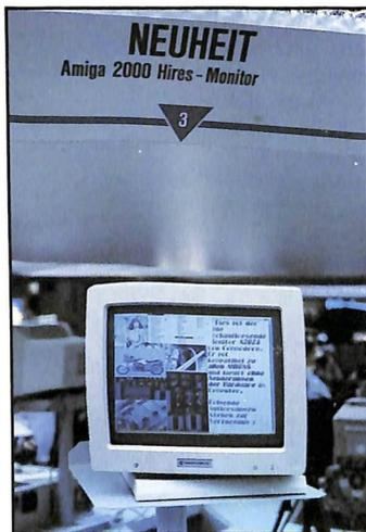
Il nuovo monitor A2024 permette una risoluzione senza flickering di 1008 x 1024
