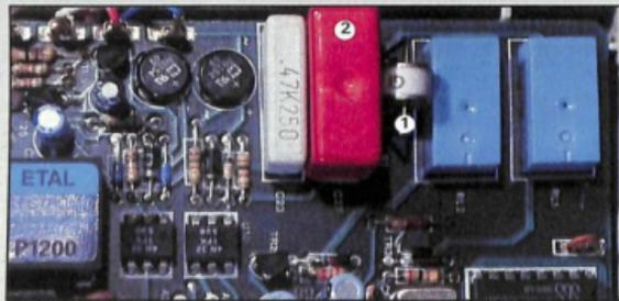
A volte le centrali telefoniche elevano la tensione che genera lo squillo dai normali 60 a valori di 200 volt. L'adattatore ha al suo interno uno scaricatore di tensione che si innescia a 150 volt, inibendo la suoneria. Dissaldando il contatto 1 e saldandolo alla base del condensatore 2, il problema viene risolto
