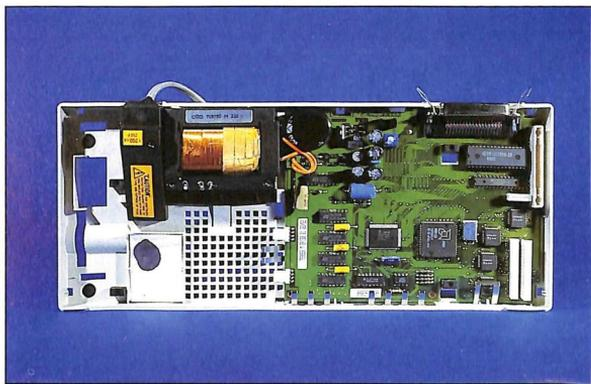
L'interno. Si noti l'alimentatore (a sinistra) e il connettore per le memory card (a destra)
