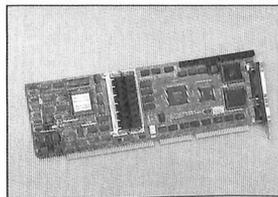
fre una CPU 80386SX a 25 MHz, una RAM da 512K espandibile sulla stessa scheda a 16 MB (4 MB dei quali possono essere configurati come espansione RAM autoconfigurante Amiga), dispo-
