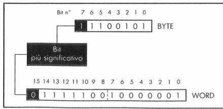
La struttura dei dati di tipo byte e quella dei dati di tipo word
