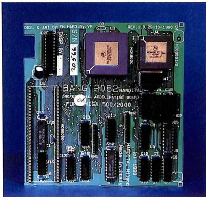
montaggio della scheda, si eccede in altezza, impedendo la corretta sistemazione della schermatura metallica e quindi della tastiera. Morale: l'Amiga non si chiude più. La soluzione definitiva, ovviamente, consiste nella sostituzione del condensatore incriminato con uno di dimensioni più contenute (basta che le caratteristiche elettriche siano le medesime), con lo svantaggio, però, che gli interventi sulla piastra madre sono sempre antipatici e, tutto sommato, pericolosi.
