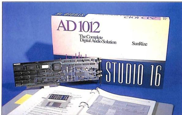
la qualità. Il periodo necessario a riprodurre la gamma di suoni udibili dalla maggior parte degli esseri umani è di 1/44.100 di secondo, che equivale a una frequenza di 44.100 Hz ed è quella dei compact disc. Anche se la gamma dell'udibile arriva a 22.000 Hz c'è un teorema (quello di Nyquist) che postula che la
