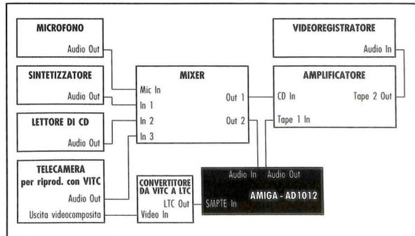
In questo collegamento tipo la telecamera dispone del codice di sincronizzazione VITC (come molte Philips) convertito poi da un apposito apparecchio (opzionale) in SMPTE LTC
