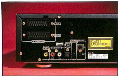
Sopra: il pannello frontale del CLD-1600. Sotto: le porte di collegamento presenti sul retro. Si noti la presa Control In
