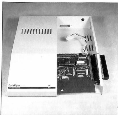
Sopra: l'interno dell'A500-HD+ della GVP. Sotto: DataFlyer 500 con l'adattatore SCSI installato in uno slot
