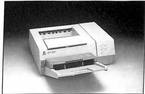
nuovo sistema di sviluppo "mono componente". Gli elementi di questo sistema infatti (tamburo fotococonduttore, toner, corona, pulitore, raccogliore del toner usato) sono inseriti in un'unica cartuccia di riproduzione che può essere sostituita in pochi secondi, rendendo la SP 101 praticamente libera da qualsiasi forma di manutenzione.
