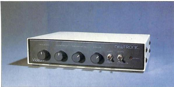
commutatore multiplo. Infine, vediamo come il collegamento contemporaneo al Videon dell'uscita video dell'Amiga e della sorgente esterna consenta, tramite un apposito switch, di vedere in qualsiasi momento sul proprio monitor l'immagine necessaria senza dover ricorrere, come accadeva con altri digitalizzatori, a scomode operazioni relative allo scambio di cavi.
