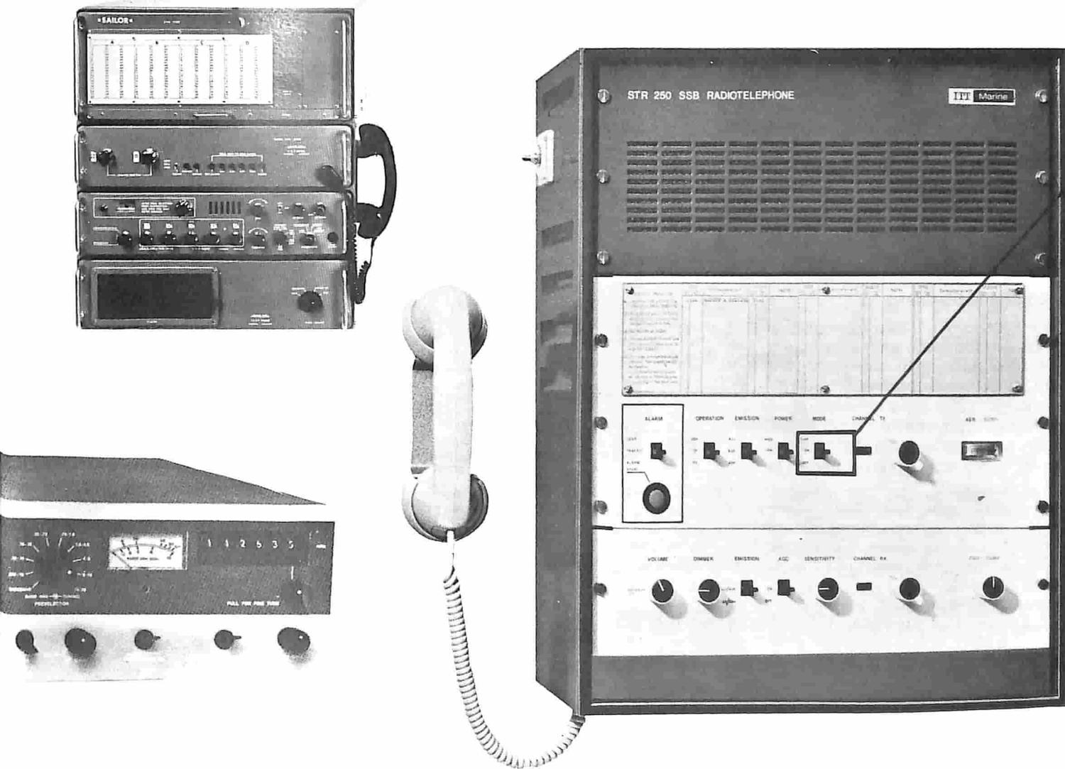
ritmi. L'apparecchiatura possiede un elevato grado di stabilità e di affidabilità anche grazie al fatto di essere completamente transistorizzata. L'accordo d'antenna è completamente automatico, per cui l'apparecchio irradia sempre a piena potenza. In pochi secondi dal momento dell'accensione l'apparato è perfettamente in grado di stabilire il contatto radio.
