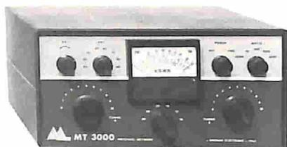
**Campo di frequenza:** 3,5-4 MHz a 80 m, 7,0-7,5 MHz a 40 m, 14,0-14,5 MHz a 20 m, 21,0-21,5 a 15 m, 26,5-28,8 MHz a 11 m, 28,0-29,7 MHz a 10 m; **Impedenza d'ingresso:** 50 ohm resistivi; **Impedenza d'uscita:** 50 ohm con VSWR max 5:1; **Potenza nominale:** 4000 W PeP, 2000 W DC (10-20 m), 2000 W PeP, 1000 W DC (40-80 m); **Precisione del vatmetro:**  $\pm 5\%$ ; **Perdite di inserzione:** 0,5 dB o meno, dopo l'adattamento a VSWR 1:1; **Dimensioni:** 320x360x180 mm; **Peso:** kg 12.
