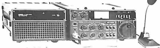
**Gamma di frequenza:** 1,8-2 MHz; 3,5-4 MHz; 7-7,5 MHz; (7,8-7,5 MHz solo in ricezione); 14-15,2 MHz; (14,35-15,2 MHz solo in ricezione); 21-21,5 MHz; 28-30 MHz.
