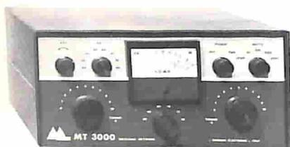
**Campo di frequenza:** 3,5-4 MHz a 80 m, 7,0-7,5 MHz a 40 m, 14,0-14,5 MHz a 20 m, 21,0-21,5 a 15 m, 26,5-28,8 MHz a 11 m, 28,0-29,7 MHz a 10 m; **Impedenza d'ingresso:** 50 ohm resistivi; **Impedenza d'uscita:** 50 ohm con VSWR max 5:1; **Potenza nominale:** 4000 W PeP, 2000 W DC (10-20 m), 2000 W PeP, 1000 W DC (40-80 m); **Precisione del vatmetro:**  $\pm 5\%$ ; **Perdite di inserzione:** 0,5 dB o meno, dopo l'adattamento a VSWR 1:1; **Dimensioni:** 320x360x180 mm; **Peso:** kg 12.
