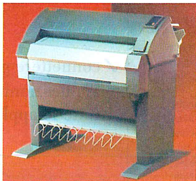
Il plotter Océ 9400 è un sofisticato elettrofotografico, che usa una testina Led al posto del sistema laser/specchio rotante.
