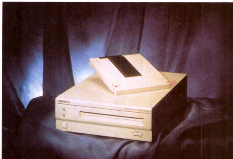
Un tipico drive magneto ottico esterno da 5 pollici (si tratta del Sony Rmo-S594); i dischi da 5 pollici sono in commercio in versioni da 1,3 e 2,6 Gbyte, e sono in arrivo i modelli da 5,2 Gbyte. I magneto ottici da 3,5 pollici hanno invece recentemente raggiunto una capacità di 640 Mbyte.
