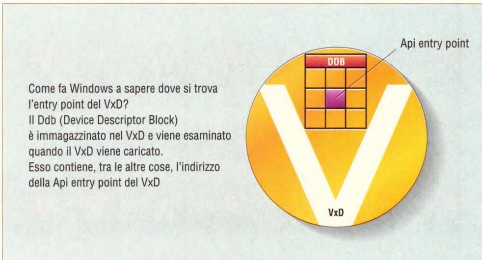
Come fa Windows a sapere dove si trova l'entry point del VxD? Il Ddb (Device Descriptor Block) è immagazzinato nel VxD e viene esaminato quando il VxD viene caricato. Esso contiene, tra le altre cose, l'indirizzo della Api entry point del VxD
