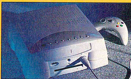
Cosa si compra con 500 dollari? L'Nc di Bandai offre processore PowerPc 603 a 66 MHz, drive per Cd-Rom a quadrupla velocità, due connettori seriali.
