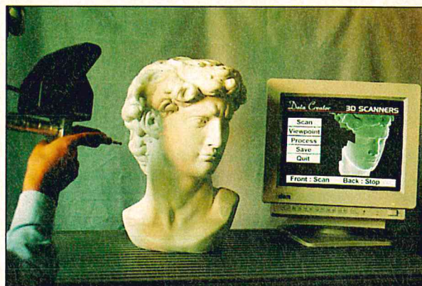
◆ Data Creator è uno scanner 3D che combina la tecnologia laser a un digitizer a sei assi per catturare i punti di oggetti complessi in modo accurato e veloce. Costruito dalla 3D Scanners Ltd di Londra, era presentato allo stand di Faro Technologies.
