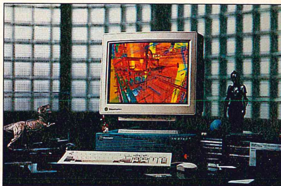
◆ La famiglia di prodotti Indigo 2, di Silicon Graphics, include il potentissimo desktop Maximum Impact, che alle note potenzialità di grafica 3D e trattamento delle immagini offre la Channel Option. Questa consente la conversione delle immagini digitali in segnali analogici per monitor addizionali, dispositivi di proiezione o caschi virtuali, per applicazioni di simulazione, info-entertainment e realtà virtuale.
