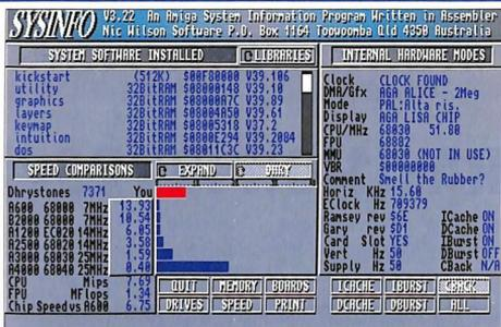
*Il test di SysInfo sbaglia nel determinare il clock della CPU. Si noti la presenza della MMU (quella del 68030).*
