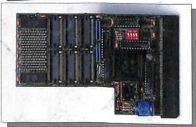
Scheda di espansione per A1200 con 1 Mb già montato e la possibilità di arrivare a 8Mb con normali Ram SOJ/ZIP. E' in grado di velocizzare le varie operazioni dell'Amiga, zoccolo per coprocessore matematico, clock e batteria tampone montati di serie.
